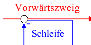
Bild 5.10: Zur Ermittlung der Übertragungsfunktion rückgekoppelter Systeme
