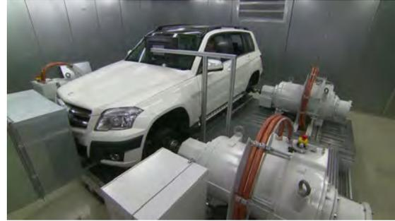
Abbildung 1: Rollenprüfstand (links) und Antriebsstrangprüfstand (rechts), bei dem die Belastungsmaschinen direkt mit den Seitenwellen verbunden sind
