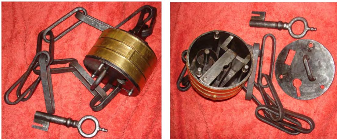
**Bild 5:** Die eiserne Rekonstruktion des Mechanismus
