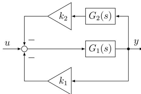
Hierbei sind  $k_1$  und  $k_2$  reelle Parameter. Ermitteln Sie die Übertragungsfunktion  $G(s)$  des Gesamtsystems mit der Eingangsgröße  $u$  und der Ausgangsgröße  $y$ . Geben Sie  $G(s)$  in einer Form ohne Doppel- bzw. Mehrfachbrüche an.
