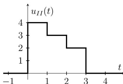
Wie muss die Ausgangsgröße  $y_{II}(t)$  des Systems im zweiten Experiment für den Fall aussehen, dass es sich um ein *lineares, zeitinvariantes* System handelt.
