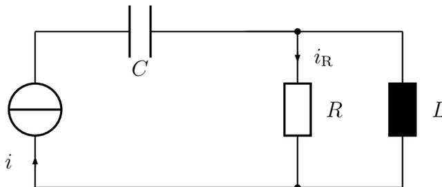
Fassen Sie den Aufbau als ein System mit der Eingangsgröße  $u = i$  und der Ausgangsgröße  $y = i_R$  auf.
