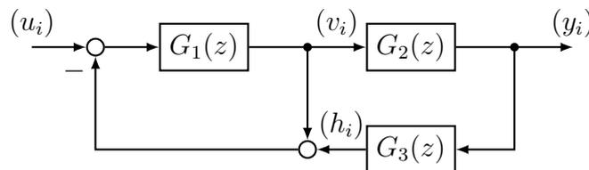
a) Ermitteln Sie die Übertragungsfunktion  $T(z) = \left. \frac{y(z)}{u(z)} \right|_{\text{AW}=0}$  in Abhängigkeit der drei Übertragungsfunktionen  $G_1(z)$ ,  $G_2(z)$  und  $G_3(z)$ .
