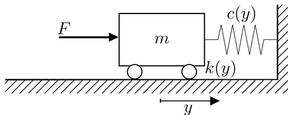
Die Position  $y$  des Wagens wird ausgehend vom entspannten Zustand der Feder gemessen. Die Federkraft ist proportional zur Auslenkung  $y$ , wobei der Proportionalitätsfaktor  $c$  (die „Federkonstante“) gemäß
