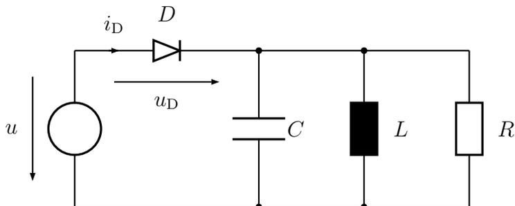
Zwischen Strom  $i_D$  und Spannung  $u_D$  an der Diode besteht der *nichtlineare* Zusammenhang
