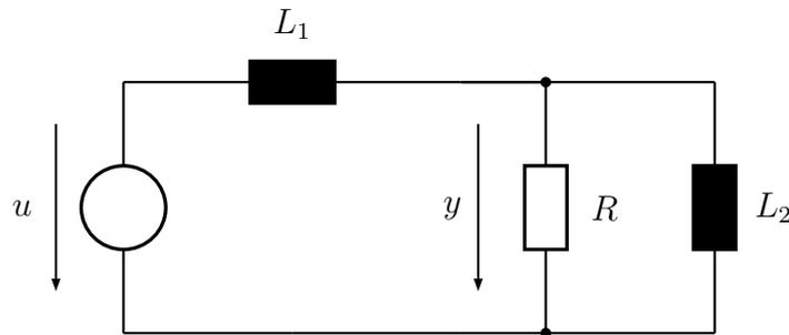
Die Quellenspannung der Spannungsquelle wird mit  $u$ , die Spannung am Widerstand  $R$  wird mit  $y$  bezeichnet. Fassen Sie den Aufbau als ein System mit der Eingangsgröße  $u$  und der Ausgangsgröße  $y$  auf.
