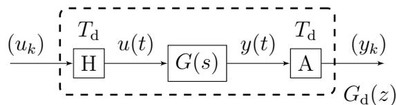
Ermitteln Sie die z-Übertragungsfunktion  $G_d(z)$  des resultierenden *zeitdiskreten* Systems.
