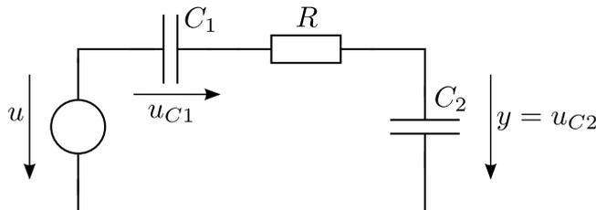
Fassen Sie den Aufbau als ein System mit der Eingangsgröße  $u$  und der Ausgangsgröße  $y$  auf.
