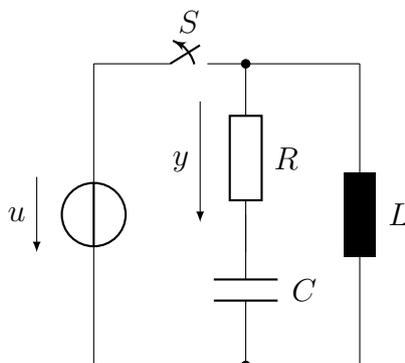
Fassen Sie das Netzwerk als ein System mit der Eingangsgröße  $u$  und der Ausgangsgröße  $y$  auf. Der Schalter  $S$  sei zunächst *geschlossen*.
