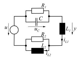
Fassen Sie das Netzwerk als ein System mit der Eingangsgröße u und der Ausgangsgröße y auf.
