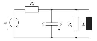
Führen Sie einen geeigneten Zustandsvektor x ein und ermitteln Sie ein Modell der Form
