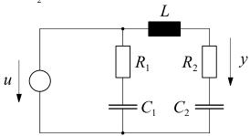
Fassen Sie das Netzwerk als ein System mit der Eingangsgröße *u* und der Ausgangsgröße *y* auf.
