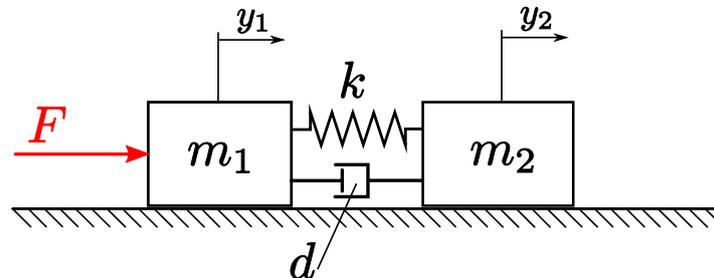
Die Positionen  $y_1$  und  $y_2$  der beiden Massen werden ausgehend vom entspannten Zustand der Feder gemessen.
