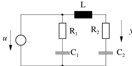
Fassen Sie das Netzwerk als ein System mit der Eingangsgröße  $u$  und der Ausgangsgröße  $y$  auf.
