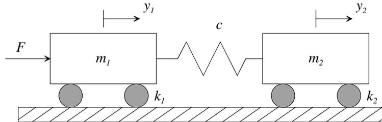
Die Positionen  $y_1$  und  $y_2$  der Massen werden ausgehend vom entspannten Zustand der Feder gemessen. Auf die Masse  $m_1$  wirken eine äußere Kraft  $F$  und eine geschwindigkeitsproportionale Reibkraft (Reibkonstante  $k_1$ ). Auf die Masse  $m_2$  wirkt ebenfalls eine geschwindigkeitsproportionale Reibkraft (Reibkonstante  $k_2$ ). Fassen Sie den mechanischen Aufbau als ein System mit der Eingangsgröße  $F$  und der Ausgangsgröße  $y = y_2$  auf.
