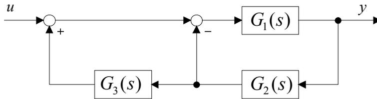
Ermitteln Sie die Übertragungsfunktion  $T(s) = \frac{y(s)}{u(s)} \Big|_{\mathbf{x}_0=0}$  als Funktion der Übertragungsfunktionen  $G_1(s)$ ,  $G_2(s)$  und  $G_3(s)$ .
