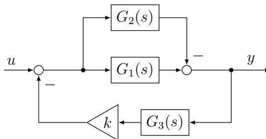
Hierbei ist  $k$  ein reeller Parameter. Ermitteln Sie die Übertragungsfunktion  $G(s)$  des Gesamtsystems mit der Eingangsgröße  $u$  und der Ausgangsgröße  $y$ . Geben Sie  $G(s)$  in einer Form ohne Doppel- bzw. Mehrfachbrüche an.
