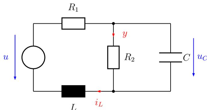
Fassen Sie das Netzwerk als ein System mit der Eingangsgröße  $u$  und der Ausgangsgröße  $y$  auf. Führen Sie einen geeigneten Zustandsvektor  $\mathbf{x}$  ein und ermitteln Sie ein lineares zeitinvariantes mathematisches Modell der Form
