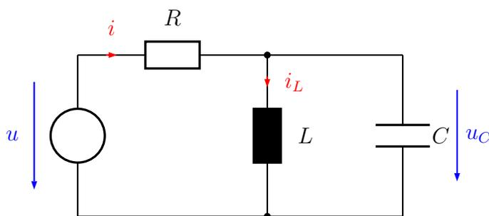
Fassen Sie das Netzwerk als ein System mit der Eingangsgröße  $u$  und der Ausgangsgröße  $y = i_L$  auf.
