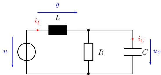
Fassen Sie das Netzwerk als ein System mit der Eingangsgröße  $u$  und der Ausgangsgröße  $y$  auf.
