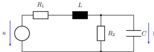
Fassen Sie das Netzwerk als ein System mit der Eingangsgröße  $u$  und der Ausgangsgröße  $y$  auf. Führen Sie einen geeigneten Zustandsvektor  $\mathbf{x}$  ein und ermitteln Sie ein lineares zeitinvariantes mathematisches Modell der Form
