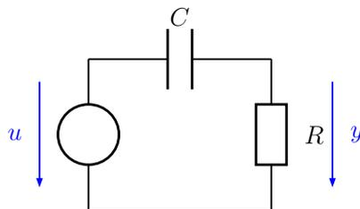
Mit  $u$  wird die von der idealen Spannungsquelle gelieferte Spannung bezeichnet,  $y$  ist der Spannungsabfall am Widerstand  $R$ . Betrachten Sie das Netzwerk als System mit der Eingangsgröße  $u$  und der Ausgangsgröße  $y$ .
