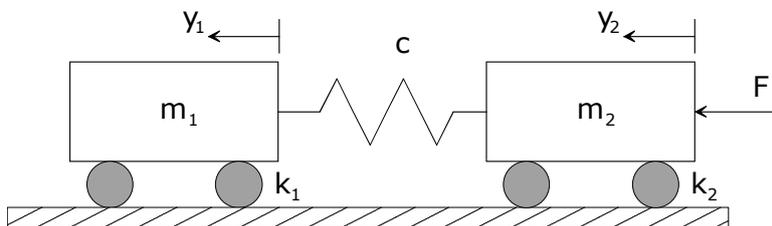
Die Feder befindet sich für  $y_2 - y_1 = 0$  im entspannten Zustand. Neben der Federkraft wirkt auf beide Massen jeweils eine geschwindigkeitsproportionale Reibkraft mit den Proportionalitätsfaktoren  $k_1 > 0$  bzw.  $k_2 > 0$ . Auf die Masse  $m_2$  wirkt außerdem eine äußere Kraft  $F$ .
