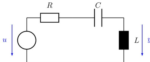
Fassen Sie das Netzwerk als ein System mit der Eingangsgröße  $u$  und der Ausgangsgröße  $y$  auf.
