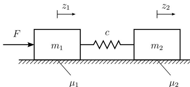
Die Positionen  $z_1$  und  $z_2$  der Massen werden ausgehend vom entspannten Zustand der Feder gemessen. Neben der Federkraft wirkt auf beide Massen jeweils eine geschwindigkeitsproportionale Reibkraft mit den Proportionalitätsfaktoren  $\mu_1$  bzw.  $\mu_2$ . Auf die Masse  $m_1$  wirkt außerdem eine äußere Kraft  $F$ .
