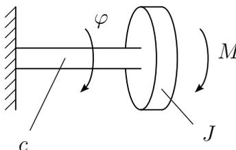
Der dünne Stab wirkt als lineare Torsionsfeder mit der Federsteifigkeit  $c$ . Weiters wirkt auf die Masse das Moment  $M$ . Fassen Sie den Aufbau als ein System mit der Eingangsgröße  $u = M$  und Ausgangsgröße  $y = \ddot{\varphi}$  auf, wobei  $\varphi$  den Torsionswinkel beschreibt.
