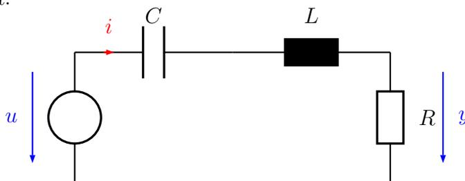
Fassen Sie das Netzwerk als ein System mit der Eingangsgröße  $u$  und der Ausgangsgröße  $y$  auf. Führen Sie einen geeigneten Zustandsvektor  $\mathbf{x}$  ein und ermitteln Sie ein lineares zeitinvariantes mathematisches Modell der Form
