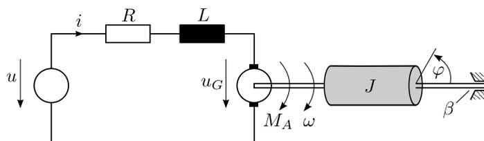
wobei  $J$  dem Trägheitsmoment des Motors entspricht. Weiters wirkt auf den Motor ein drehzahlproportionales Reibmoment  $M_R = \beta\omega$ . Das erzeugte Drehmoment ist proportional zum Strom im elektrischen Netzwerk, d.h.  $M_A = k_T i$ , die vom Motor induzierte Spannung ist proportional zur Drehzahl, d.h.  $u_G = k_m \omega$ . Die Parameter  $\beta$ ,  $k_T$  und  $k_m$  sind positive Konstanten.
