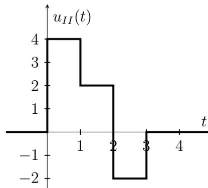
Wie muss die Ausgangsgröße  $y_{II}(t)$  des Systems im zweiten Experiment für den Fall aussehen, dass es sich um ein *lineares, zeitinvariantes* System handelt.
