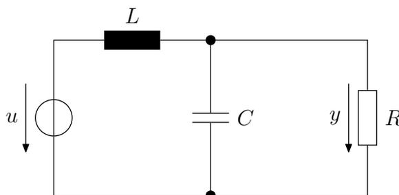
Fassen Sie das Netzwerk als ein System mit der Eingangsgröße  $u$  und der Ausgangsgröße  $y$  auf. Führen Sie einen geeigneten Zustandsvektor  $\mathbf{x}$  ein und ermitteln Sie ein lineares zeitinvariantes mathematisches Modell der Form
