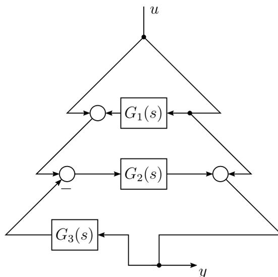
a) Ermitteln Sie die Übertragungsfunktion  $G(s) := \left. \frac{\bar{y}(s)}{\bar{u}(s)} \right|_{\text{AW}=0}$  allgemein in Abhängigkeit der Übertragungsfunktionen  $G_1(s)$ ,  $G_2(s)$  und  $G_3(s)$ .
