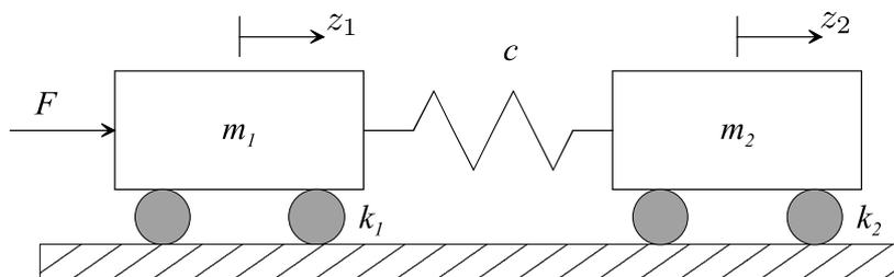
wobei die beiden Massen durch eine Feder mit der linearen Federkennlinie  $F_c = c(z_1 - z_2)$  gekoppelt sind. Auf beide Massen wirken geschwindigkeitsproportionale Reibkräfte  $F_{R,i} = k_i \dot{z}_i$ ,  $i = 1, 2$ . Auf die Masse  $m_1$  wirkt zusätzlich die Kraft  $F$ . Fassen Sie den Aufbau als ein System mit der Eingangsgröße  $u := F$  und der Ausgangsgröße  $y := z_2$  auf. Ermitteln Sie ein lineares zeitinvariantes mathematisches Modell der Form
