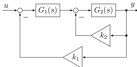
Hierbei sind  $k_1$  und  $k_2$  reelle Parameter. Ermitteln Sie die Übertragungsfunktion  $G(s)$  des Gesamtsystems mit der Eingangsgröße  $u$  und der Ausgangsgröße  $y$ . Lösen Sie eventuelle Mehrfachbrüche auf.
