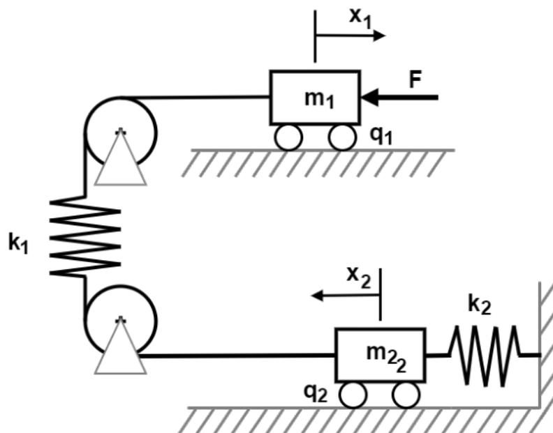
wobei die erste Masse  $m_1$  durch ein Seil über eine Feder, mit der Federkennlinie  $F_{k_1} = k_1(x_1 - x_2)$  und zwei Umlenkrollen mit der zweiten Masse  $m_2$  verbunden ist. Die
