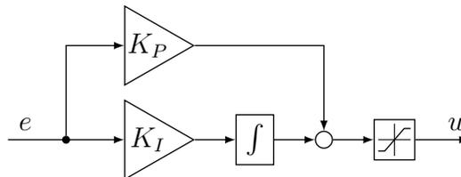
Erweitern Sie das Strukturbild um eine Anti-Windup Maßnahme. Warum ist diese Maßnahme notwendig? (*Erklären Sie den auftretenden Effekt im Detail!*)
