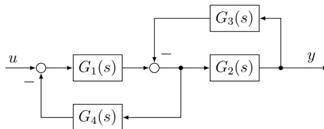
Berechnen Sie die Übertragungsfunktion  $G(s) = \frac{\bar{y}(s)}{\bar{u}(s)}$  des Gesamtsystems.
