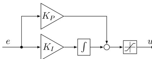
Erweitern Sie das Strukturbild um eine Anti-Windup-Maßnahme. Warum ist diese Maßnahme notwendig?
