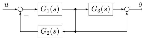
a) Ermitteln Sie die Übertragungsfunktion  $G(s) := \left. \frac{\bar{y}(s)}{\bar{u}(s)} \right|_{AW=0}$  allgemein in Abhängigkeit der Übertragungsfunktionen  $G_1(s)$ ,  $G_2(s)$  und  $G_3(s)$ .
