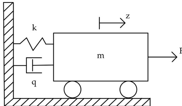
wobei die Masse  $m$  durch eine Feder mit der linearen Federkennlinie  $F_k = kz$  und einem geschwindigkeitsproportionalen Dämpfer  $F_q = q\dot{z}$  an eine starre Wand gekoppelt ist. Auf die Masse  $m$  wirkt zusätzlich die Kraft  $F$ .
