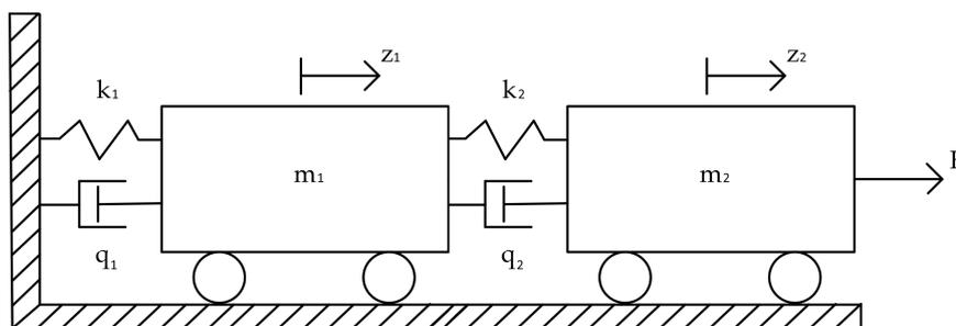
wobei die erste Masse  $m_1$  durch eine Feder mit der linearen Federkennlinie  $F_{k1} = k_1 z_1$  und einem geschwindigkeitsproportionalen Dämpfer  $F_{q1} = q_1 \dot{z}_1$  an eine starre Wand gekoppelt ist. Die zweite Masse  $m_2$  ist mit der ersten Masse  $m_1$  durch eine Feder mit einer linearen Federkennlinie  $F_{k2} = k_2(z_1 - z_2)$  und einem geschwindigkeitsproportionalen Dämpfer  $F_{q2} = q_2(\dot{z}_1 - \dot{z}_2)$  gekoppelt. Auf die zweite Masse  $m_2$
