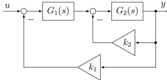
Hierbei sind  $k_1$  und  $k_2$  reelle Parameter. Ermitteln Sie die Übertragungsfunktion  $G(s)$  des Gesamtsystems mit der Eingangsgröße  $u$  und der Ausgangsgröße  $y$ .
