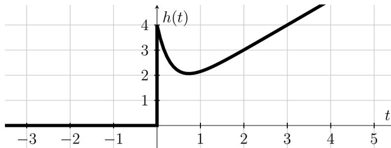
Es ist bekannt, dass die Realisierungszeitkonstante den Wert  $T_R = \frac{1}{3}$  hat. Lesen Sie den Proportionalbeiwert  $K_P$ , die Nachstellzeit  $T_N$  und die Vorhaltezeit  $T_V$  des PID-Reglers aus dem Diagramm ab und geben Sie die Übertragungsfunktion  $R(s)$  des Reglers an.
