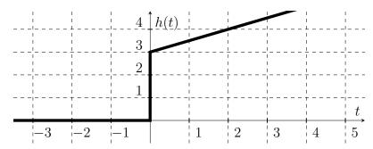
Lesen Sie den Proportionalbeiwert  $K_P$  und die Nachstellzeit  $T_N$  des PI-Reglers aus dem Diagramm ab und geben Sie die Übertragungsfunktion R(s) des Reglers an.
