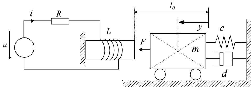
Die horizontale Auslenkung der Masse wird mit  $y$  bezeichnet, wobei angenommen wird, dass sie von der Gleichgewichtslage für  $F = 0$  aus gemessen wird, d.h. für  $y = 0$  ist die Feder entspannt und der Abstand zwischen dem Eisenkern und dem Wagen ist dabei  $l_0$ . Für die Kraftwirkung gilt die Beziehung
