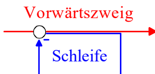
Bild 3.9: Zur Ermittlung der Übertragungsfunktion rückgekoppelter Systeme
