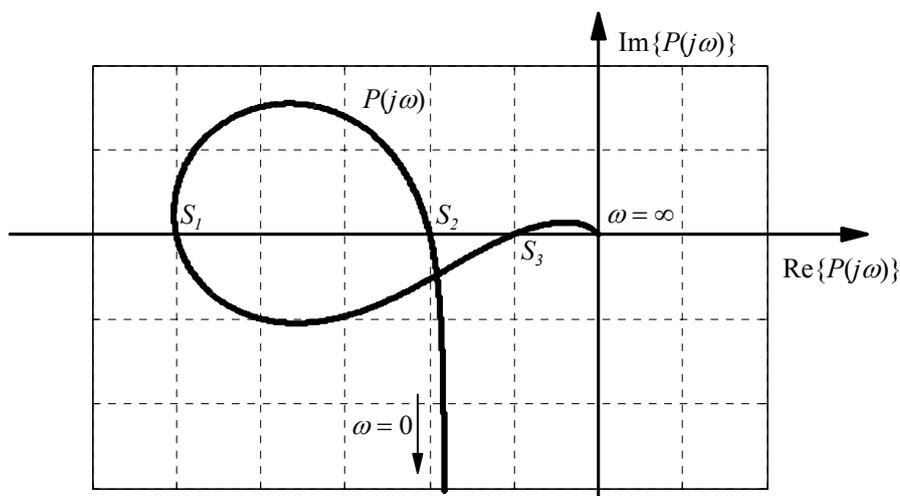
Für drei Werte des Reglerparameters  $K$  zeigt die Sprungantwort eine Dauerschwingung, deren Periodendauer  $T$  ermittelt wurde: für  $K = 2$  beträgt die Periodendauer  $T = 2\pi$ , für  $K = 5$  beträgt sie  $T = 4\pi$  und für  $K = 10$  beträgt sie  $T = \pi$ .
