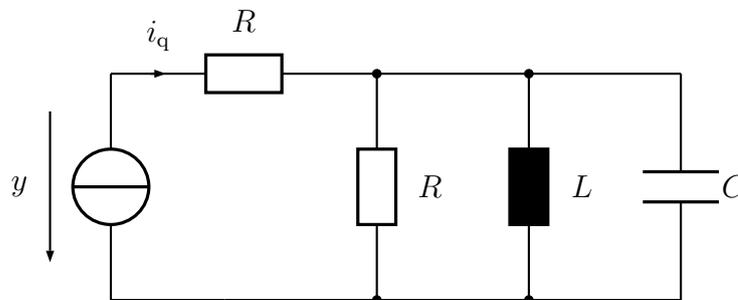
Fassen Sie das Netzwerk als ein System mit der Eingangsgröße  $i_q =: u$  und der Ausgangsgröße  $y$  auf. Führen Sie einen geeigneten Zustandsvektor  $\mathbf{x}$  ein und ermitteln Sie ein lineares zeitinvariantes mathematisches Modell der Form
