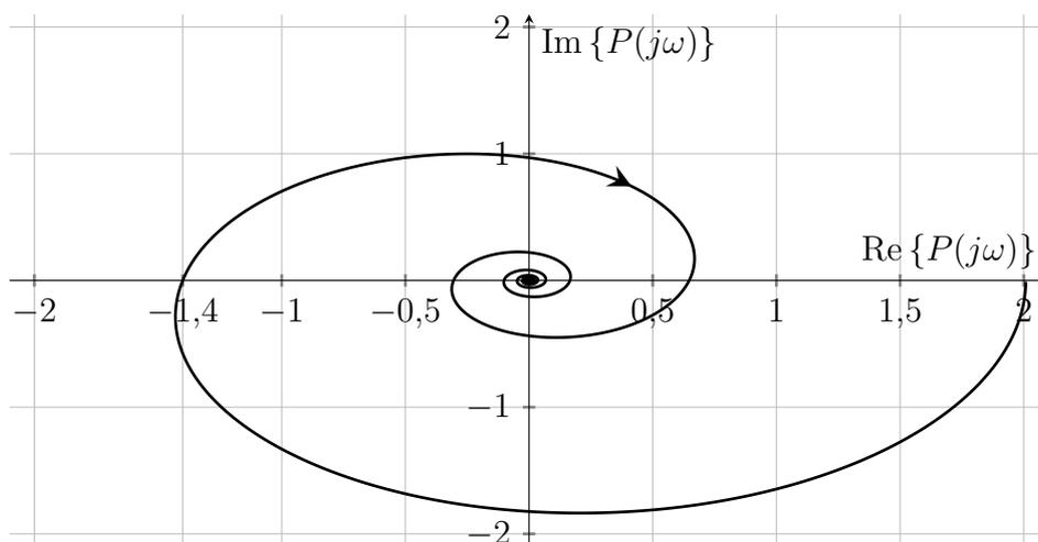
Zur Regelung soll ein P-Regler mit dem Proportionalfaktor  $K$  in einem Standardregelkreis eingesetzt werden. Ermitteln Sie nachvollziehbar den größtmöglichen Wertebereich des *reellen* Reglerparameters  $K$ , sodass der geschlossene Kreis die BIBO-Eigenschaft besitzt.
