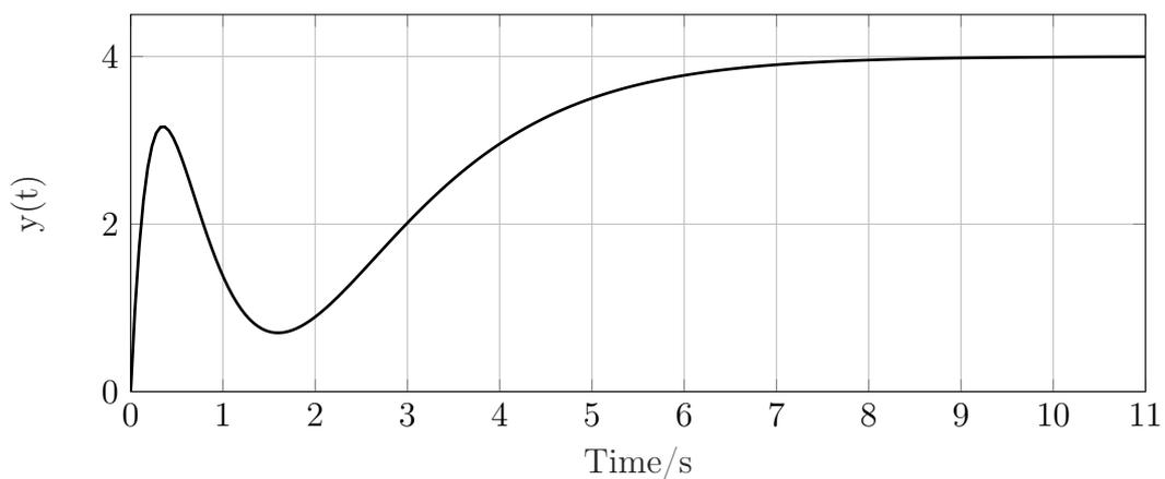
Zur Regelung soll ein P-Regler mit dem Proportionalfaktor  $K$  in einem Standardregelkreis eingesetzt werden. Ermitteln Sie nachvollziehbar den größtmöglichen Wertebereich des *reellen* Reglerparameters  $K$  so, dass der geschlossene Kreis die BIBO-Eigenschaft besitzt.
