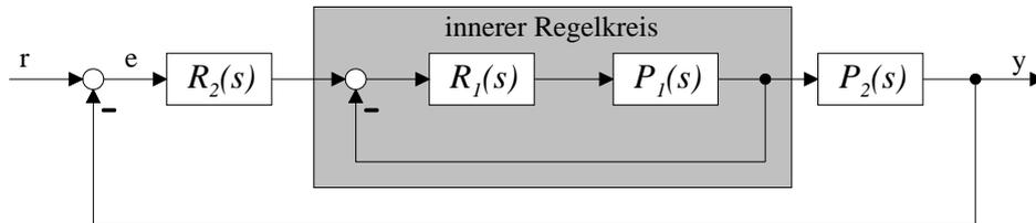
Die Regelstrecke wird durch die beiden Übertragungsfunktionen  $P_1(s) = \frac{0.1}{s}$  und  $P_2(s) = \frac{100}{s+1}$  beschrieben.
