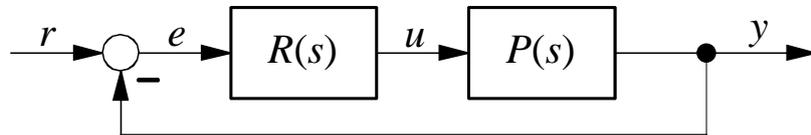
Die Regelstrecke wird durch die Übertragungsfunktion  $P(s)$  beschrieben,  $R(s)$  ist die Reglerübertragungsfunktion. Von der Regelstrecke ist bekannt, dass sie 3. Ordnung ist und *keine* Polstellen mit positivem Realteil besitzt. Der Verlauf der Ortskurve  $P(j\omega)$  ist in folgender Abbildung dargestellt:
