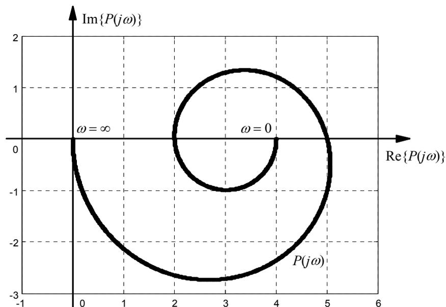
Als Regler wird ein Proportionalregler  $R(s) = K$  eingesetzt ( $K$  ist ein reeller Parameter).
