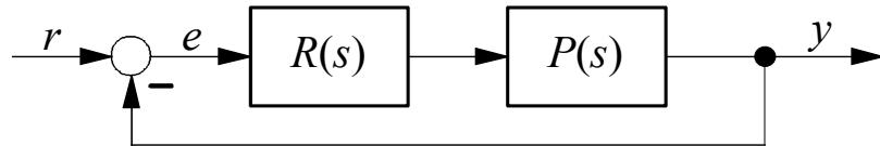
Die Übertragungsfunktion der Strecke lautet:  $P(s) = \frac{s^2 + 5s + 4}{s^3}$
