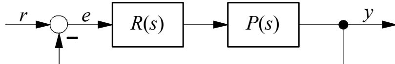
Für die Übertragungsfunktion der Strecke gilt:  $P(s) = \frac{100(s+0.1)}{s(s+1)(s+100)}$
