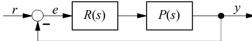
Von der Übertragungsfunktion der Strecke  $P(s)$  ist bekannt, dass genau 2 ihrer 5 Pole einen negativen Realteil aufweisen. Zusätzlich liegt der Frequenzgang  $P(j\omega)$  der Strecke für  $0 \leq \omega < \infty$  graphisch vor:
