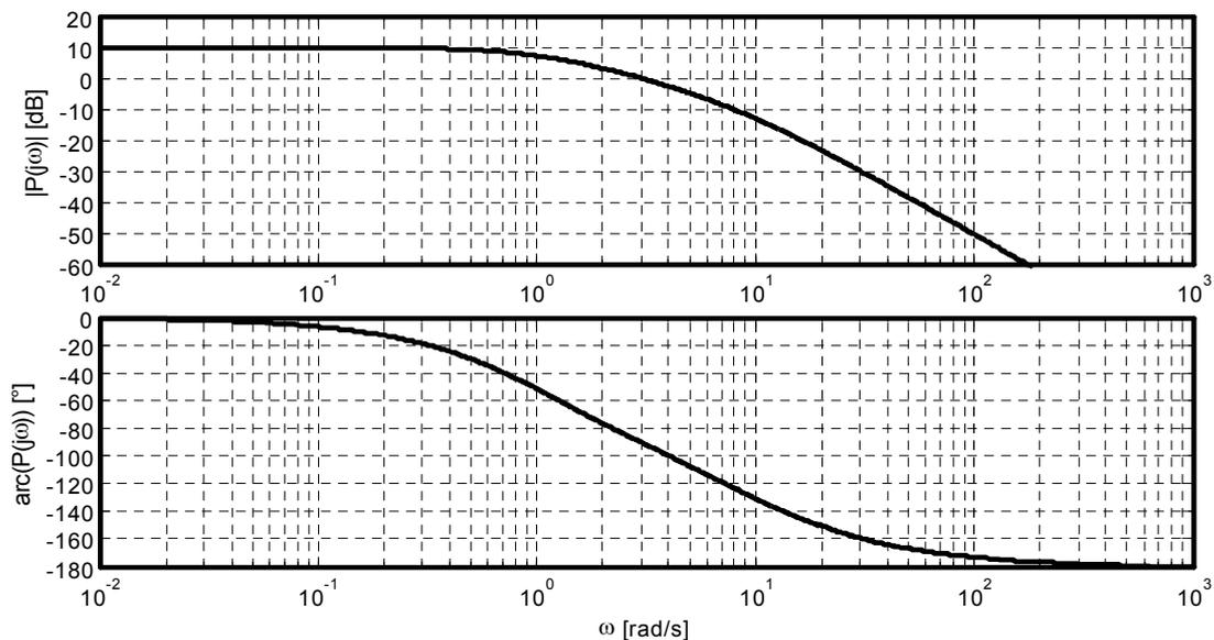
a) Zunächst wird der Proportionalregler  $R(s)=1$  eingesetzt. Ermitteln Sie für die Führungsgröße  $r(t) = 2 \sin(3t)$  die Ausgangsgröße  $y(t)$  im *eingeschwungenen Zustand*.
