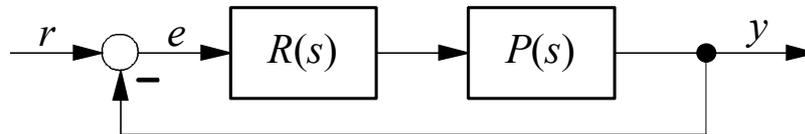
Von der Regelstrecke mit der Übertragungsfunktion  $P(s)$  ist bekannt, dass sie 3. Ordnung ist und keine Polstellen mit positivem Realteil sowie keine Nullstellen besitzt. Der Frequenzgang  $P(j\omega)$  liegt in Form von Bode-Diagrammen graphisch vor:
