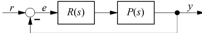
Die Regelstrecke mit der Übertragungsfunktion  $P(s)$  sei „vom einfachen Typ“, ihr Frequenzgang  $P(j\omega)$  liegt in Form von Bode-Diagrammen graphisch vor:
