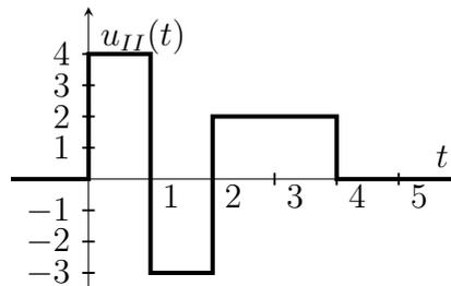
Wie muss die Ausgangsgröße  $y_{II}(t)$  des Systems im zweiten Experiment für den Fall aussehen, dass es sich um ein *lineares, zeitinvariantes* System handelt und die Anfangszustände null sind.
