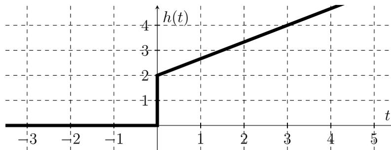
Lesen Sie den Proportionalbeiwert  $K_P$  und die Nachstellzeit  $T_N$  des PI-Reglers aus dem Diagramm ab und geben Sie die Übertragungsfunktion  $R(s)$  des Reglers an.
