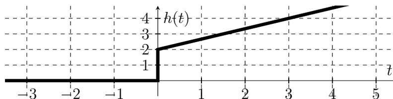
Lesen Sie den Proportionalbeiwert  $K_P$  und die Nachstellzeit  $T_N$  des PI-Reglers aus dem Diagramm ab und geben Sie die Übertragungsfunktion  $R(s)$  des Reglers an.
