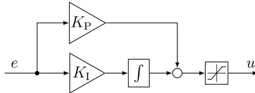
Erweitern Sie das Strukturbild um eine Anti-Windup Maßnahme. Warum ist diese Maßnahme notwendig?
