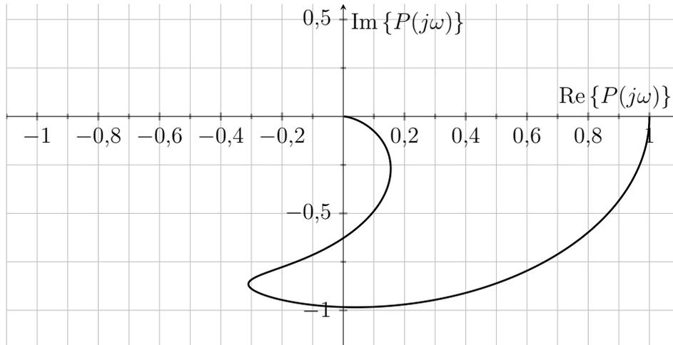
Zeigen Sie mit Hilfe des Nyquistkriteriums, dass das gegebene System durch einen Proportionalregler  $R(s) = K$  mit  $K \in \mathbb{R}$  nicht stabilisiert werden kann.
