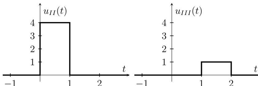
Wie muss die Ausgangsgröße  $y(t)$  des Systems im zweiten Experiment für den Fall aussehen, dass es sich um ein *lineares, zeitinvariantes* System handelt.
