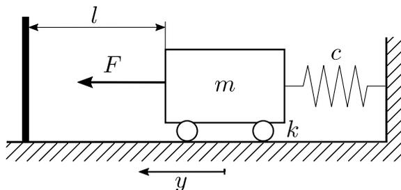
Im Abstand  $l$  von der Wagenstartposition befindet sich ein Hindernis, das zunächst unberücksichtigt bleibt. Die Position  $y$  des Wagens wird ausgehend vom entspannten Zustand der Feder gemessen. Abgesehen von der Federkraft und der von außen vorgegebenen Kraft  $F$  wirkt auf den Wagen eine geschwindigkeitsproportionale Reibkraft mit dem Proportionalitätsfaktor  $k$ . Fassen Sie den Aufbau als ein System mit der Eingangsgröße  $u = F$  und der Ausgangsgröße  $y$  auf.
