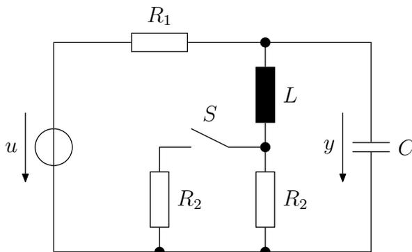
Die Quellenspannung der Spannungsquelle wird mit  $u$ , die Spannung an der Kapazität  $C$  wird mit  $y$  bezeichnet. Fassen Sie den Aufbau als ein System mit der Eingangsgröße  $u$  und der Ausgangsgröße  $y$  auf. Der Schalter  $S$  sei zunächst *geöffnet*.
