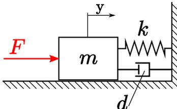
Auf die Masse wirkt die äußere Kraft  $F$ , die *wegproportionale* Federkraft und die *geschwindigkeitsproportionale* Dämpferkraft. Die Position  $y$  der Masse wird ausgehend vom entspannten Zustand der Feder gemessen. Fassen Sie den mechanischen Aufbau als ein System mit der Eingangsgröße  $u = F$  und der Ausgangsgröße  $y$  auf.
