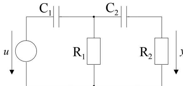
Zur Vereinfachung der folgenden Berechnungen soll für die Bauelemente  $C_1 = C_2 = C$  und  $R_1 = R_2 = R$  gelten.
