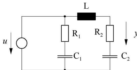
Fassen Sie das Netzwerk als ein System mit der Eingangsgröße  $u$  und der Ausgangsgröße  $y$  auf. Führen Sie einen geeigneten Zustandsvektor  $\mathbf{x}$  ein und ermitteln Sie ein mathematisches Modell der Form
