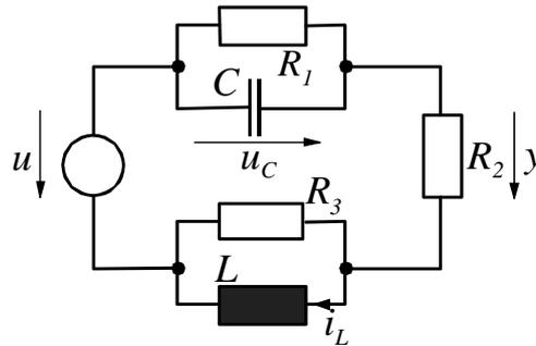
Fassen Sie das Netzwerk als ein System mit der Eingangsgröße  $u$  und der Ausgangsgröße  $y$  auf.
