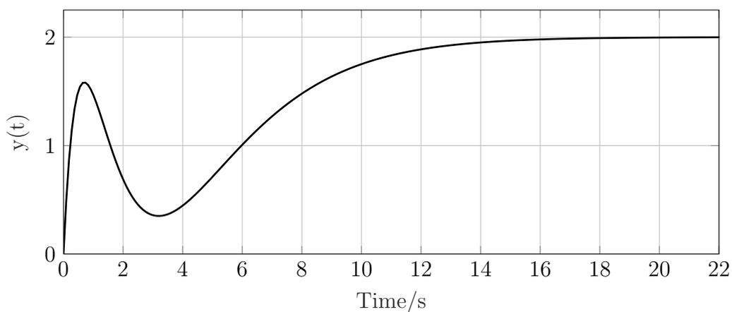
Zur Regelung soll ein P-Regler mit dem Proportionalfaktor  $K$  in einem Standardregelkreis eingesetzt werden. Ermitteln Sie nachvollziehbar den größtmöglichen Wertebereich des *reellen* Reglerparameters  $K$  so, dass der geschlossene Kreis die BIBO-Eigenschaft besitzt.
