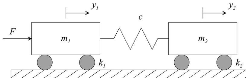
wobei die beiden Massen durch eine Feder mit der linearen Federkennlinie  $F_c = c(y_1 - y_2)$  gekoppelt sind. Auf beide Massen wirken geschwindigkeitsproportionale Reibkräfte  $F_{Ri} = \dot{y}_i k_i$  (für  $i = 1, 2$ ). Auf die Masse  $m_1$  wirkt zusätzlich die Kraft  $F$ .
