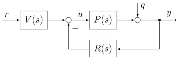
Auf den Regelkreis wirkt zusätzlich eine Störung  $q$ . Die Übertragungsfunktion der Regelstrecke lautet
