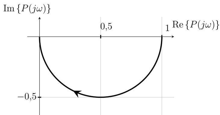
mit Radius  $\frac{1}{2}$  und Mittelpunkt bei  $\frac{1}{2}$  im vierten Quadranten der komplexen Ebene bildet.
