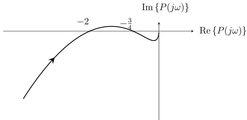
Als Regler kommt ein Proportionalregler  $R(s) = K$  zum Einsatz. Ermitteln Sie mit Hilfe des NYQUIST-Kriteriums *nachvollziehbar* (mit Fallunterscheidung und Bestimmung der stetigen Winkeländerung für jeden Fall) den größtmöglichen Wertebereich des Parameters  $K$ , für den obiger Regelkreis die BIBO-Eigenschaft besitzt.
