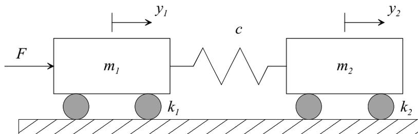
wobei die beiden Massen durch eine Feder mit der linearen Federkennlinie  $F_c = c(y_1 - y_2)$  gekoppelt sind. Auf beide Massen wirken geschwindigkeitsproportionale Reibkräfte  $F_{Ri} = \dot{y}_i k_i$ . Auf die Masse  $m_1$  wirkt zusätzlich die Kraft  $F$ .
