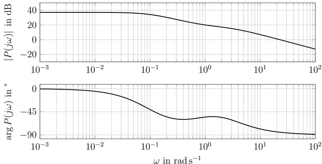
Dimensionieren Sie einen P-Regler  $R(s) = K$  so, dass die Anstiegszeit  $t_r$  der Sprungantwort des geschlossenen Kreises näherungsweise dem in Punkt a) bestimmten Wert entspricht.
