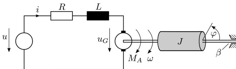
wobei  $J$  dem Trägheitsmoment des Motors entspricht. Weiters wirkt auf den Motor ein drehzahlproportionales Reibmoment  $M_R = \beta\omega$ . Das erzeugte Drehmoment ist proportional zum Strom im elektrischen Netzwerk, d.h.  $M_A = k_T i$ , die vom Motor induzierte Spannung ist proportional zur Drehzahl, d.h.  $u_G = k_m \omega$ . Die Parameter  $\beta$ ,  $k_T$  und  $k_m$  sind positive Konstanten.
