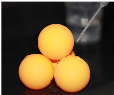
Abbildung 6 Eine Tischtennisballpyramide stabilisiert durch Wasserbrücken
