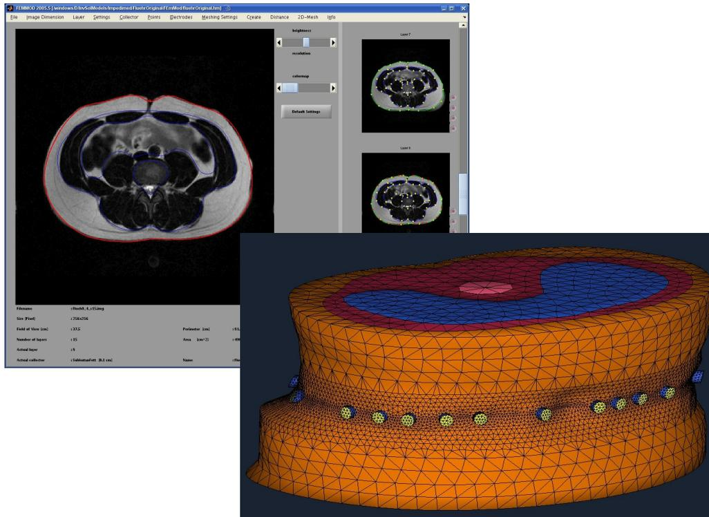
Ein bereits bestehendes Matlab®-Programm zur Generierung von Finite-Elemente-Gittern aus DICOM-Bildern soll verbessert werden. Das GUI ist vor vielen Jahren am Institut programmiert worden und soll nun insbesondere in Bezug auf Usability verbessert werden. Das derzeitige Programm ist speziell auf EIT abgestimmt, in einer neueren Version soll die Verwendbarkeit auf andere Bereiche ausgeweitet werden.
