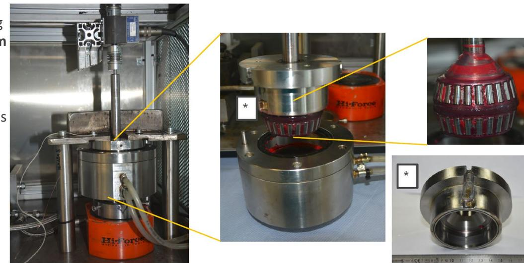
Versuchsaufbau „Scherstabilitätsprüfstand“ (DIN 51350-6 bei AC2T research GmbH)
