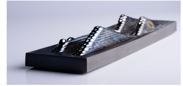
Drahtbasierte Additive Fertigung von Ti6-4 mittels EBW (F. Pixner)
