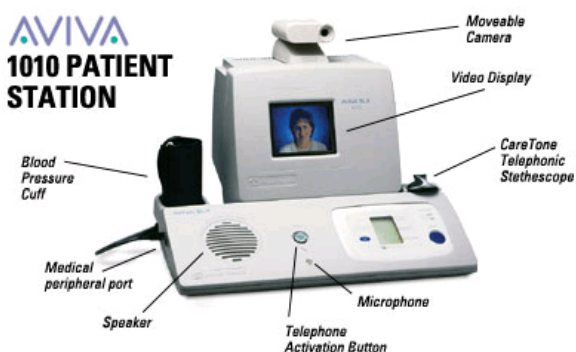
Abb. 6: Kommerziell verfügbare Patientenstation mit Mikrofon, Lautsprecher, Kamera, Monitor und verschiedenen Vorrichtungen zur Erfassung medizinisch-klinischer Daten [2]
