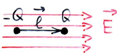
Ist der Dipol ausgerichtet, verschwinden Kraft und Drehmoment
