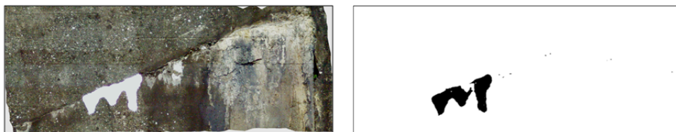
Abb. 9: Entzerrte Bildsequenz (2 mm/px) von Fotos der Koaxialkamera einer Schadstelle (links), Binärbild I_b mit segmentierten Pixeln aufgrund distinktiver Grauwertdifferenzen (rechts)
