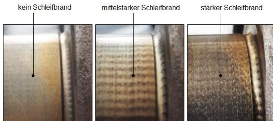
Visualisierung von thermischer Randzonenschädigung durch Schleifbrand am Werkstück (3% Nitral)
