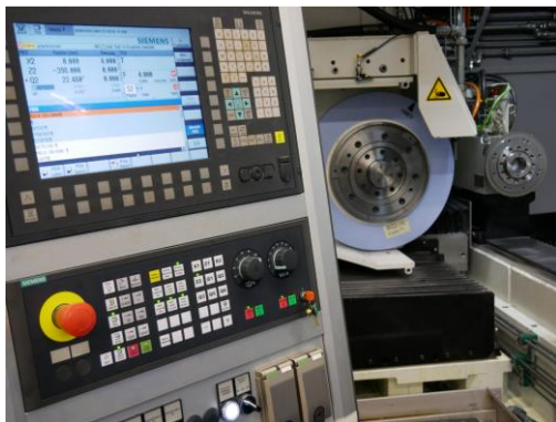
Abbildung: IFT-Forschungsschleifmaschine mit Bedienpanel, konventionell-keramischer Schleifscheibe und Abricht-Formrolle (links) und geometrische Vermessung einer drehzahlsynchron-geschliffenen Unrundkontur (rechts) – Quelle: IFT
