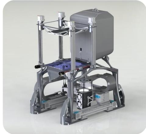
Besonders eindrucksvoll zeigen sich die Vorteile von SLEDM, dass der Arbeitsdurchmesser des LED-Parallelstrahls während der Fertigung durch Fokusvariation problemlos zwischen 0,005 mm und 5 mm variiert werden. Dadurch ist es möglich, dass größere Volumen geschmolzen werden können, ohne auf die Möglichkeit von filigranen Innenstrukturen verzichten zu müssen. Dadurch wird es erstmalig möglich sein, die Fertigungszeit der Additive Fertigung in die Richtung der zerspanenden Fertigung zu bringen.
