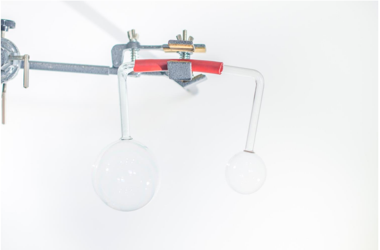
Abbildung 44: Zwei Seifenblasen bilden ein verbundenes System Apparatur: TU-Graz
