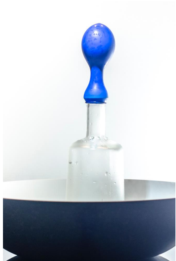
Abbildung 192: Im warmen Wasser dehnt sich der Luftballon aufgrund von einem Druckunterschied aus
