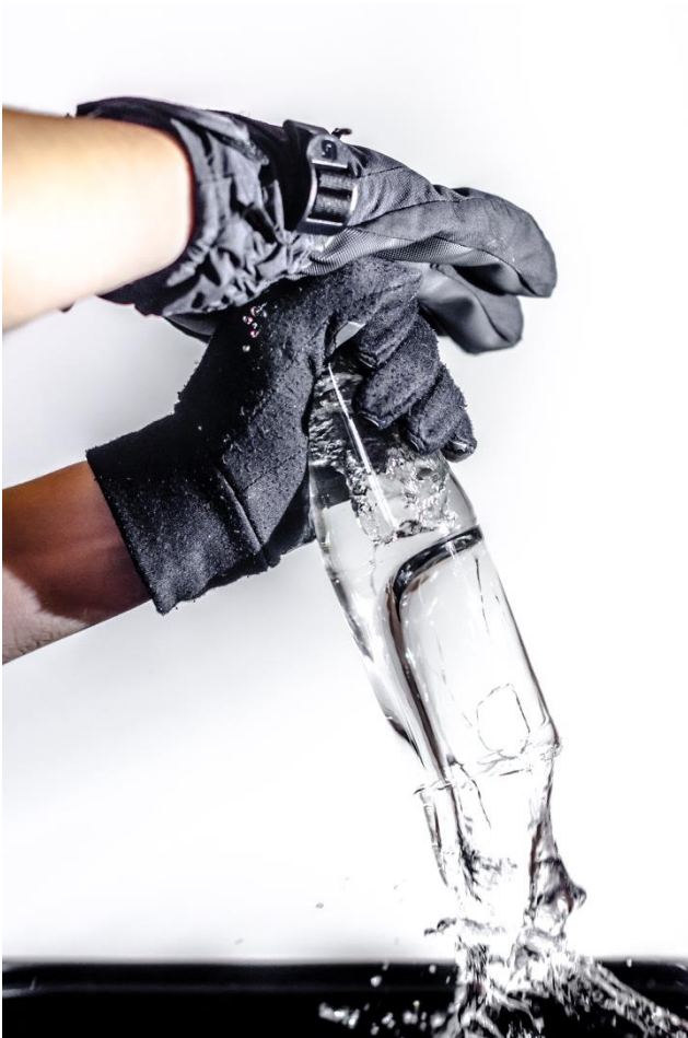
Abbildung 132: Schlag auf mit Wasser gefüllte Glasflasche – der Boden der Flasche wird abgeschlagen
