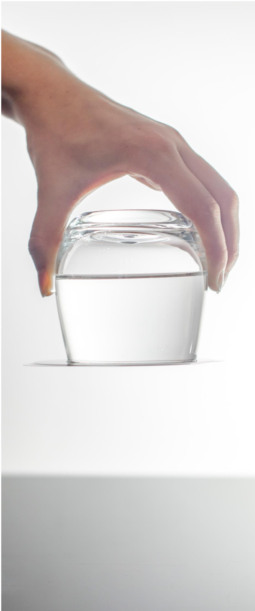
Abbildung 72: Lamiertes Papier bleibt an umgedrehtem Glas haften
