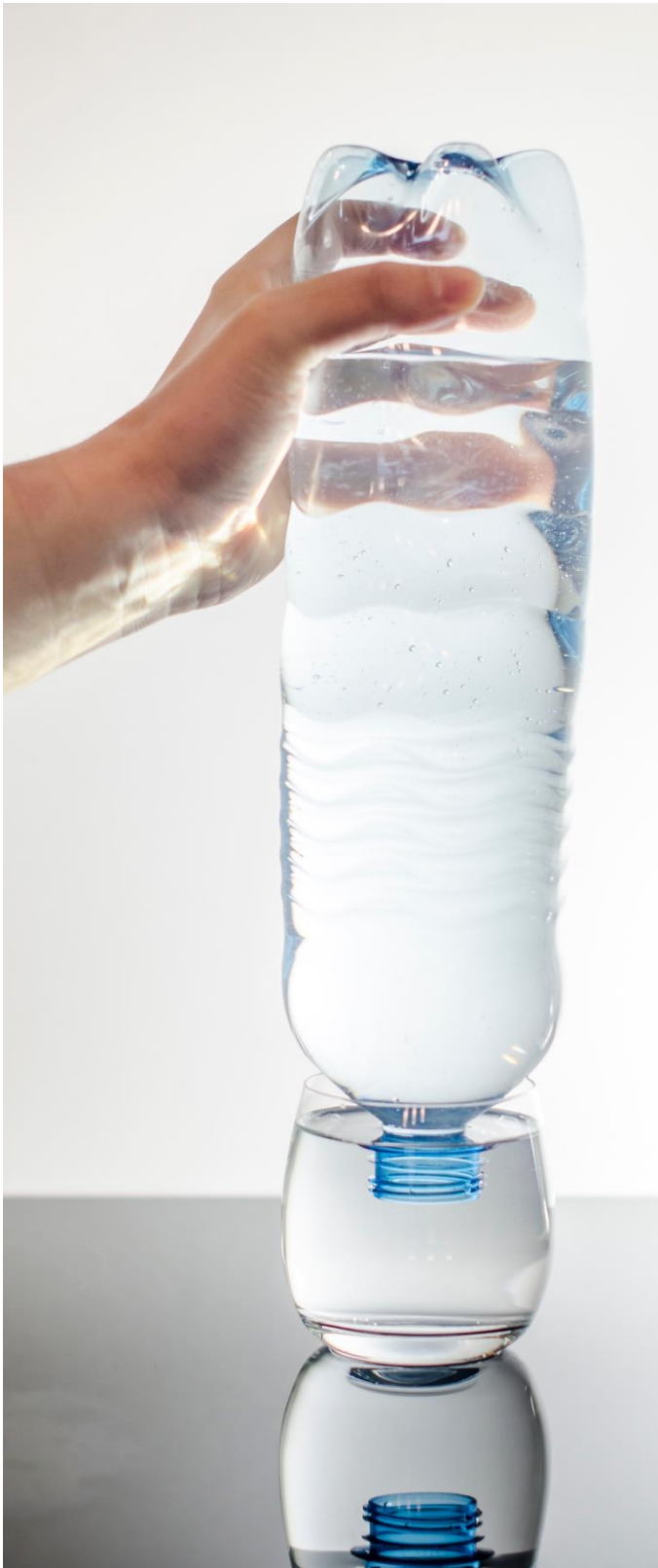
Abbildung 74: Umgedrehte Wasserflasche in einem Glas gefüllt mit Wasser – Wasserstand bleibt unverändert
