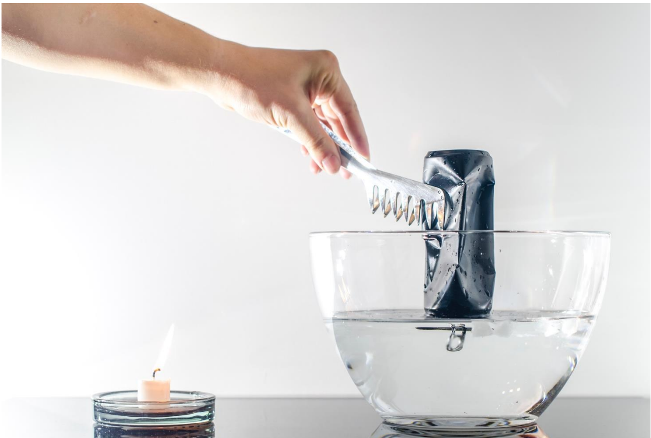
Abbildung 190: Durch das Eintauchen der Dosenöffnung in kaltes Wasser implodiert diese aufgrund des Druckunterschieds
