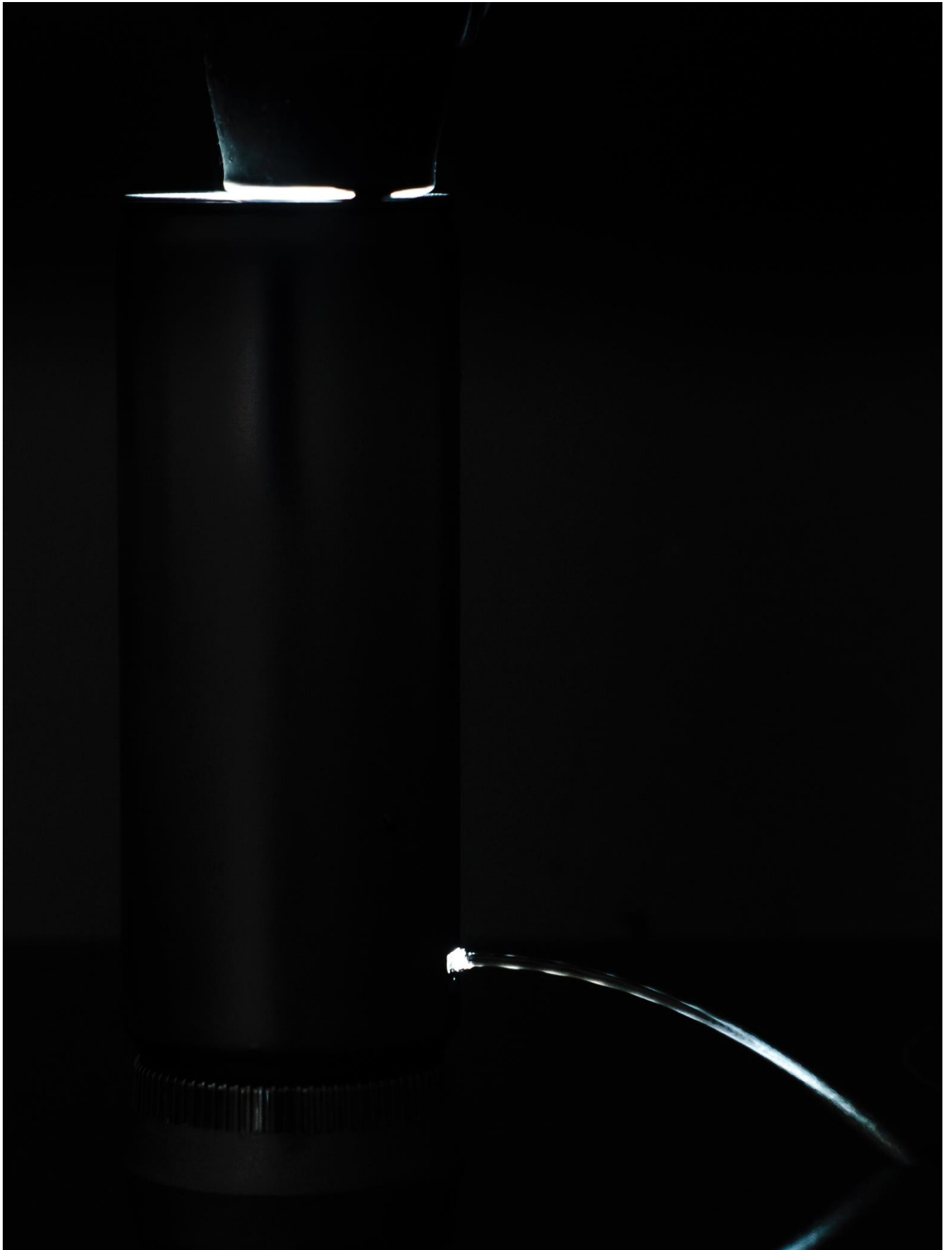
Abbildung 253: Wasser als Lichtleiter mit indirekter Beleuchtung
