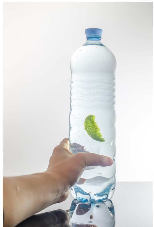
Abbildung 97: Limette als Kartesischer Taucher sinkt
