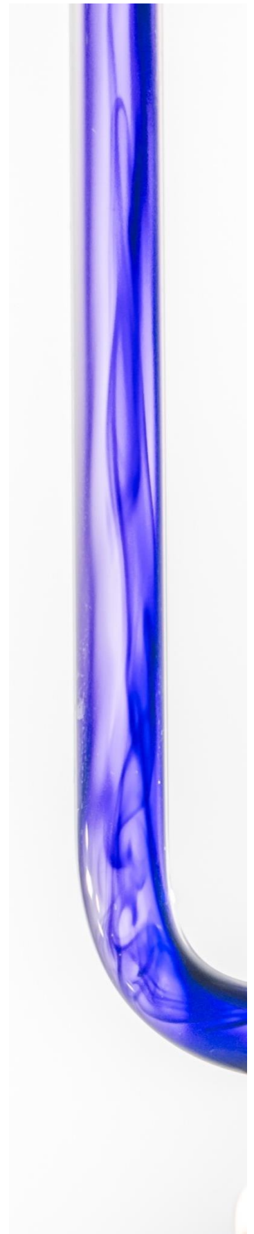
Abbildung 163: Turbulente Strömung an Abrundung des Konvektionsrohres
