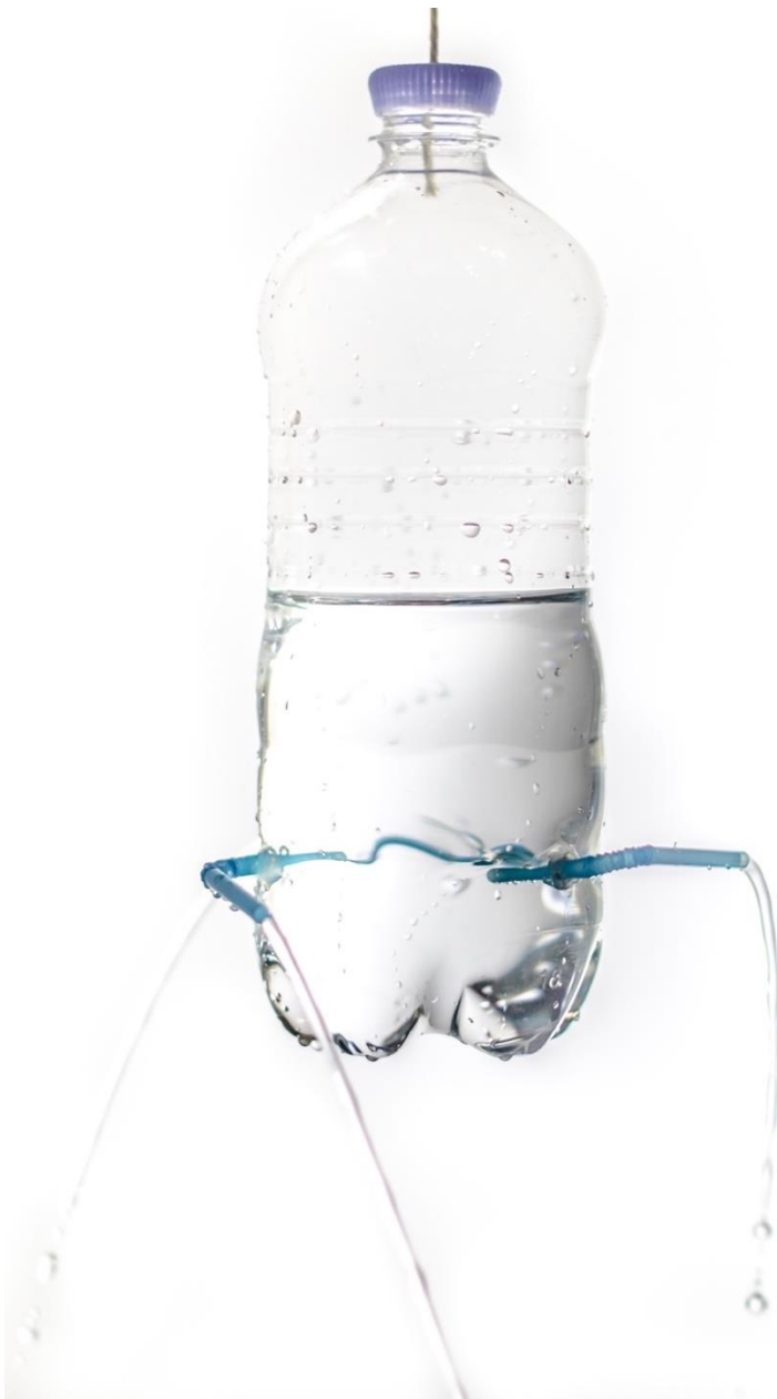
Abbildung 140: Segnersches Wasserrad – Selbstbau
