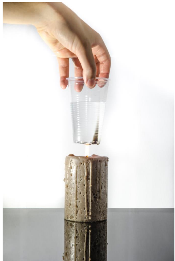
Abbildung 168: Mit Wasser gefüllter Plastikbecher brennt nicht über Kerzenflamme
