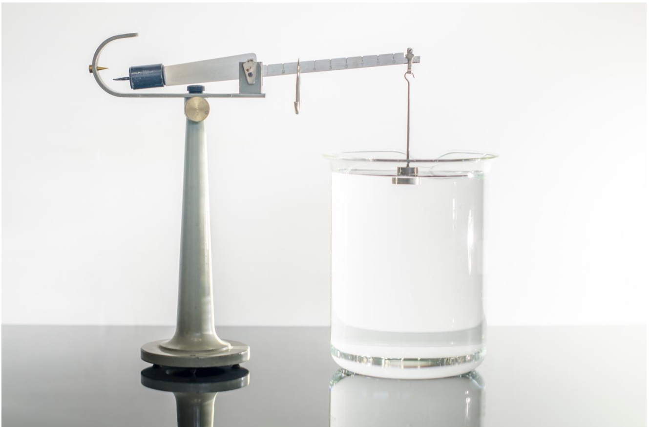
Abbildung 81: Dichtebestimmung mit Hilfe der Mohrschen Waage Apparatur: TU-Graz
