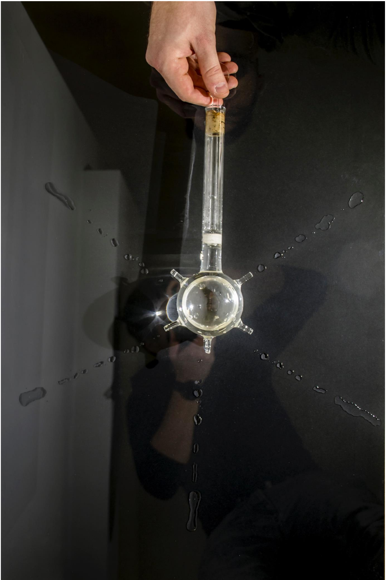
Abbildung 50: Pascal'sches Prinzip mit Hilfe eines Druckausbreitungsgeräts Apparatur: TU-Graz
