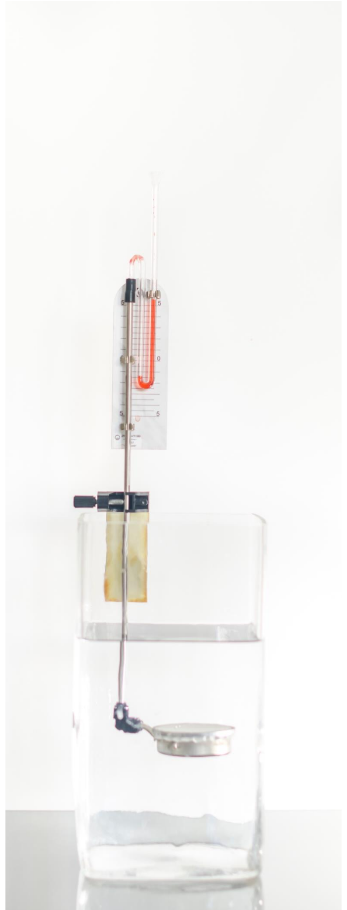
Abbildung 69: Druckdose mit U-Rohr Manometer bei steigendem Druck im Wasser
