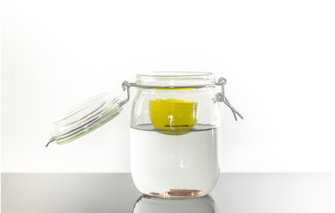
Abbildung 83: Niedrigerer Wasserpegel bei leerer Kapsel und Münzen im Wasser
