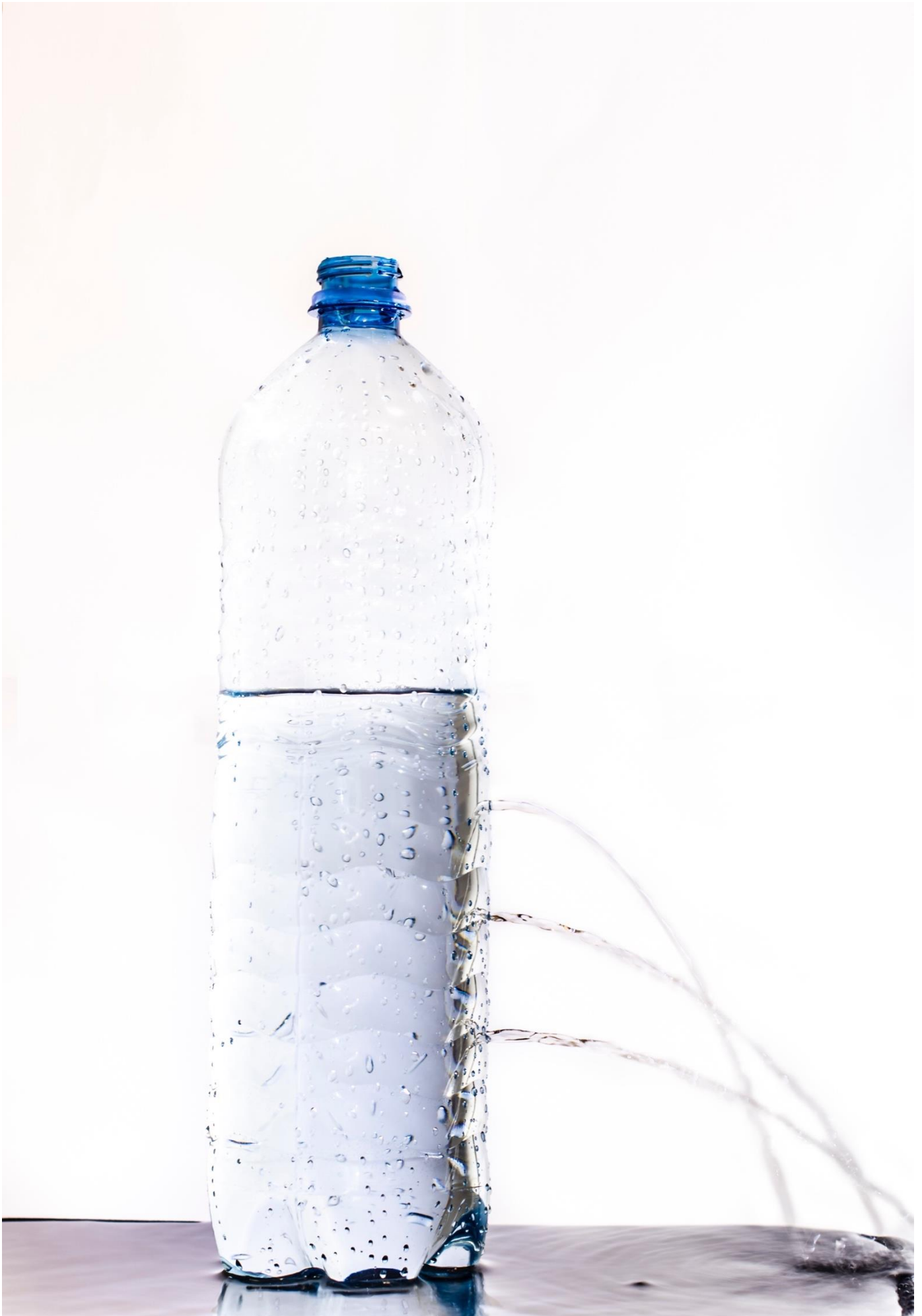
Abbildung 65: Druckunterschiede in einer Flasche
