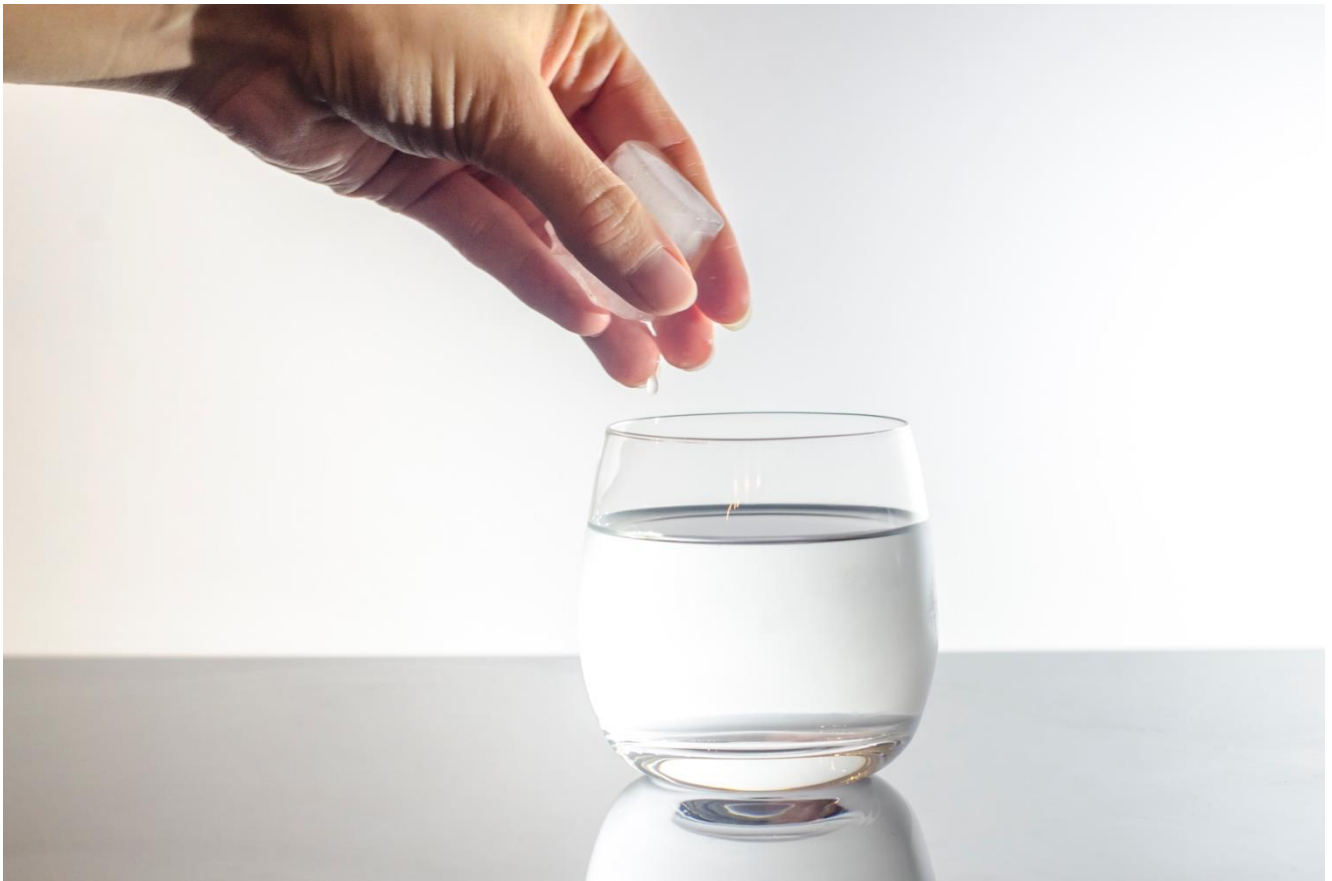
Abbildung 218: Ein Eiswürfel wird in unterkühltes Wasser gegeben
