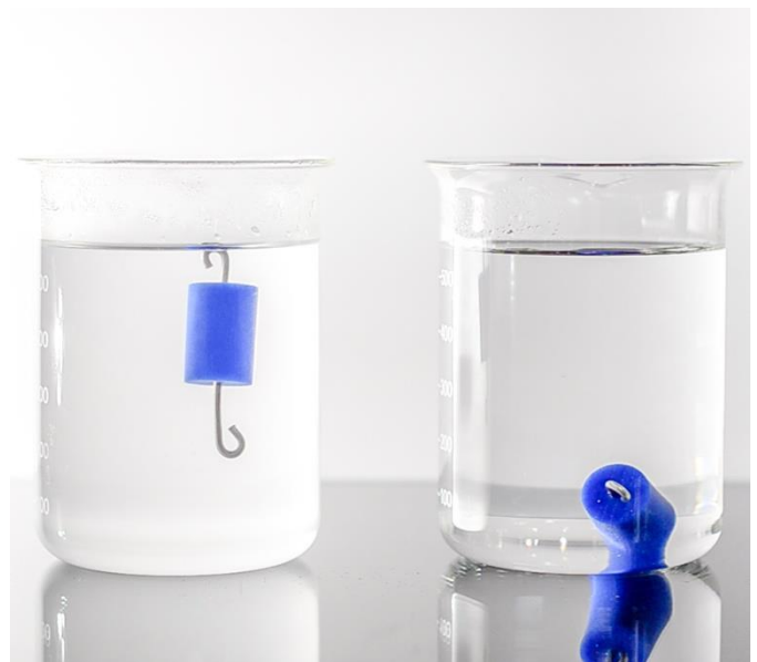
Abbildung 173: Der Körper im heißen Wasser schwimmt an die Oberfläche, während der Körper im kalten Wasser am Boden bleibt
