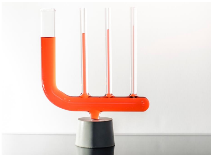
Abbildung 15: Steighöhe einer benetzenden Flüssigkeit in Abhängigkeit des Durchmessers Apparatur: TU-Graz
