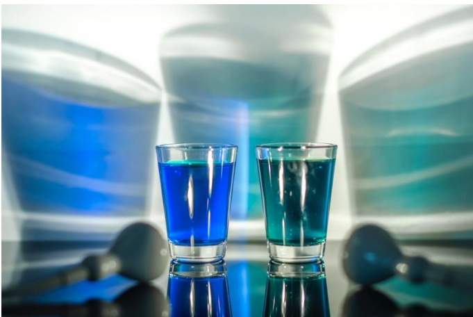
Abbildung 265: Additive Farbmischung mit blauem und grünem Licht – Licht im Cyan-Ton entsteht
