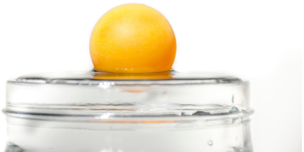
Abbildung 27: Tischtennisball bewegt sich bei vollgefülltem Gefäß vom Rand hin zur Mitte und verbleibt dort
