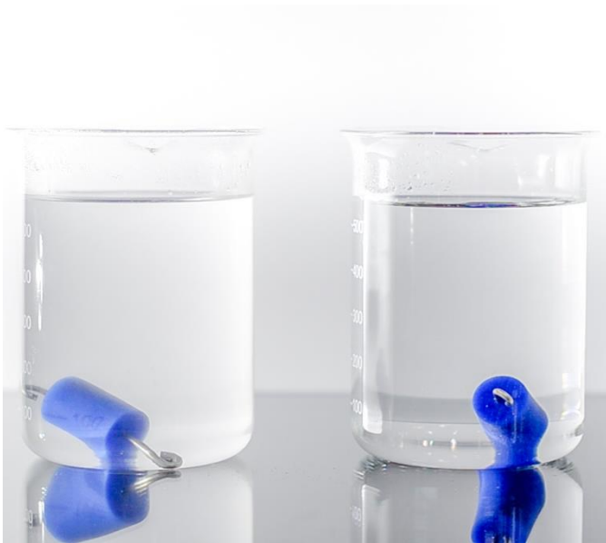
Abbildung 172: Beide schwimmende Körper befinden sich zu Beginn am Boden des Becherglases
