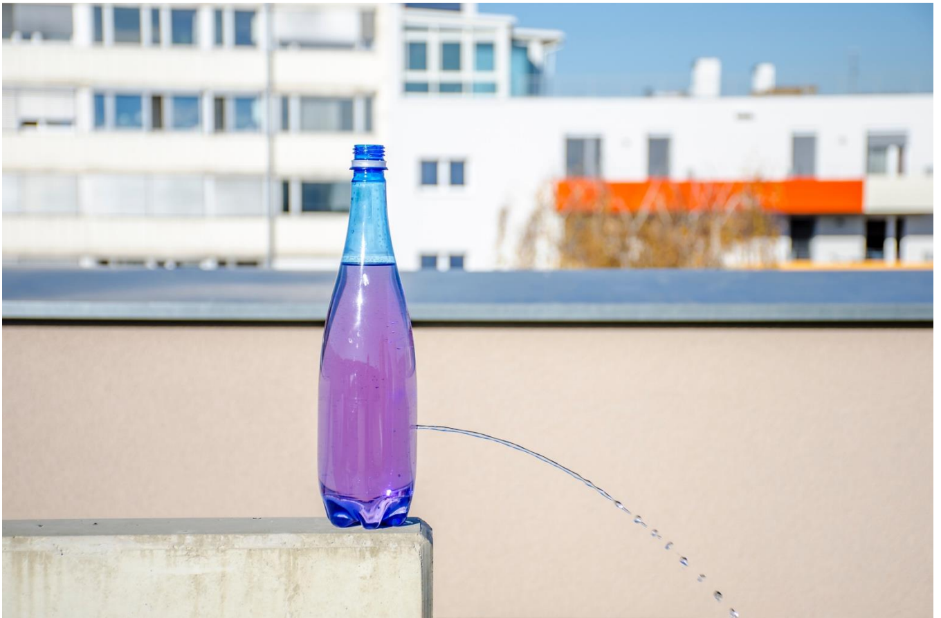
Abbildung 70: Wasser fließt aus Loch in offener Flasche
