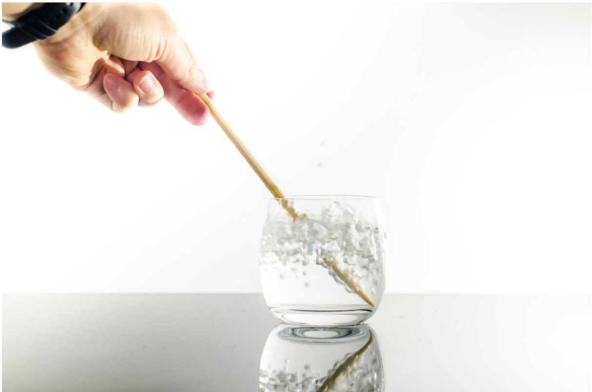
Abbildung 212: Durch Zuführen eines Fremdkörpers entstehen Siedekeime, welche zum Verdampfen der Flüssigkeit führen
