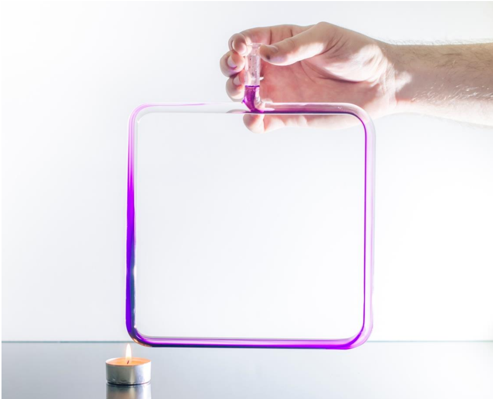
Abbildung 161: Konvektionsrohr über Teelicht – erhitztes Wasser steigt nach oben und eine Konvektionsströmung entsteht
