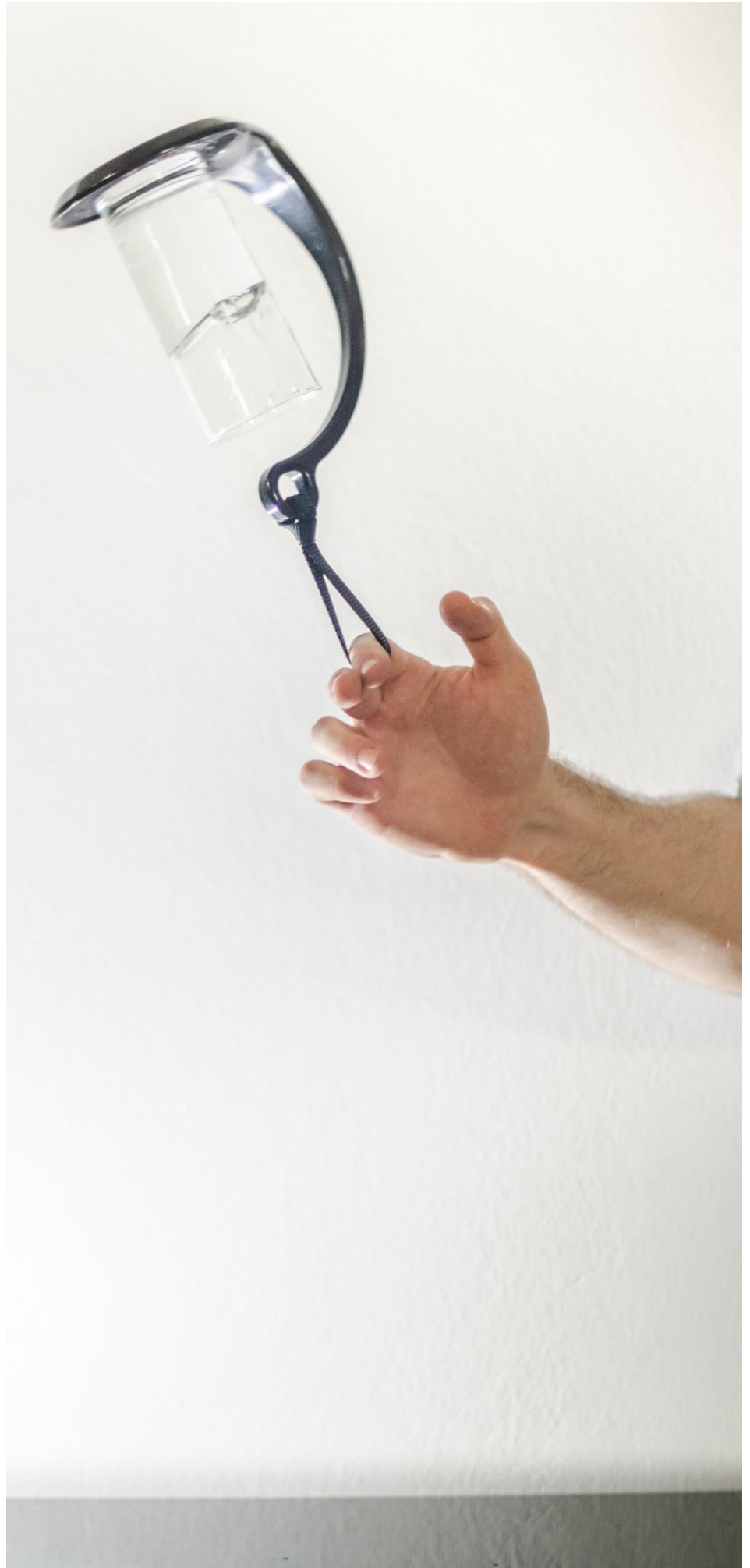
Abbildung 136: Wasserglas auf Zentrifugalschaukel – kein Wasser tritt aus Apparatur: TU-Graz
