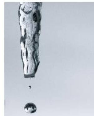
Abbildung 12: Tropfenbildung durch Oberflächenspannung
