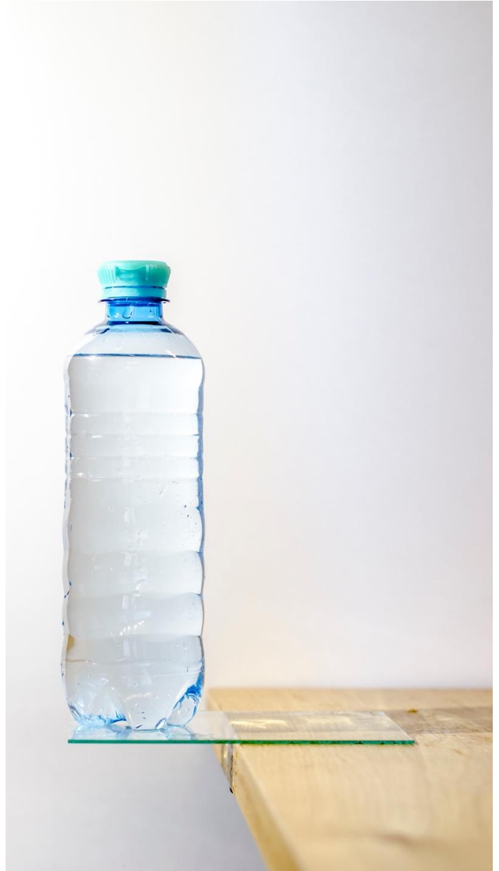
Abbildung 17: Wasser unter der Glasplatte wirkt „klebend“
