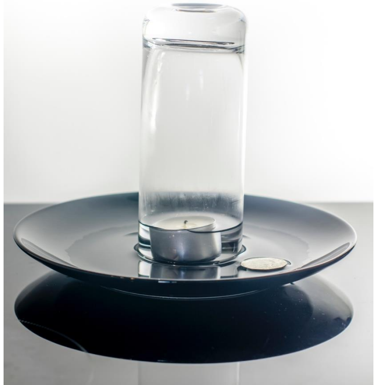
Abbildung 188: Wasseranstieg aufgrund von Unterdruck – die Münze wird „trockengelegt“
