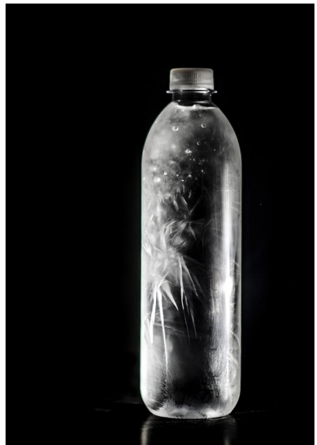
Abbildung 215: Erkennbare Kristallstruktur im unterkühlten, gefrorenen Wasser
