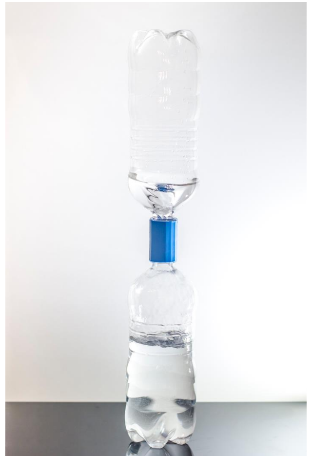
Abbildung 60: Beinahe vollständig durch Rotation entleerte Flasche
