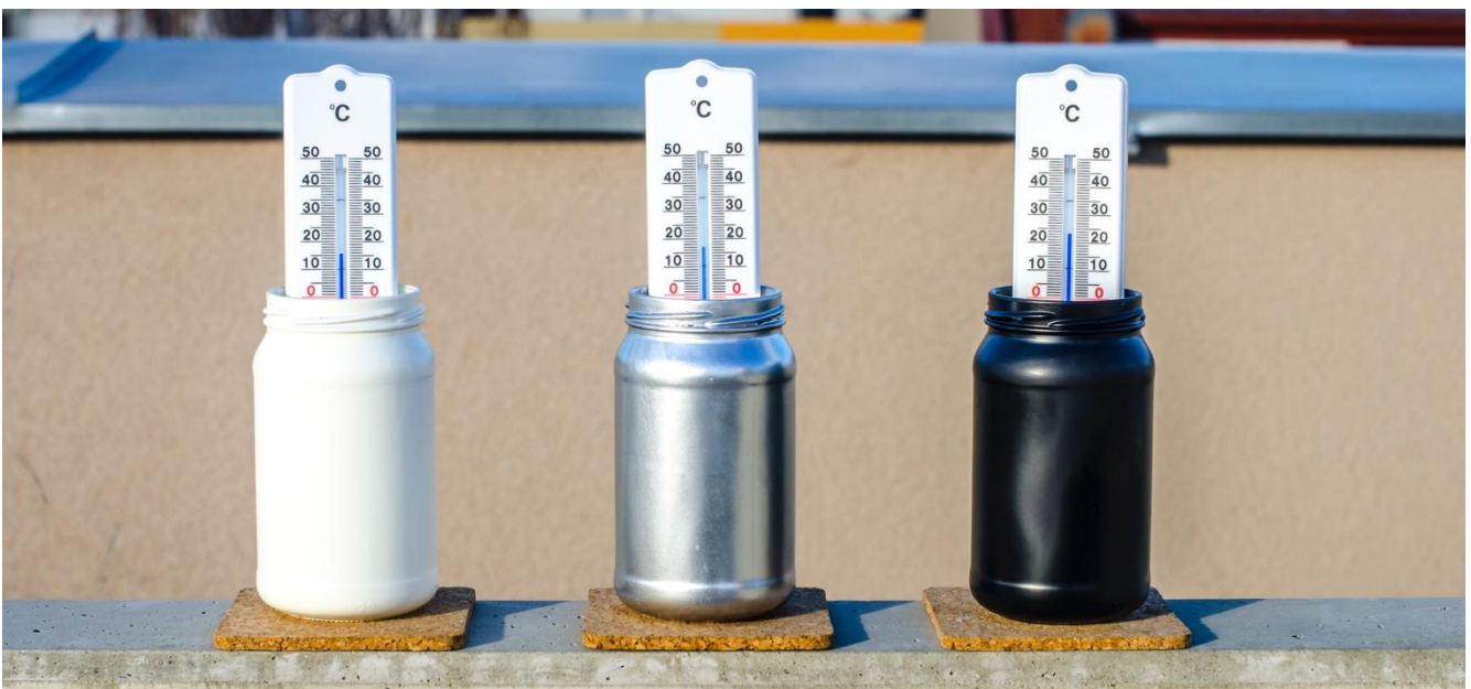
Abbildung 171: Nach einer Stunde beträgt die Temperatur 10,5°C im weißen, 12,5°C im grauen sowie 23°C im schwarzen Glas
