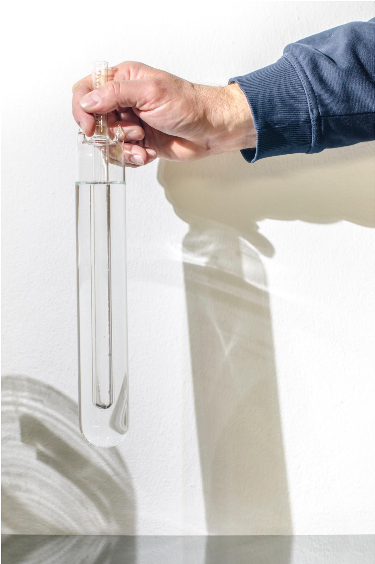
Abbildung 302: Wasserhammer – Durch schnelles Auf- und Abwärtsbewegen entsteht ein Knall Apparatur: TU-Graz
