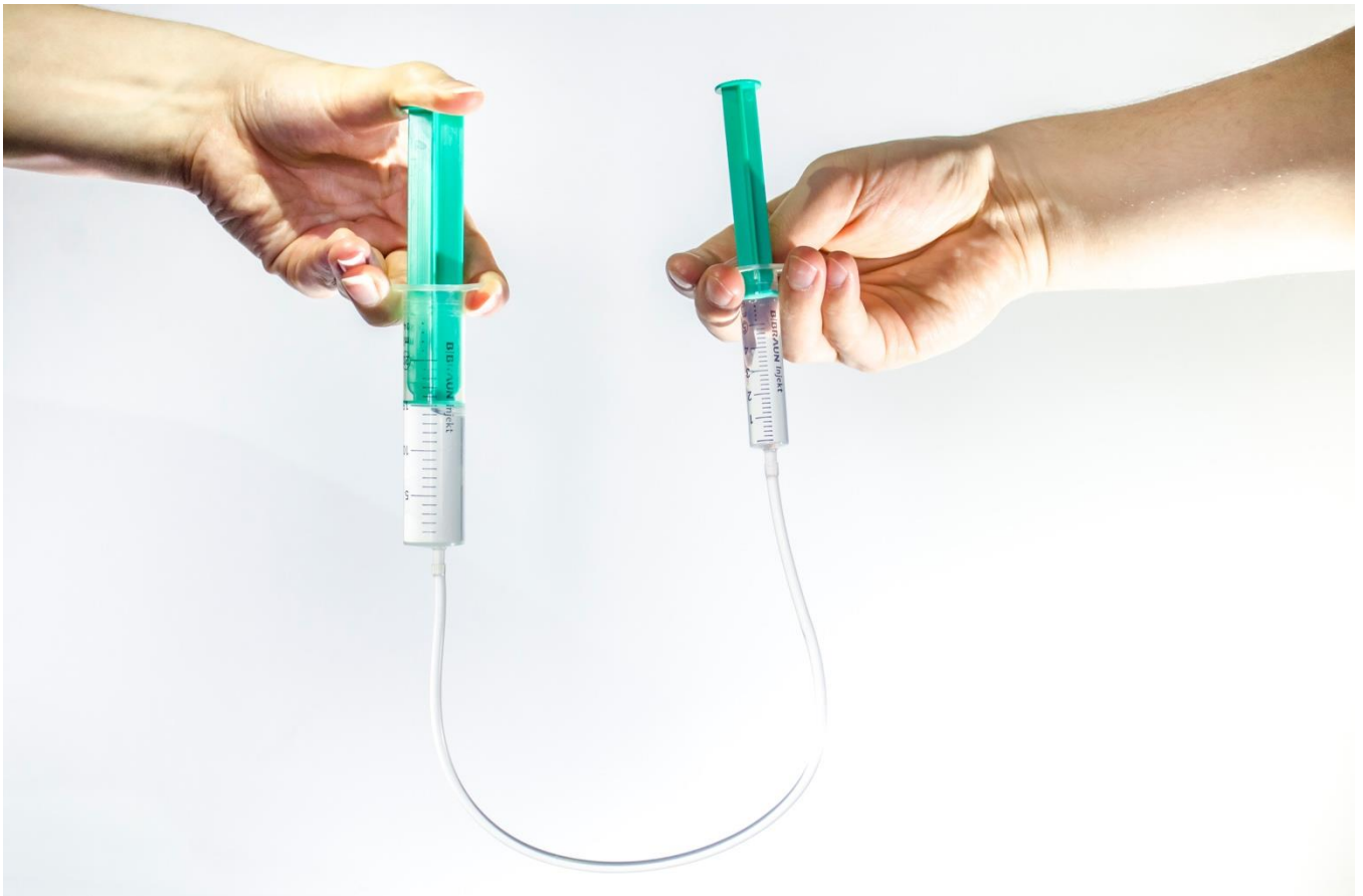
Abbildung 51: Wasser wird durch Drücken der großen Spritze mit hohem Kraftaufwand in die kleinere befördert
