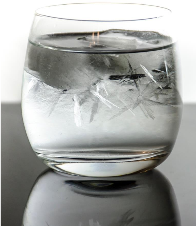
Abbildung 219: Durch das Einwerfen bilden sich Kristallisationskeime und Eiskristalle entstehen
