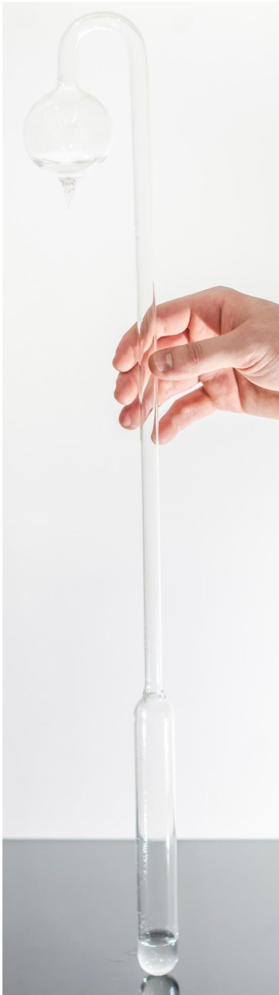
Abbildung 198: Kryophor mit flüssigem Wasser oben und unten
