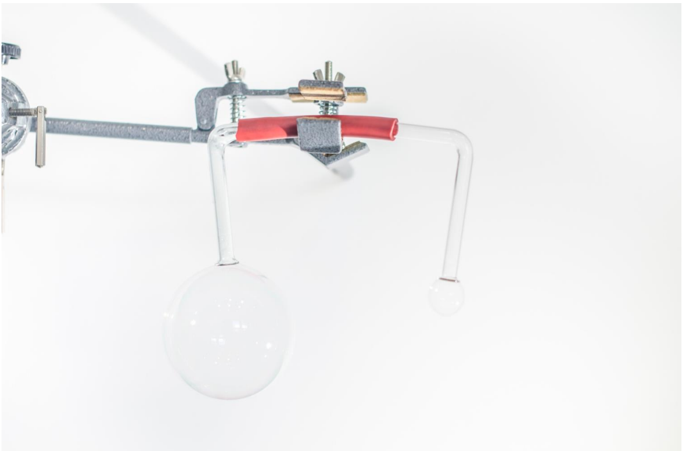
Abbildung 45: Aufblasen der großen Seifenblase auf Kosten der kleineren Apparatur: TU-Graz
