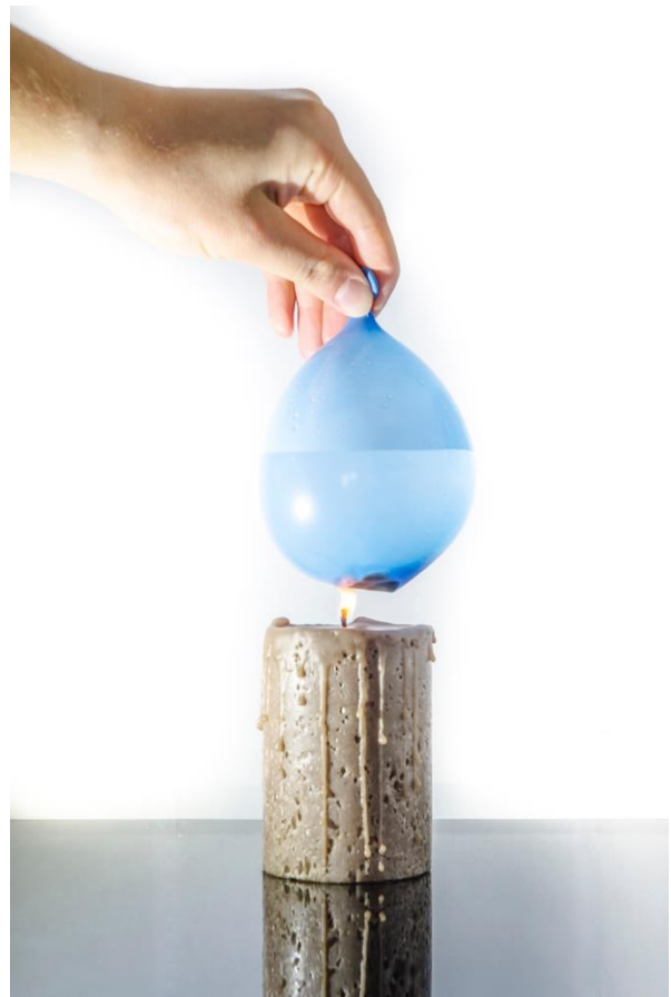
Abbildung 166: Mit Wasser gefüllter Luftballon zerplatzt nicht über Kerzenflamme
