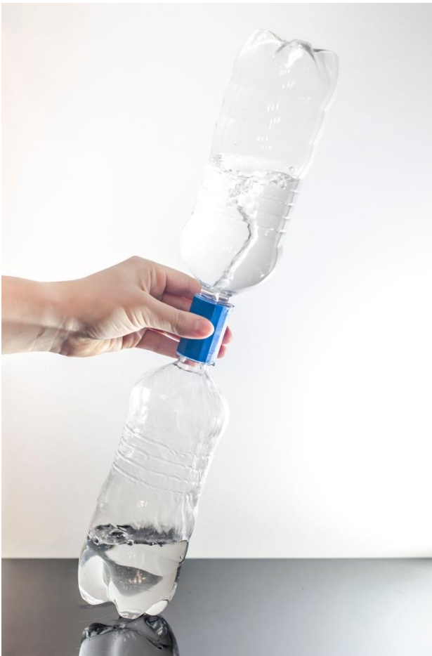
Abbildung 59: Durch Kippen der Flasche erhält der Tornado einen Knick
