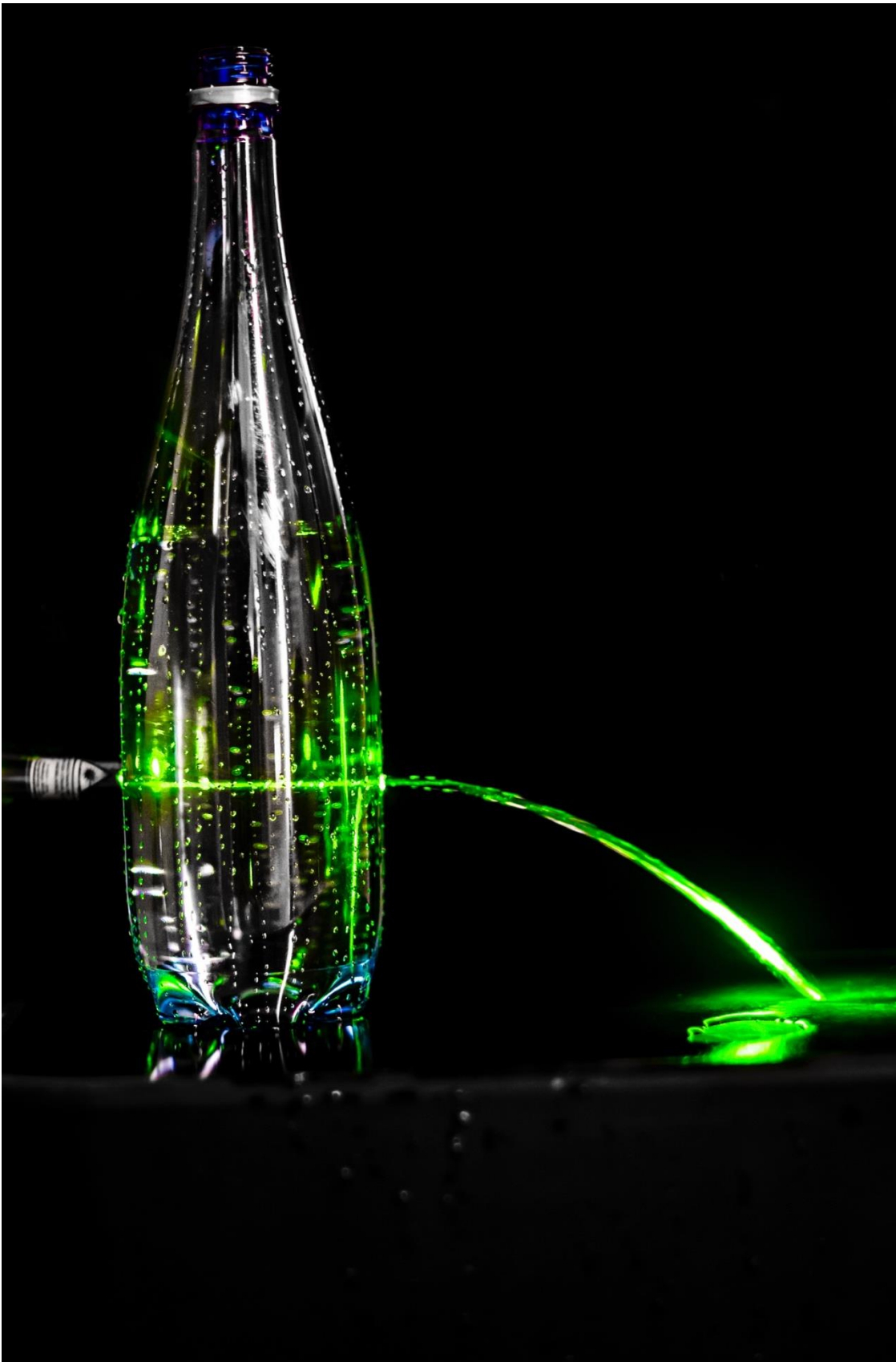
Abbildung 249: Lichtleitung mit Hilfe eines Wasserstrahls
