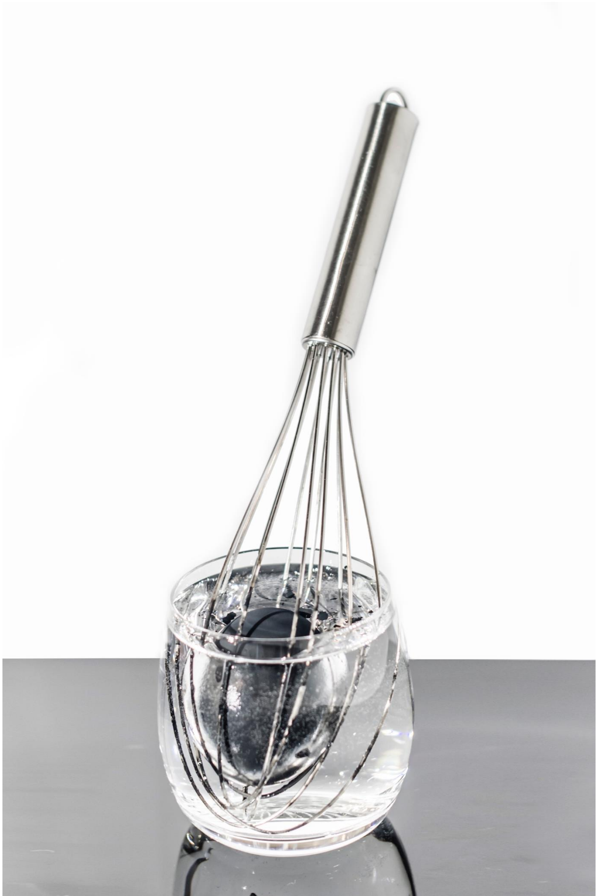
Abbildung 248: Die unter Wasser gehaltene Oberfläche des Eis wirkt durch Rußbeschichtung spiegelnd
