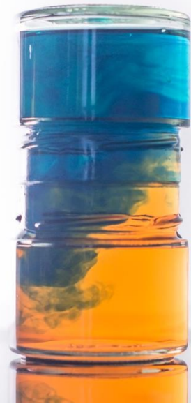
Abbildung 158: Oranges, warmes Wasser unten; kaltes, blaues Wasser oben – es kommt zur Vermischung der beiden Flüssigkeiten
