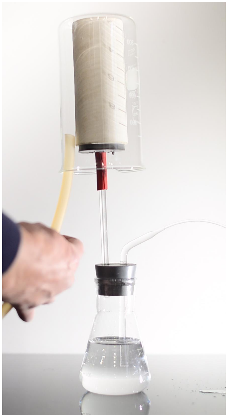
Abbildung 182: Druckanstieg aufgrund von diffundierendem Helium Apparatur: TU-Graz
