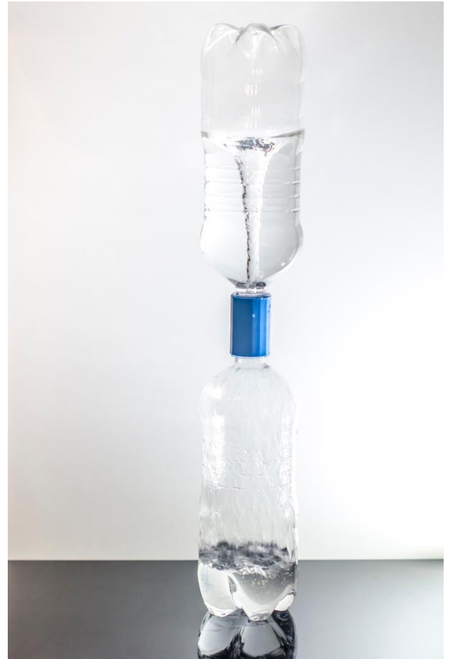
Abbildung 58: Durch Drehbewegung entsteht ein Tornado – Wasser fließt nach unten
