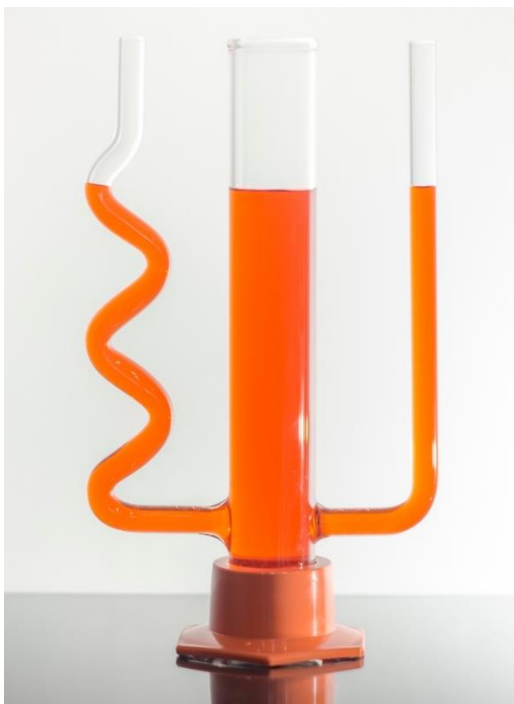
Abbildung 46: Kommunizierende Röhren Apparatur: TU-Graz
