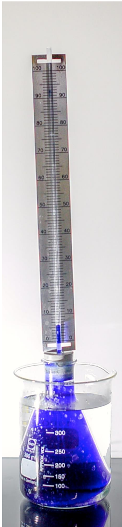
Abbildung 150: Wasserstand sinkt durch Erwärmen des Wassers – geringere Dichte
