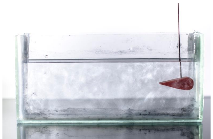
Abbildung 128: Strömungslinien einer Stromlinienform – breite Seite nach vorne gerichtet Apparatur: TU-Graz
