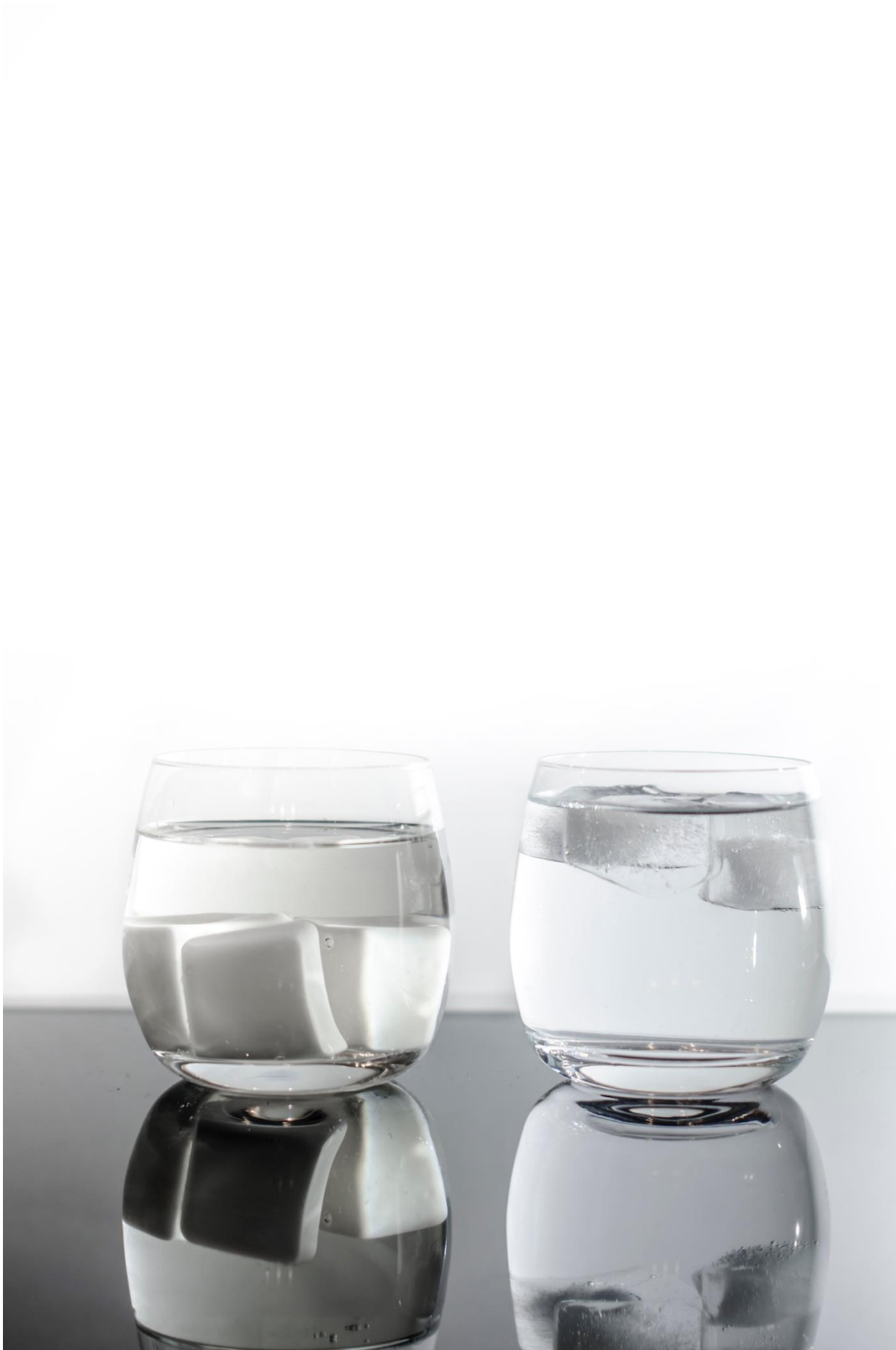
Abbildung 145: Festes Wachs sinkt in flüssigem Wachs während Eiswürfel im Wasserglas schwimmen
