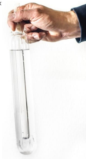
Abbildung 9: Tripelpunkt Wasserzelle. Zu erkennen sind die drei Phasen Wasser, Eis und Dampf
