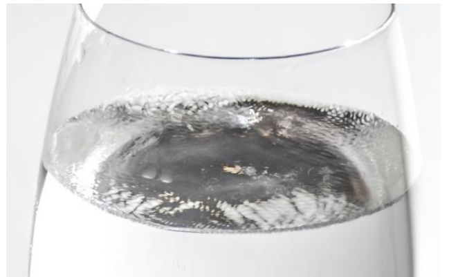
Abbildung 297: Haft- und Gleitreibung des Fingers erzeugen Schwingungen im Glas
