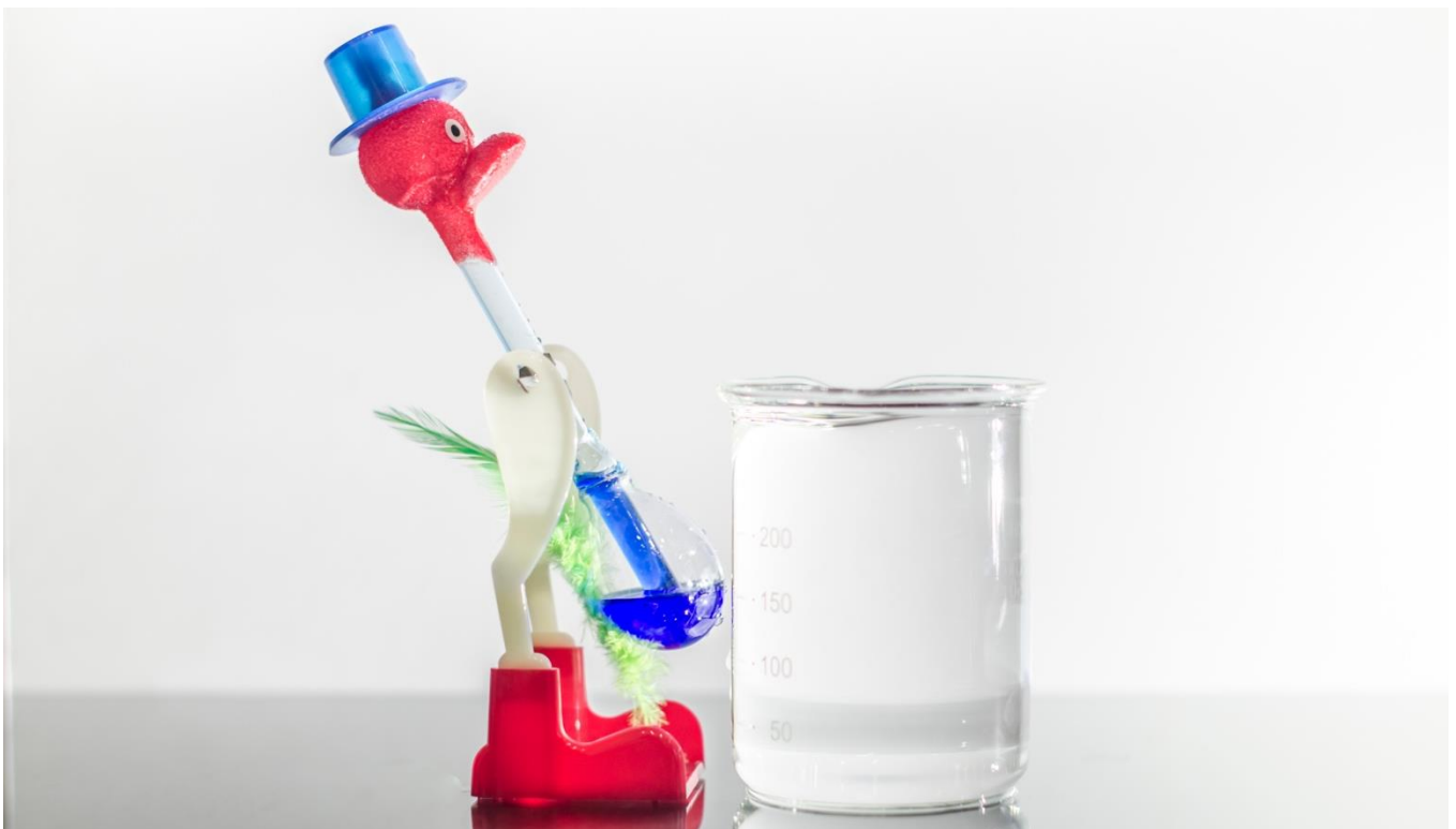
Abbildung 204: Durch ständige Verlagerung des Schwerpunktes, beginnt die Ente zu wippen
