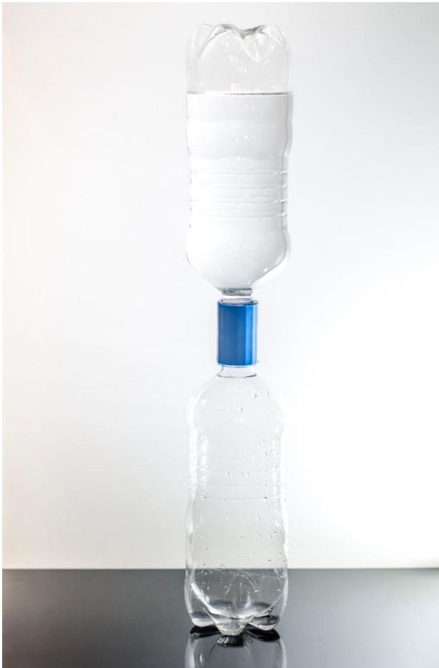
Abbildung 57: Durch Verbindungsstück verbundene Flaschen – kein Wasser fließt
