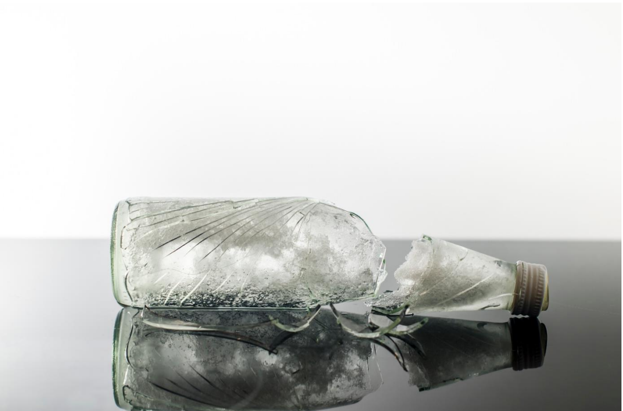
Abbildung 154: Zersprungene Flasche durch Einfrieren von Wasser im Tiefkühlschrank
