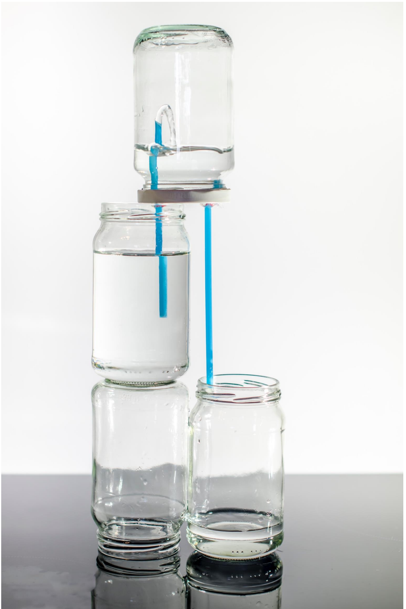
Abbildung 78: Fließende Fontäne im Heronsbrunnen
