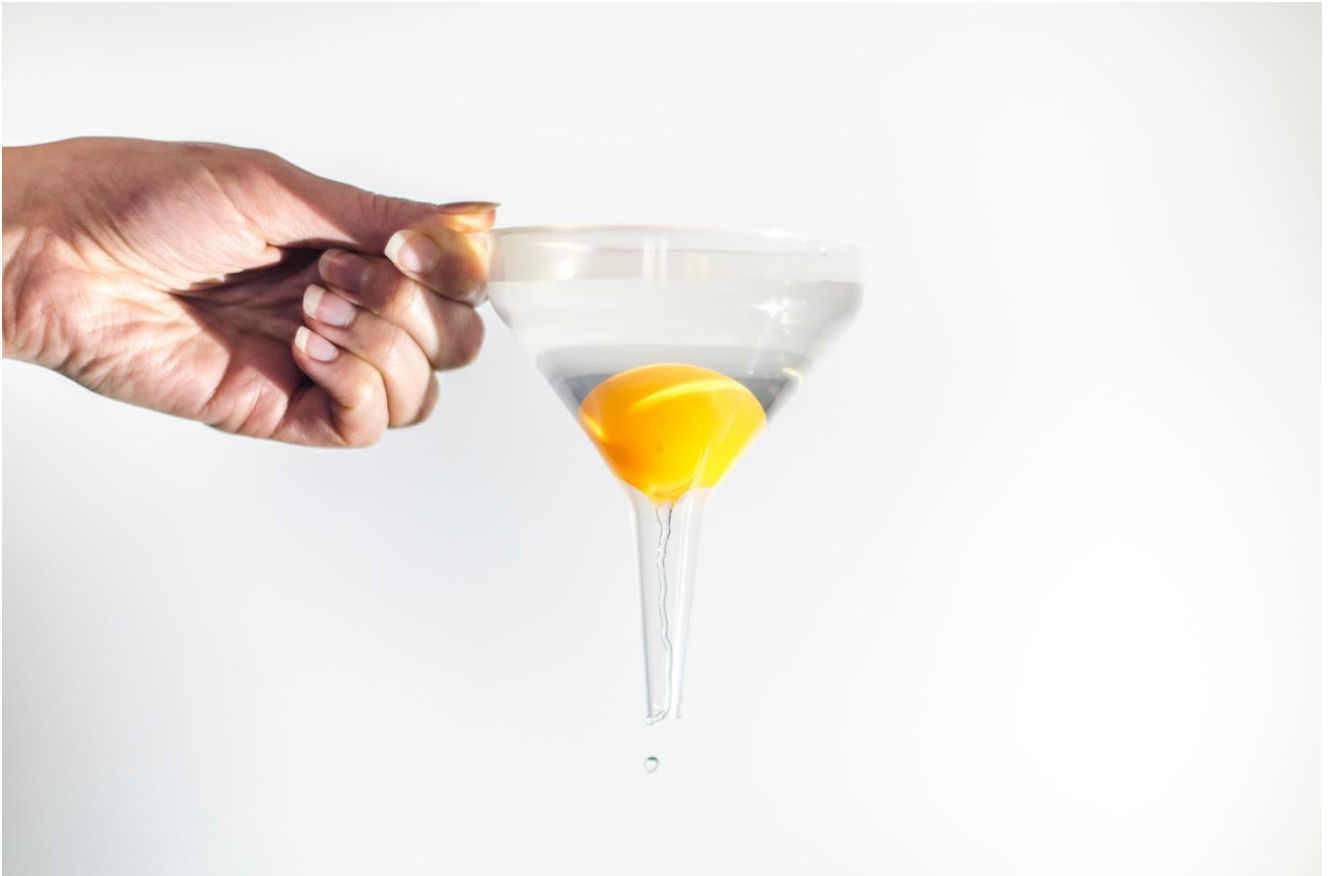
Abbildung 86: Offene Trichtertülle – Tischtennisball bleibt haften
