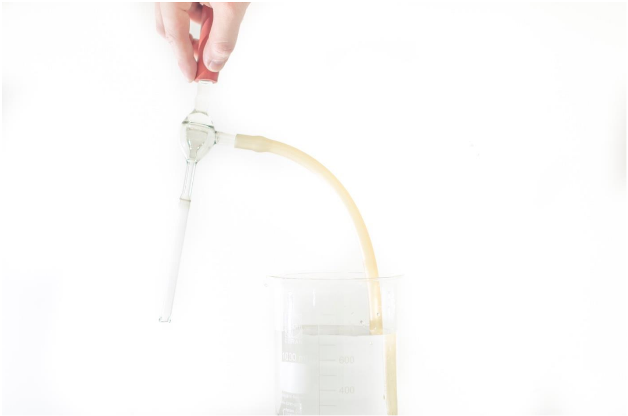
Abbildung 117: Bei abgedrehtem Wasserhahn wird kein Wasser aus dem Behälter gesaugt Apparatur: TU-Graz
