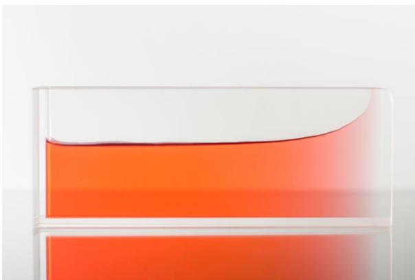
Abbildung 13: Konkaver Meniskus in einem Glaskeil. Mit Wasser vermengtes Phenol ist benetzend Apparatur: TU-Graz
