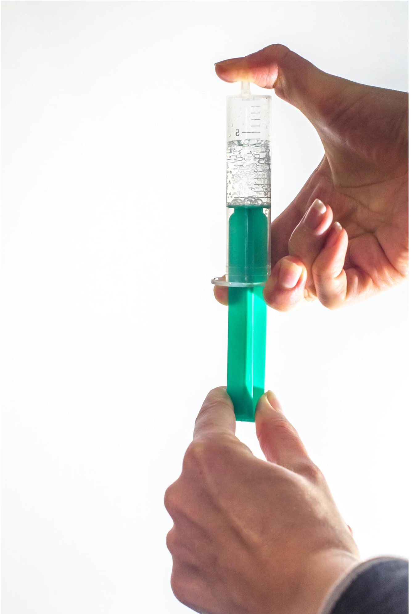
Abbildung 197: Wasser kocht fängt bei Zimmertemperatur in der Spritze aufgrund von verringertem Luftdruck an zu kochen
