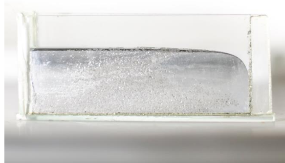
Abbildung 14: Konvexer Meniskus in einem Glaskeil. Quecksilber ist nicht benetzend Apparatur: TU-Graz
