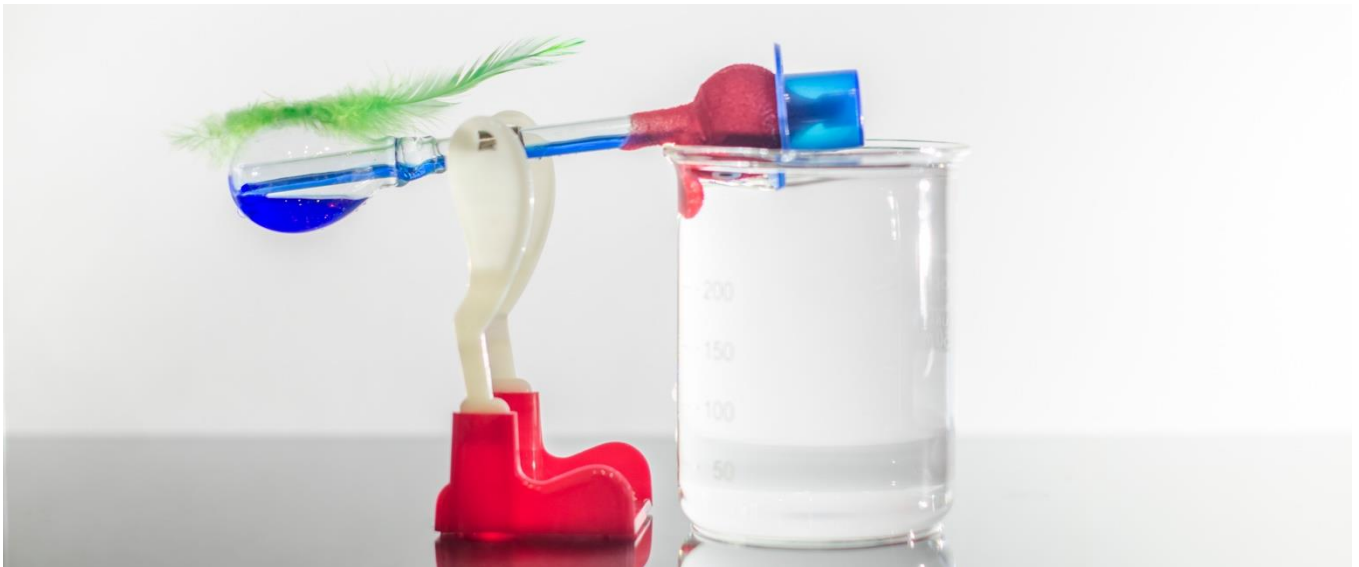
Abbildung 203: Fortgeschrittener Austausch – das Gewicht der Ente verlagert sich nach hinten
