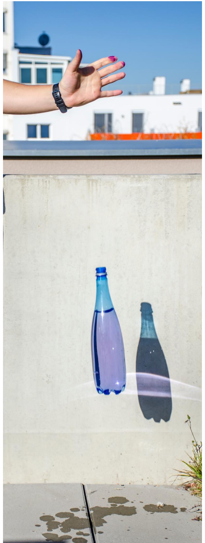
Abbildung 103: Im freien Fall tritt kein Wasser aus Loch aus
