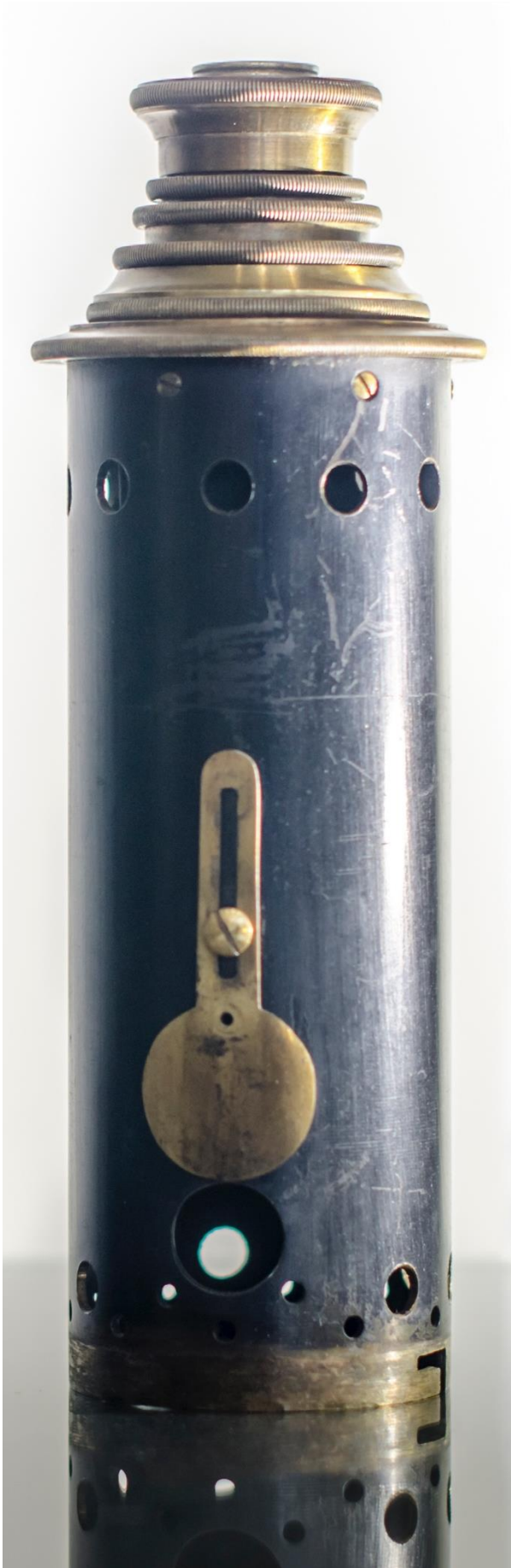
Abbildung 200: Bestandteile eines Hypsometers Apparatur: TU-Graz
