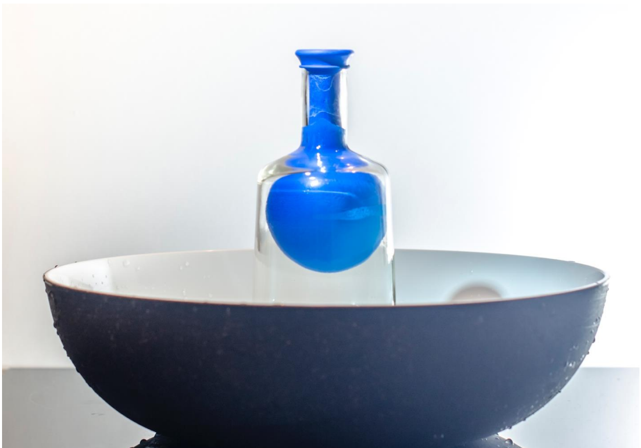
Abbildung 193: Im kalten Wasser wird der Luftballon aufgrund von einem Druckunterschied in das Flascheninnere gezogen
