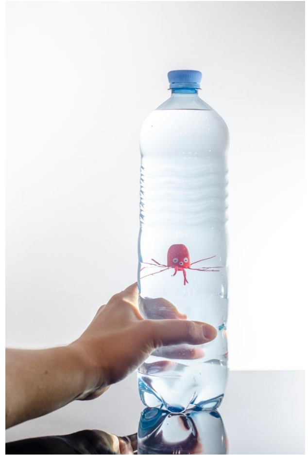
Abbildung 95: Kartesischer Taucher sinkt durch Außendruck
