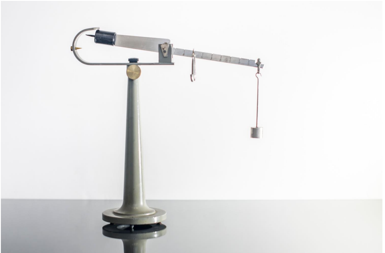
Abbildung 80: Mohrsche Waage Apparatur: TU-Graz
