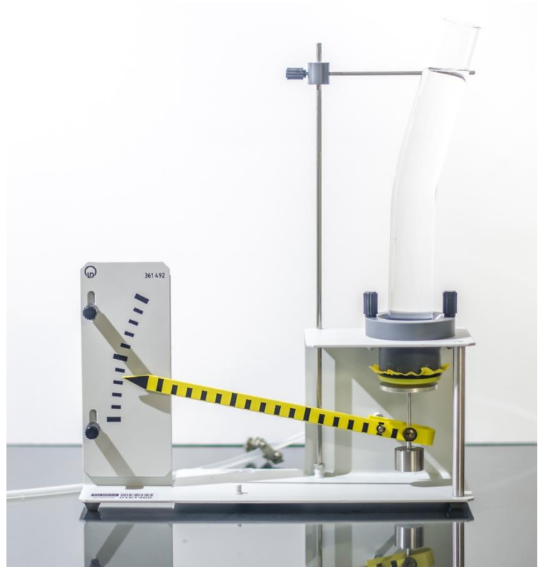
Abbildung 62: Bodendruck in einem Winkelrohr Apparatur: TU-Graz
