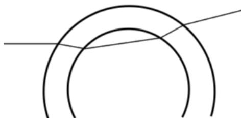
Abbildung 279: Strahlengang durch ein leeres dickwandiges Glas
