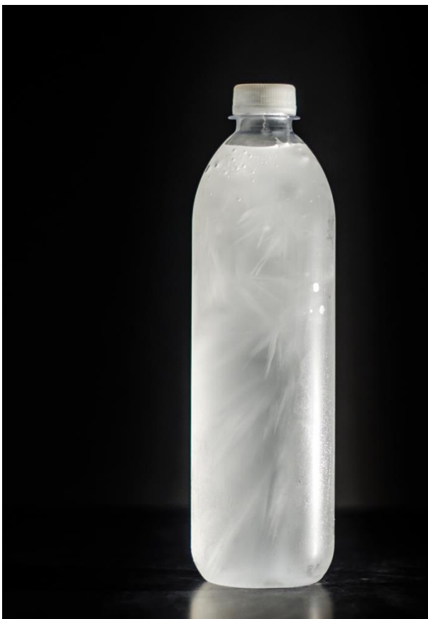
Abbildung 214: Eindeutige Eis- und Kristallbildung aufgrund beträchtlicher Unterkühlung
