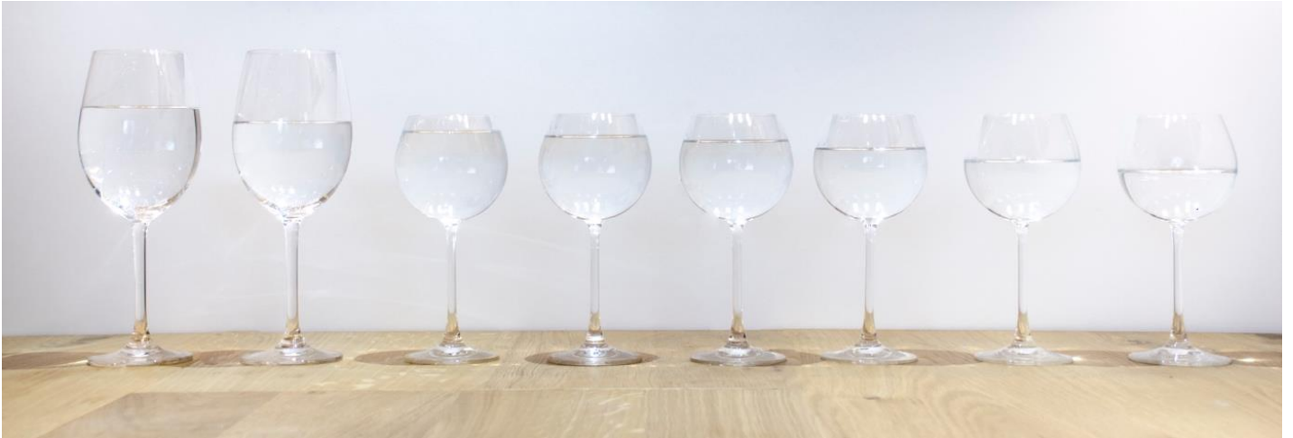
Abbildung 295: Durch unterschiedliche Mengen an Wasser entsteht die Töne einer Tonleiter
