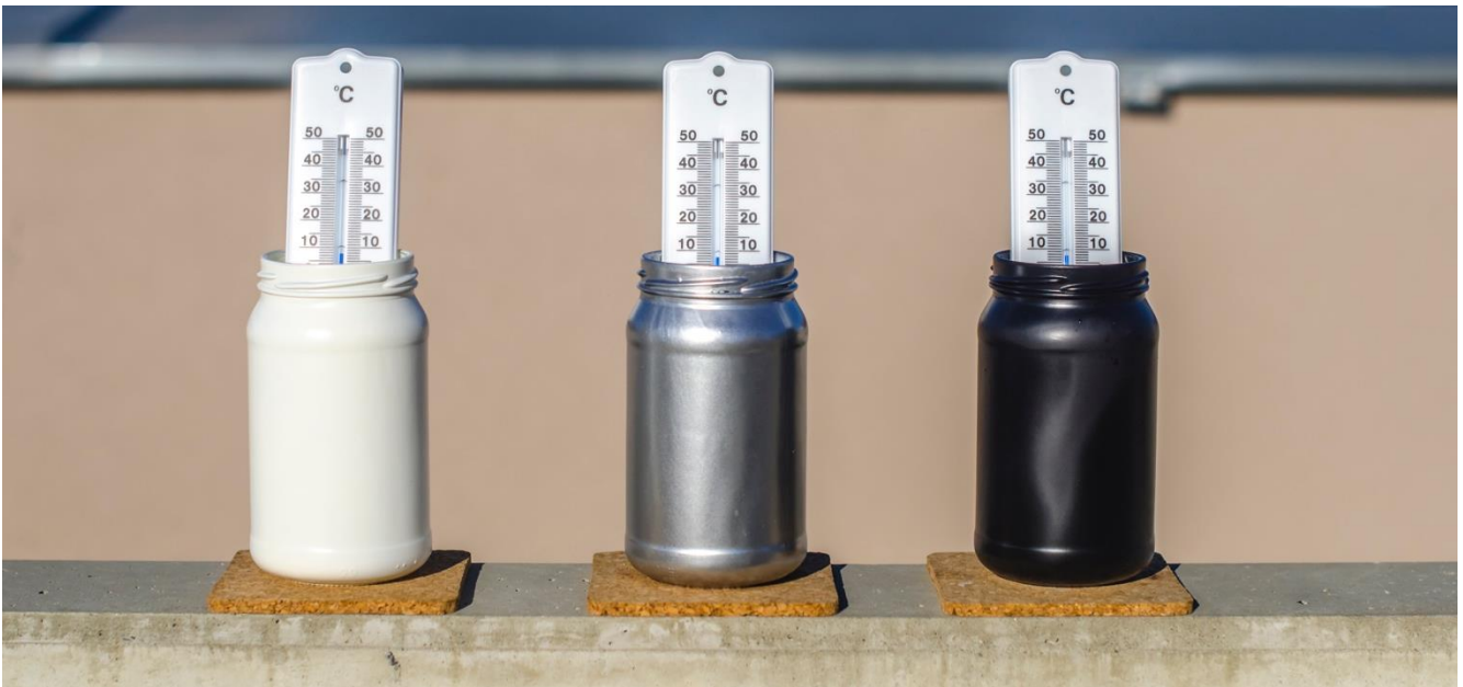
Abbildung 169: Ausgangssituation – drei Gläser in unterschiedlicher Farbe gefüllt mit Wasser gleicher Temperatur
