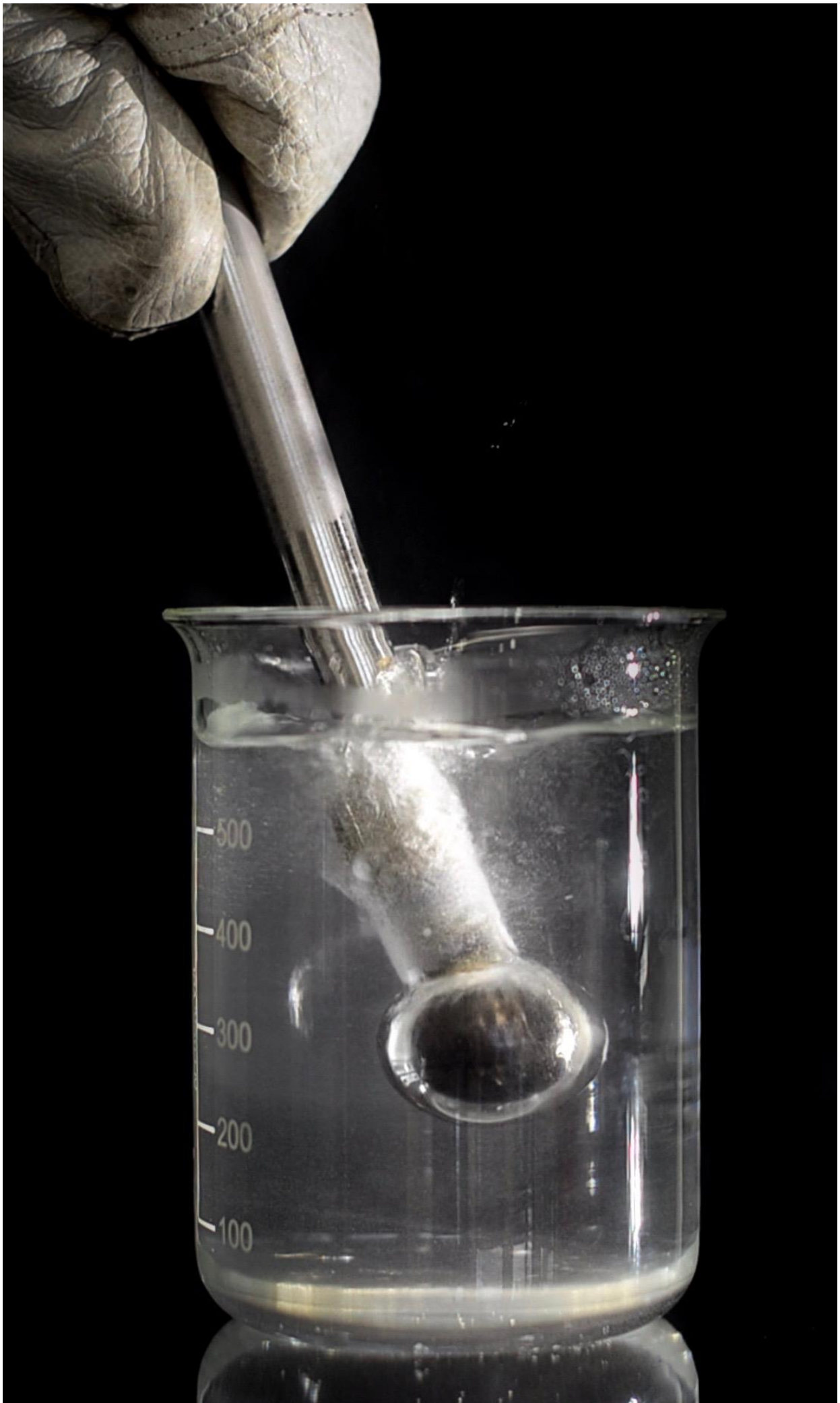
Abbildung 208: Leidenfrosteffekt – es bildet sich eine Wasserdampfschicht um die Stahlkugel
