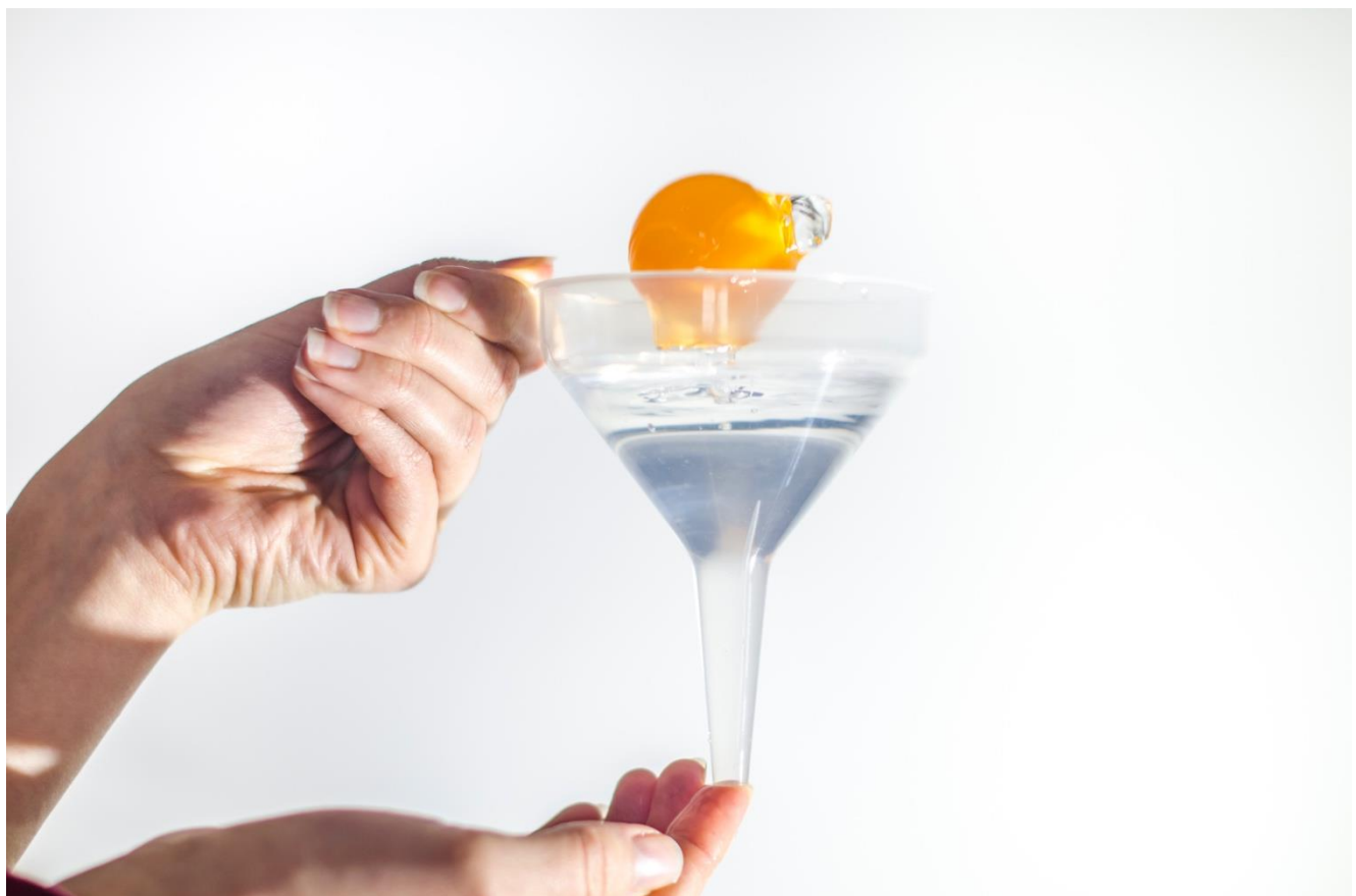
Abbildung 87: Abgedichtete Trichtertülle – Tischtennisball bewegt sich nach oben
