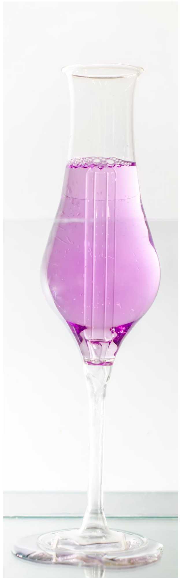
Abbildung 77: Pythagoreischer Trinkbecher – Wasserpegel übersteigt Glasröhrchen in Mitte und fließt aus
