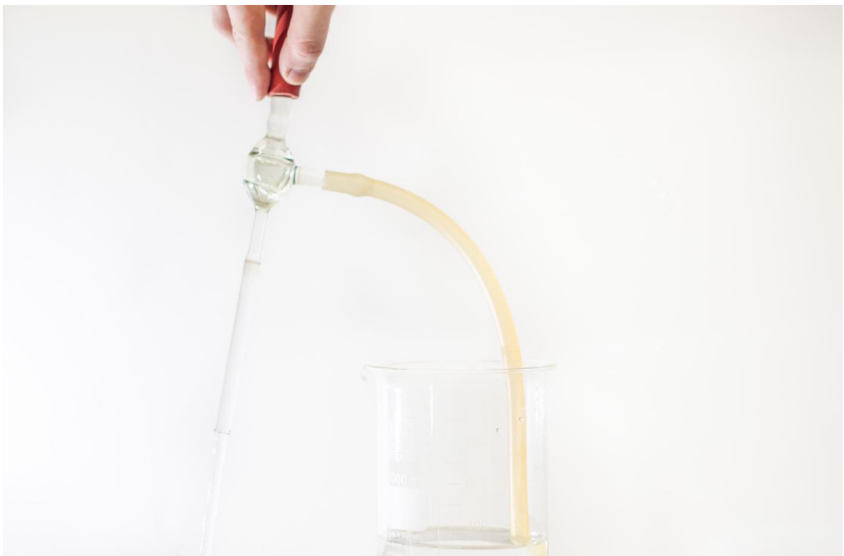
Abbildung 118: Bei aufgedrehtem Wasserhahn wird aufgrund von Bernoulli Wasser aus dem Behälter gesaugt Apparatur: TU-Graz
