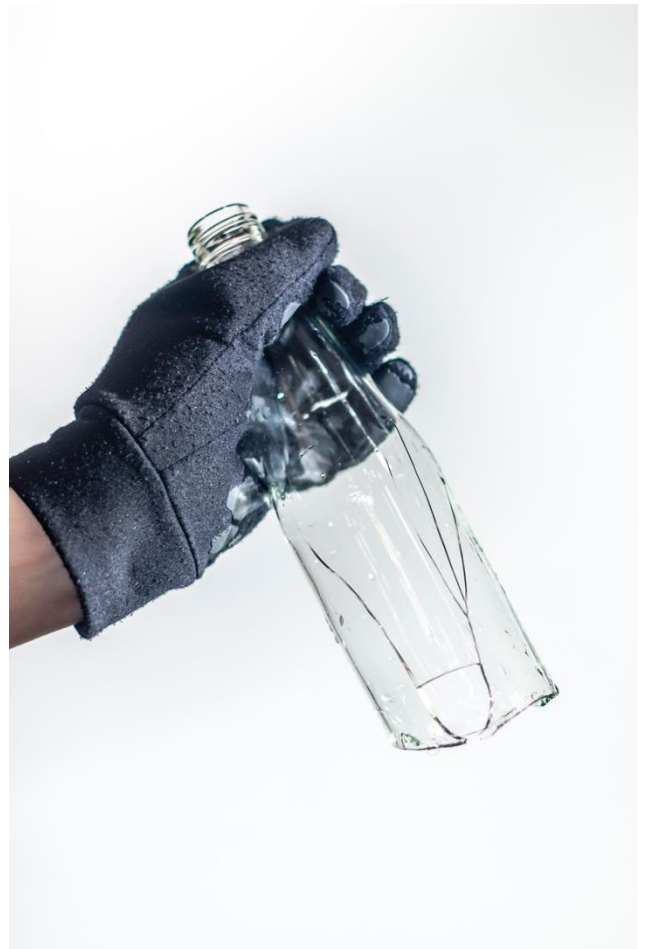
Abbildung 133: Zerbrochene Flasche aufgrund von hohem Druck – es kommt zur Kavitation
