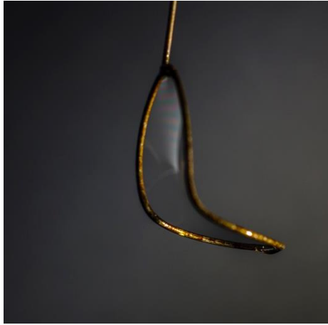
Abbildung 36: Minimalfläche bei einer Bogenform
