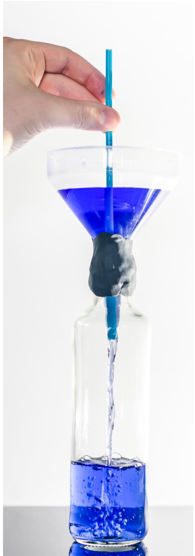
Abbildung 56: Luftaustausch durch Strohhalm wieder gegeben – Wasserfluss aufrecht
