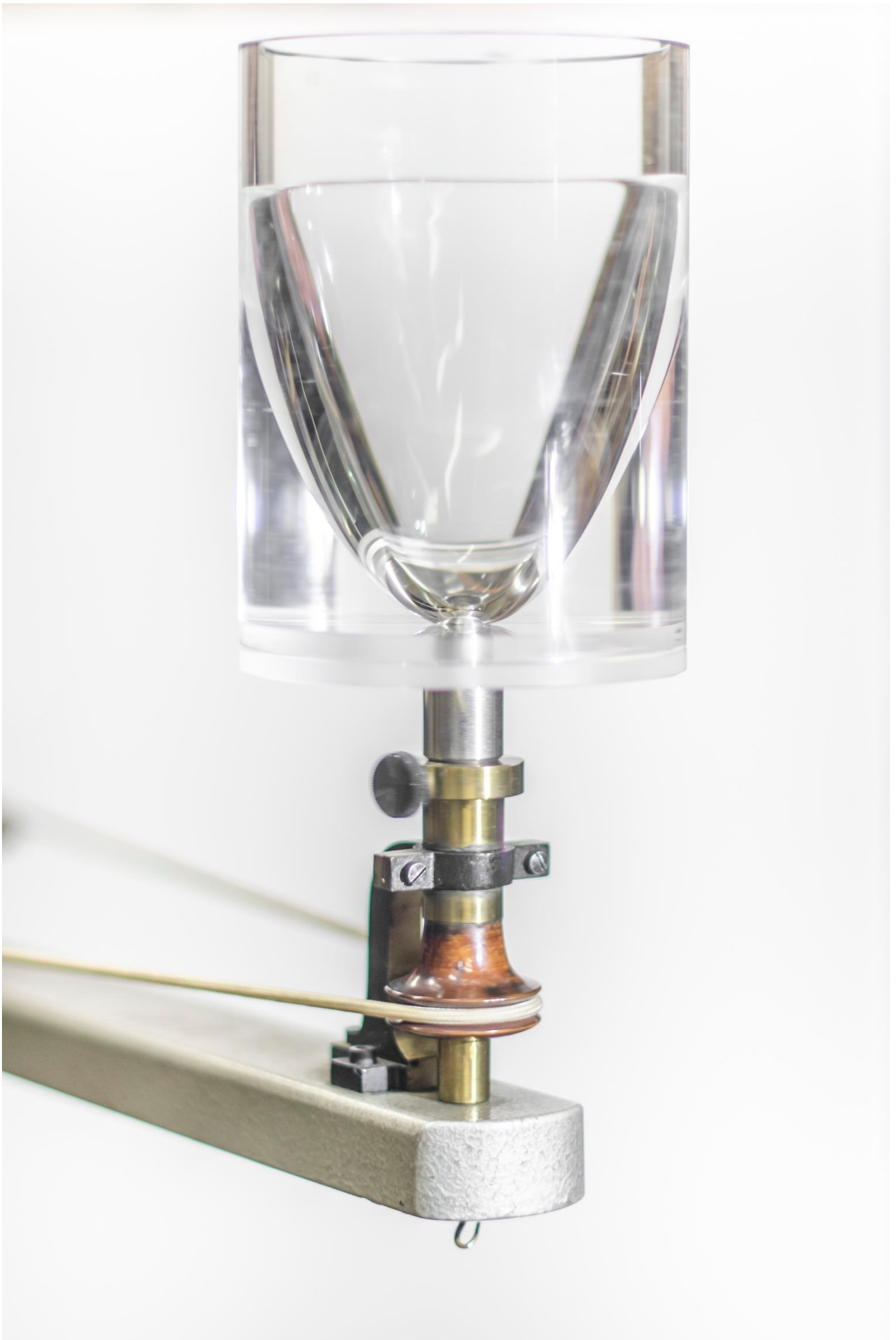
Abbildung 138: Glasgefäß mit Achse auf Zentrifugalapparat – es kommt zur Parabelbildung Apparatur: TU-Graz
