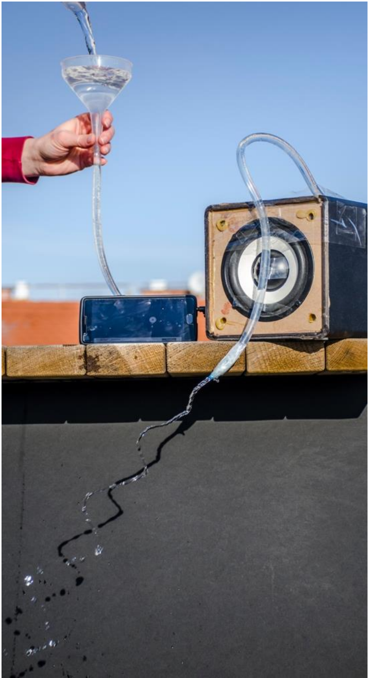
Abbildung 301: Aufbau bestehend aus Trichter, Schlauch, Frequenzgenerator und Bassbox
