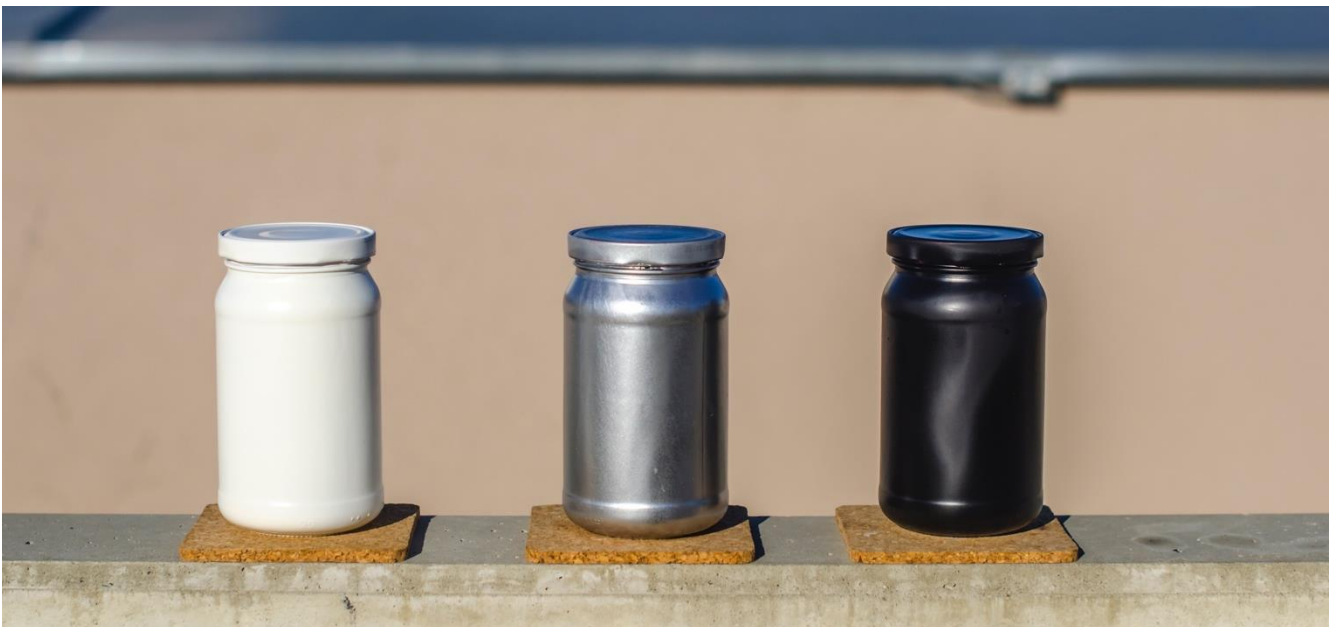
Abbildung 170: Im Sonnenlicht werden die drei Gläser mit geschlossenem Deckel für einige Zeit stehen gelassen
