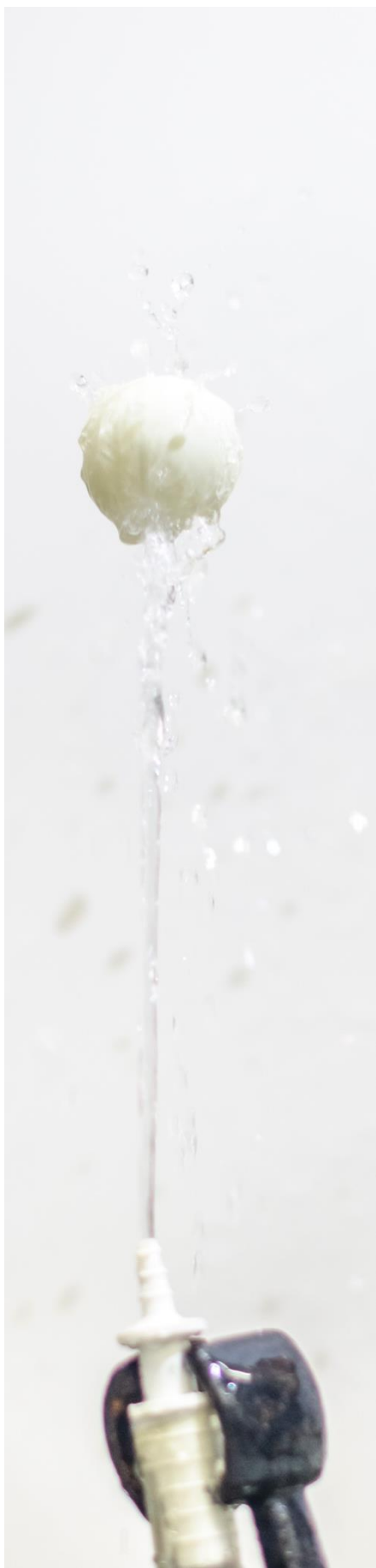
Abbildung 120: Schwebender Tischtennisball auf Wasserstrahl
