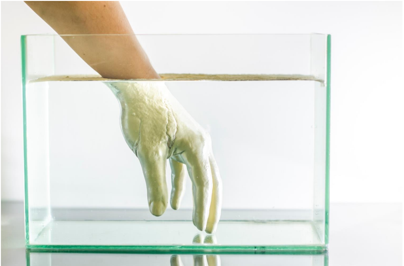
Abbildung 24: Trockene Hand im Wasser durch Bärlappsporen
