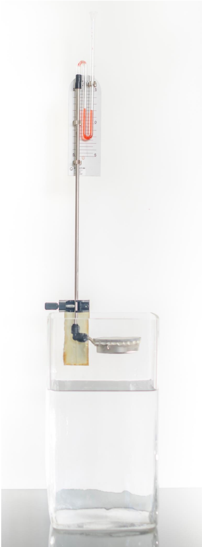
Abbildung 68: Druckdose mit U-Rohr Manometer über dem Wasser
