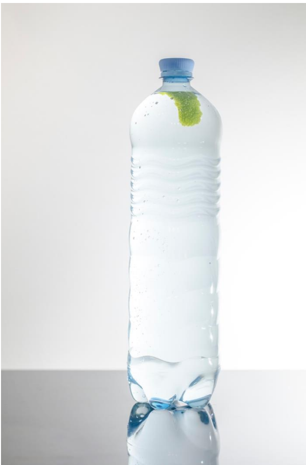
Abbildung 96: Limette als Kartesischer Taucher schwimmt
