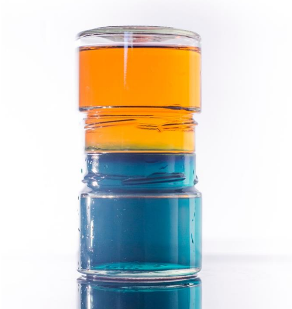
Abbildung 157: Oranges, warmes Wasser oben; kaltes, blaues Wasser unten – es findet keine Vermischung der Flüssigkeiten statt
