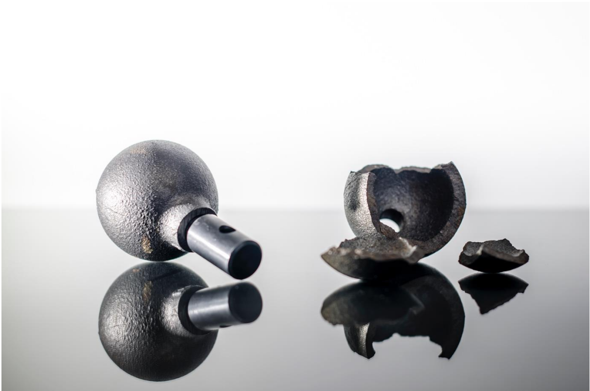
Abbildung 152: Gusseisenhohlkugel – Zerbrochene Kugel durch Kältemischung
