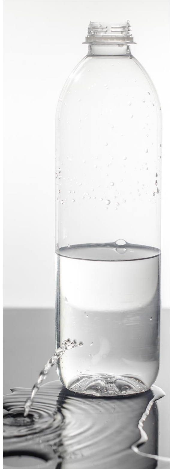
Abbildung 23: Aufgrund der Oberflächenspannung verknoten sich die Wasserstrahlen miteinander
