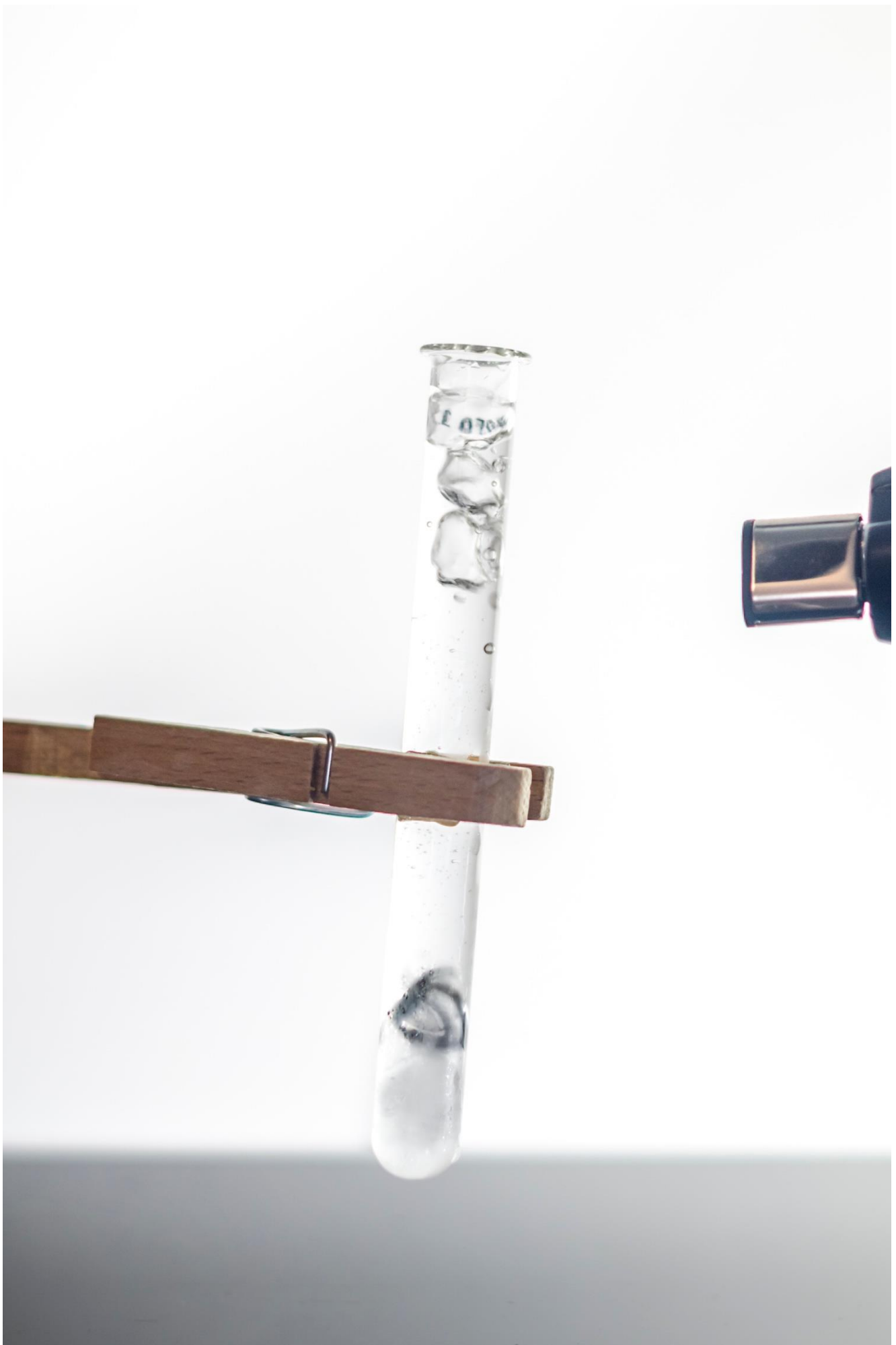
Abbildung 164: Eis, flüssiges und kochendes Wasser in einem Reagenzglas – geringe Wärmeleitfähigkeit von Wasser
