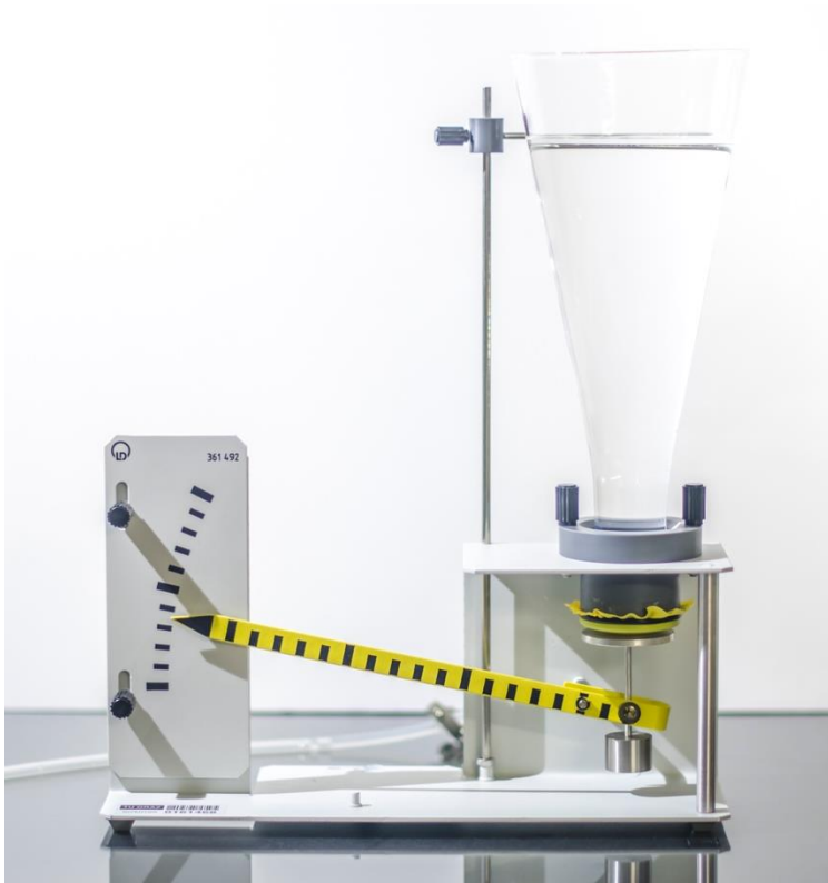
Abbildung 63: Bodendruck in einem Trichterrohr Apparatur: TU-Graz
