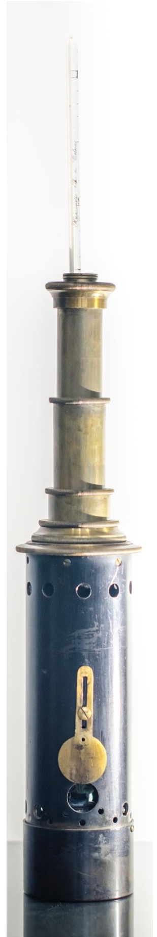
Abbildung 201: Hypsometer zur Höhenbestimmung Apparatur: TU-Graz
