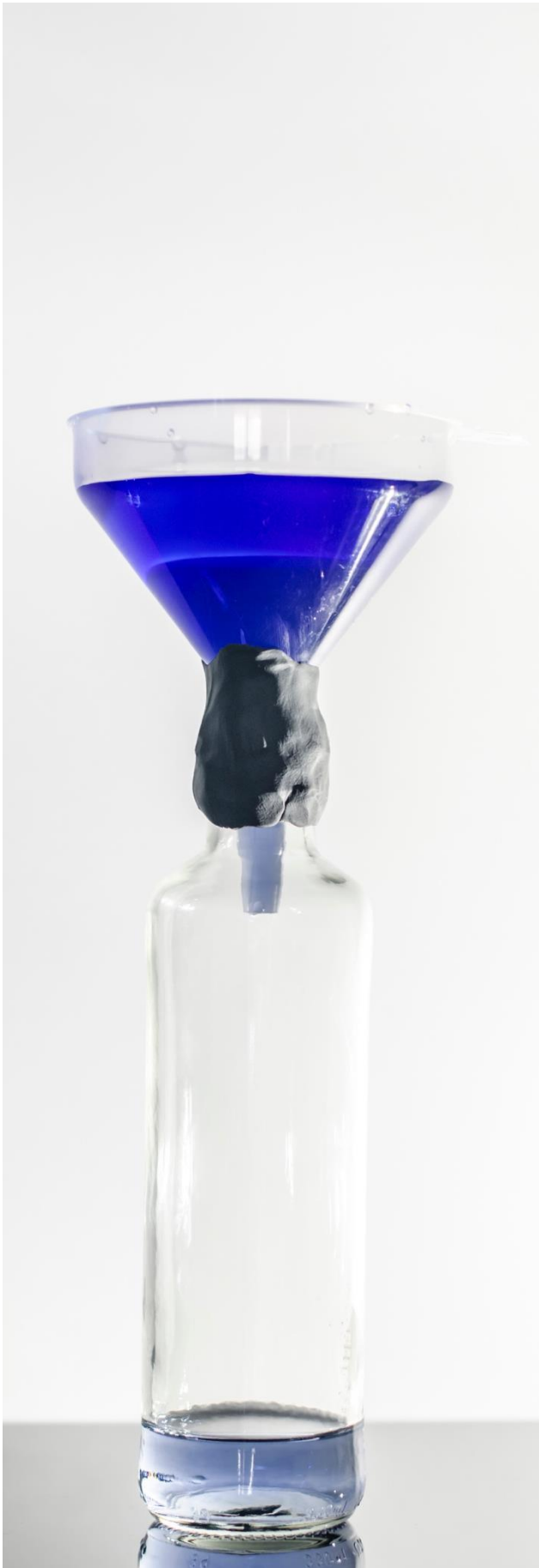
Abbildung 55: Scheinbar verstopfter Trichter – kein Wasserfluss
