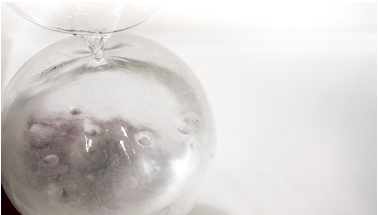
Abbildung 195: Durch das Übergießen mit kaltem Wasser, fängt das Innere aufgrund des Unterdrucks erneut an zu kochen Apparatur: TU-Graz
