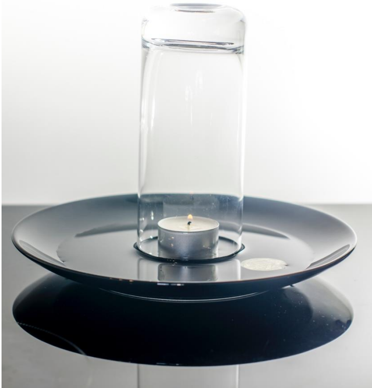
Abbildung 187: Glas über brennender Kerze – Münze liegt im Wasser
