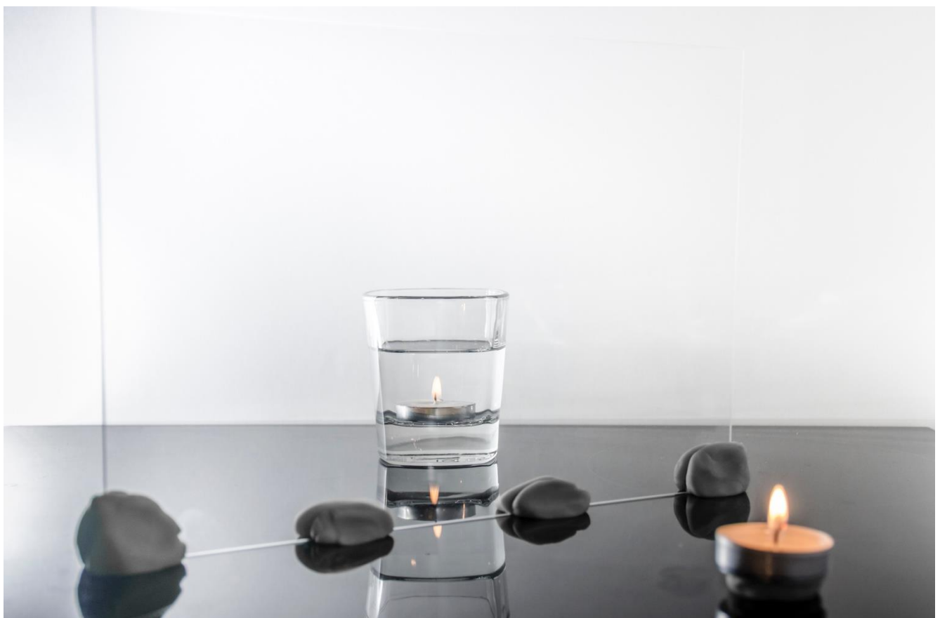
Abbildung 243: Versuchsaufbau zur Entstehung eines virtuellen Bildes
