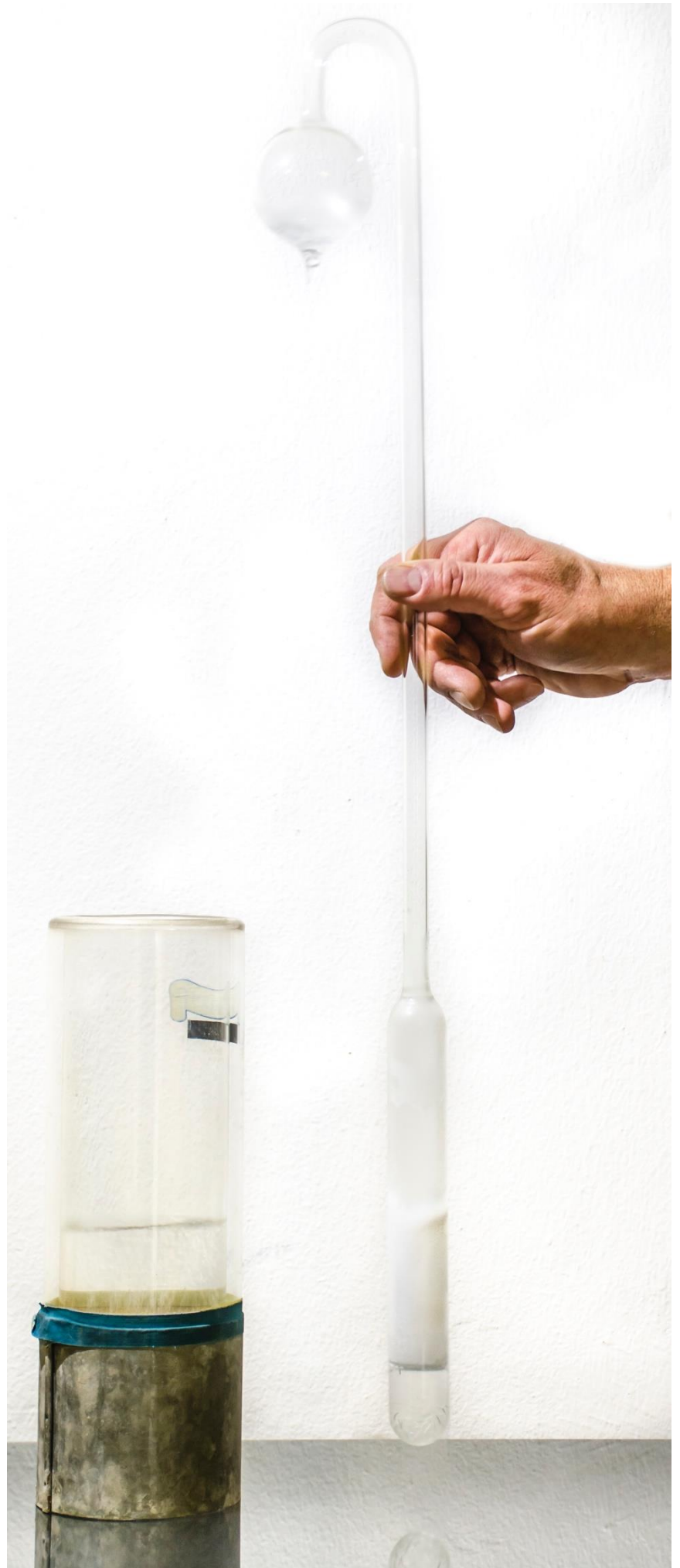
Abbildung 199: Wasser gefriert im oberen Teil des Kryophors ohne direkten Kontakt zu kaltem Flüssigstickstoff
