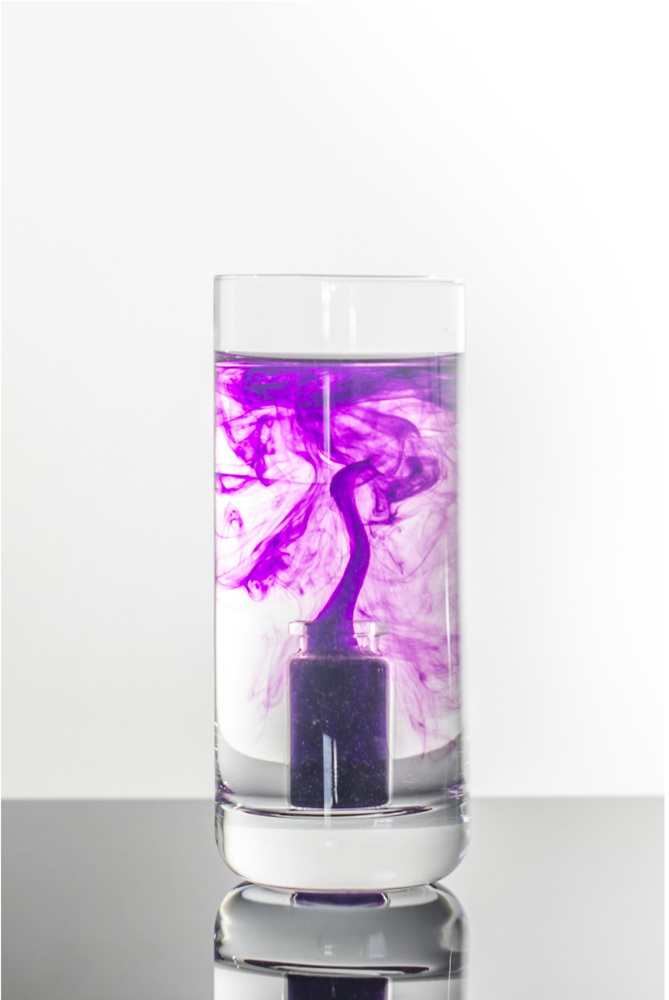
Abbildung 156: Der Farbvulkan – Ausdehnung von warmem Wasser in umliegendes, kälteres
