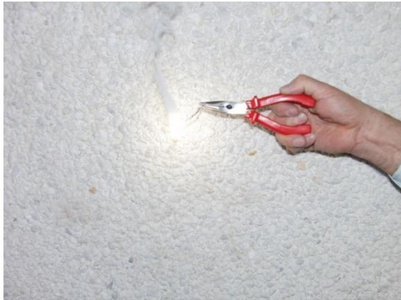
Abb. 110: Brennender Magnesiumspan
