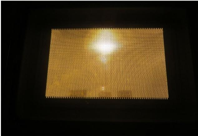
Abb. 63: Plasmaball erzeugt durch Mikrowellen
