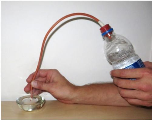
Abb. 118: Kerze mit Mineralwasser löschen
