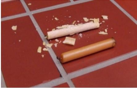
**Abb. 40: Gefrorene spröde Kerze im Vergleich mit herkömmlicher Kerze**
