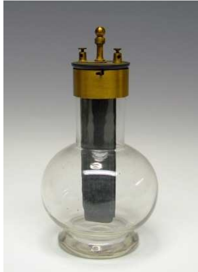
Abbildung 2: Chromsäureelement © cristie.com ( http://www.crtsite.com/page8.html )
