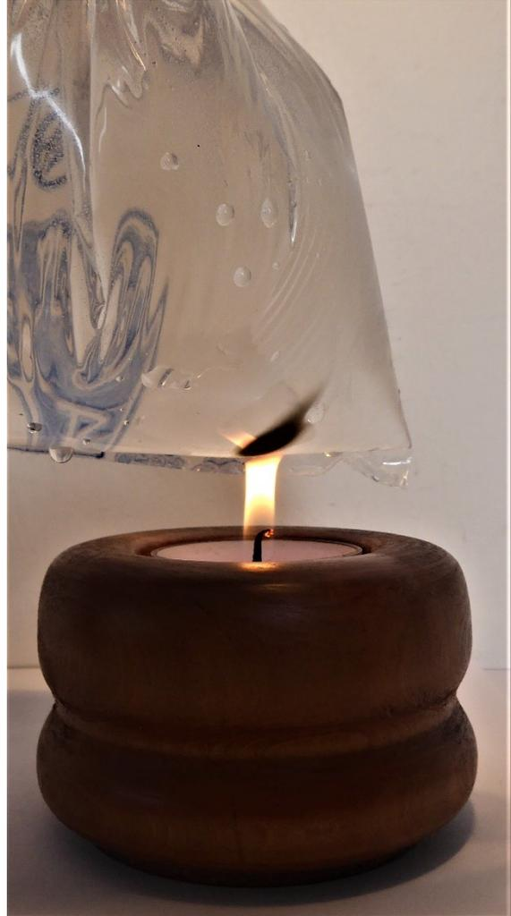
*Abbildung 82: Mit Wasser gefüllter Gefrierbeutel hält der Flamme stand*
