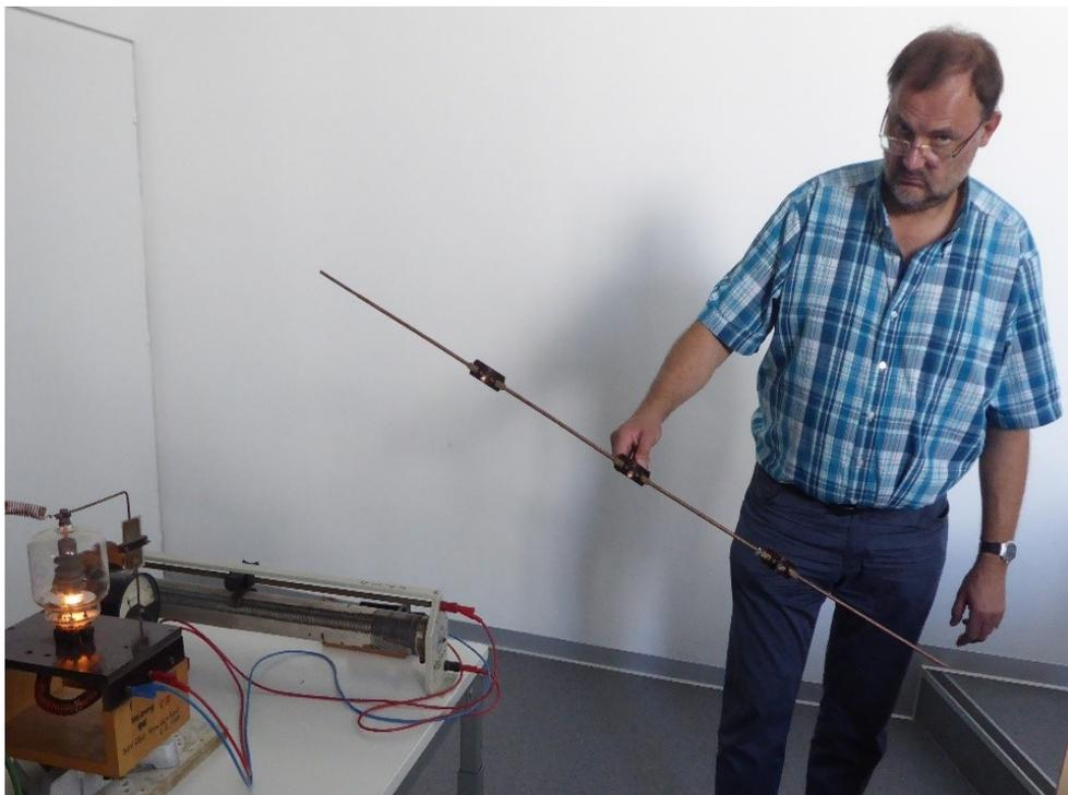
Abbildung 98: Große Antenne leuchtet nicht in Position senkrecht zur Polarisationsachse
