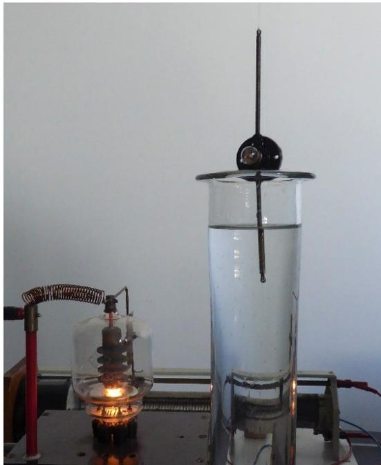
*Abbildung 100: Kleine Antenne leuchtet nicht außerhalb vom destillierten Wasser*
