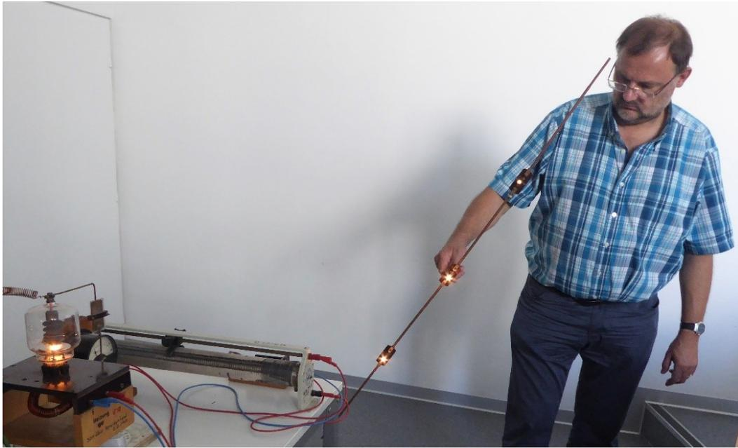
*Abbildung 99: Große Antenne leuchtet in Position parallel zur Polarisationsachse*
