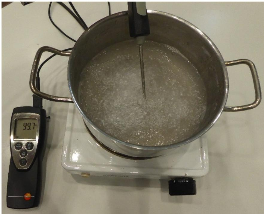
Abbildung 54: Siedepunktserhöhung durch Zugabe von NaCl auf 99,7 °C
