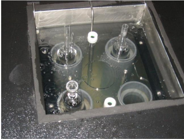
Abbildung 45: Tripelpunktzelle im Kältebad;
