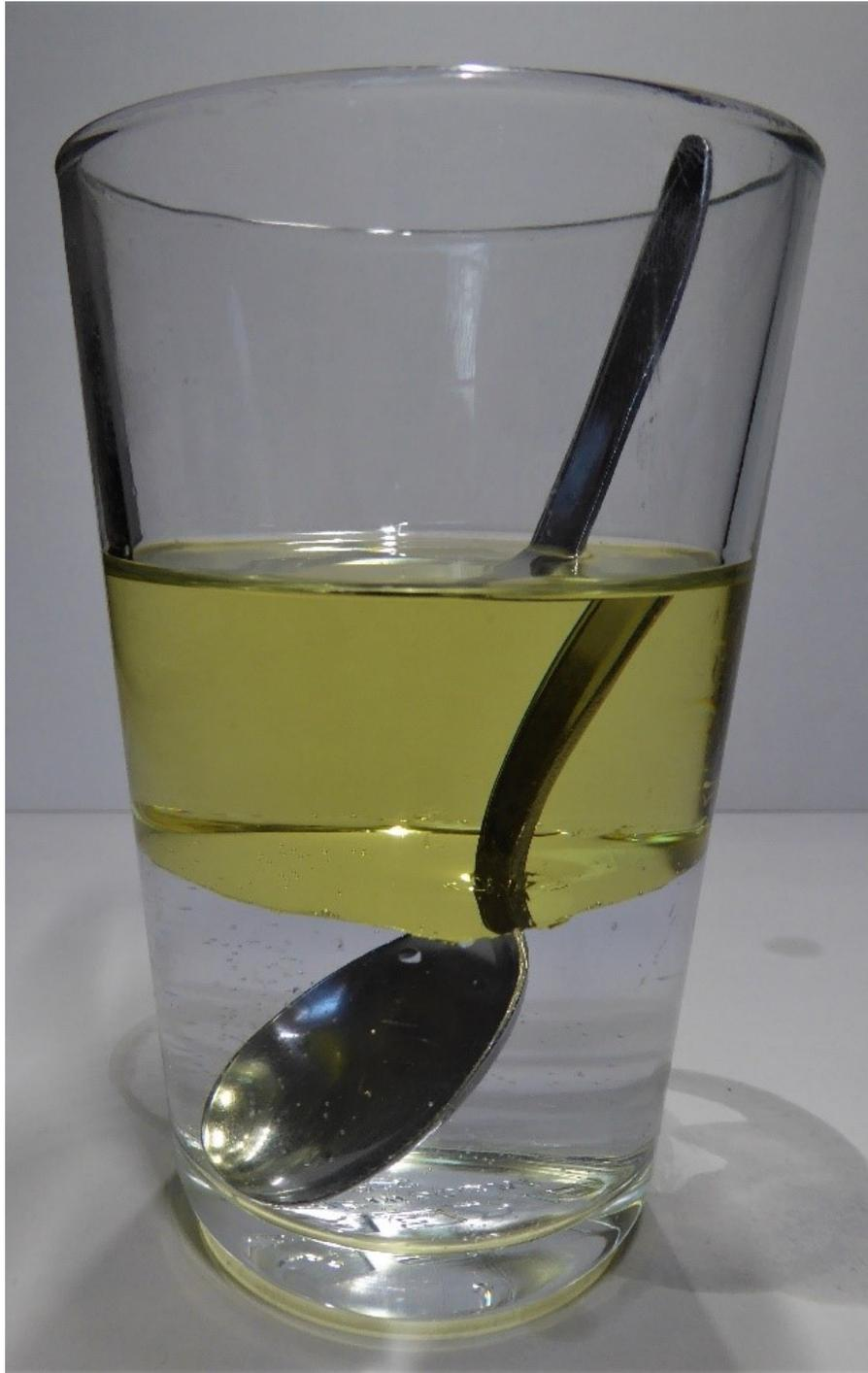
*Abbildung 86: Lichtbrechung im Glas an den Grenzschichten*
