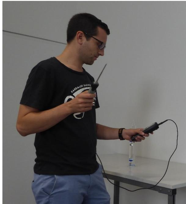
Abbildung 60: Umherwirbeln des Messfühlers
