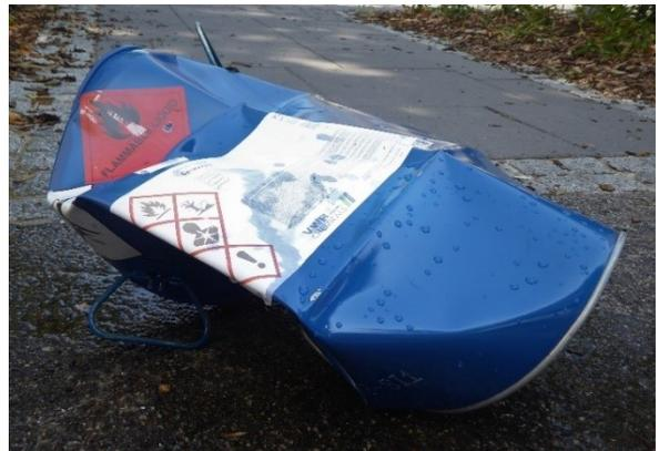
Abbildung 58: Implodiertes Fass
