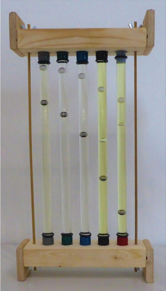
Abbildung 78: Kugeln sinken im Viskosimeter unterschiedlich schnell
