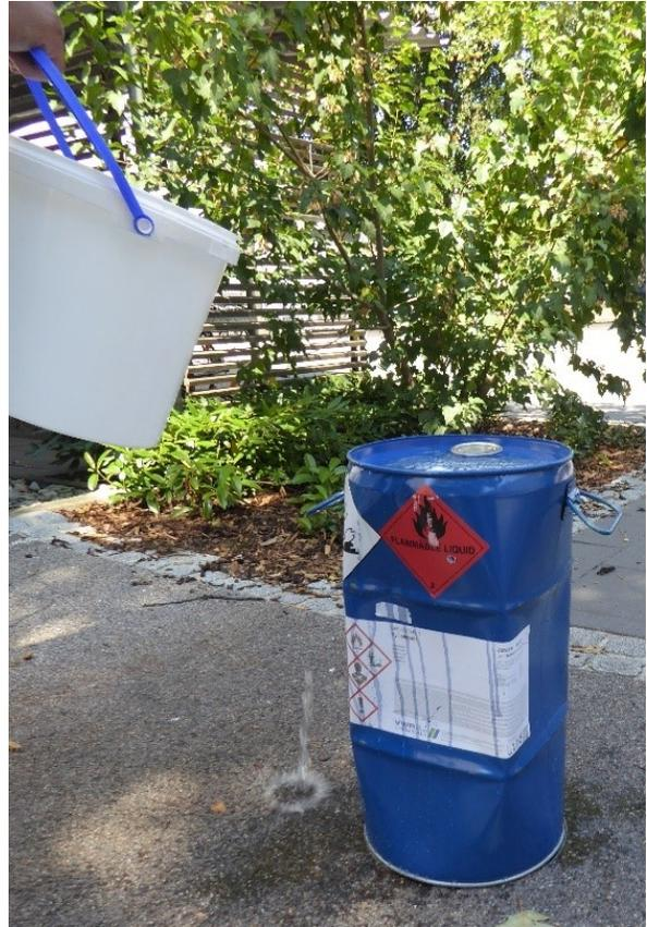
Abbildung 57: Fass wird mit kaltem Wasser übergossen – der Druck sinkt
