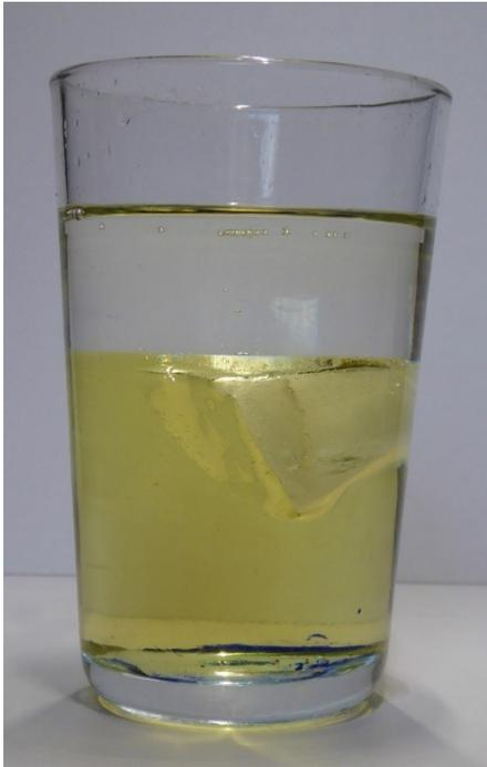
*Abbildung 64: Eiswürfel schwebt an der Grenzschicht von Baby-Öl und Pflanzenöl*
