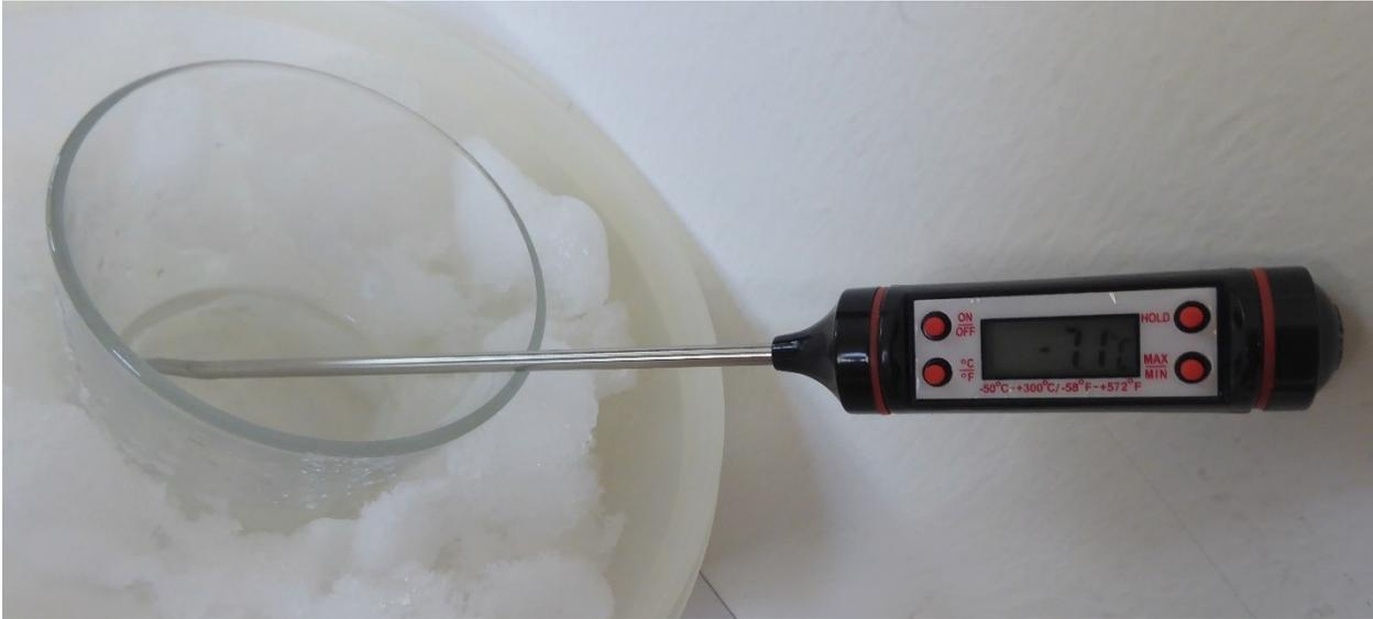
Abbildung 51: Flüssiges destilliertes Wasser bei -7,1 °C
