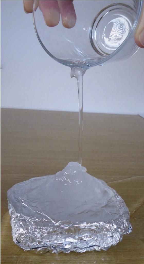
Abbildung 52: Unterkühltes Wasser gefriert beim Auftreffen auf die kalte Oberfläche.
