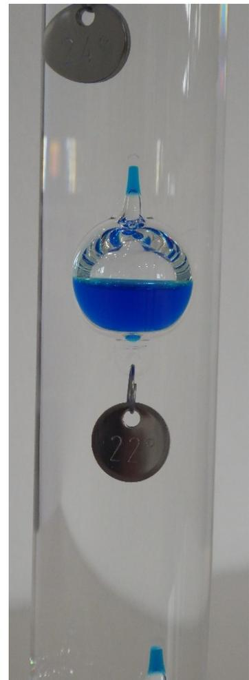
*Abbildung 69: Der Schwimmer schwebt im Galileo-Thermometer; die Raumtemperatur beträgt etwa 22 °C*
