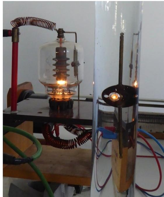
*Abbildung 101: Kleine Antenne leuchtet im destillierten Wasser*
