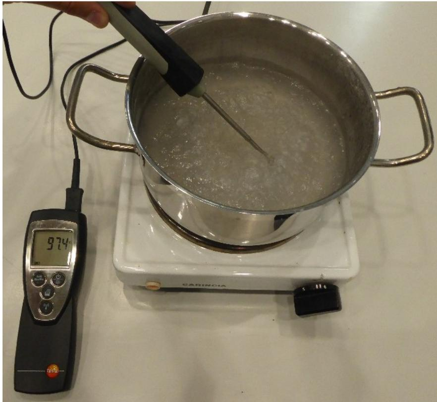
Abbildung 53: Wasser siedet ohne Zugabe von NaCl bei 97,4 °C
