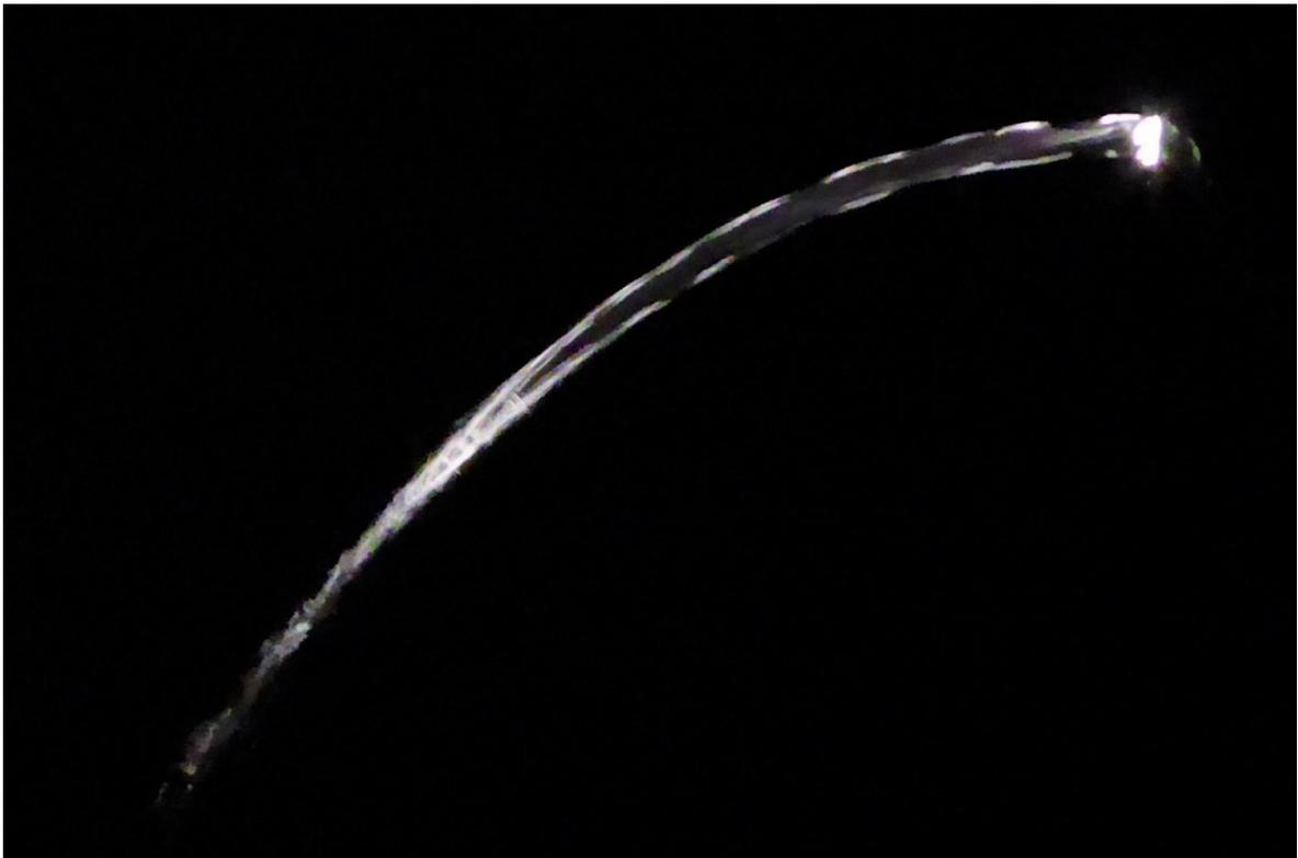
Abbildung 88: Lichtleitung im Wasserstrahl – Totalreflexion ist an den hellen Grenzflächen des Wasserstrahls erkennbar
