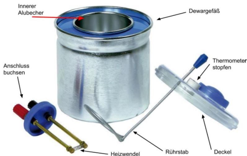
Abbildung 80: Kalorimeter – Apparatur des Lehrmittelherstellers Contanex (Contanex, 2019)
