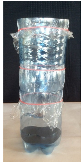
Abb. 49: 2 räumlich durch PE-Folie getrennte Gasvolumina aus einer Mineralwasserflasche (eigene Aufnahme)
