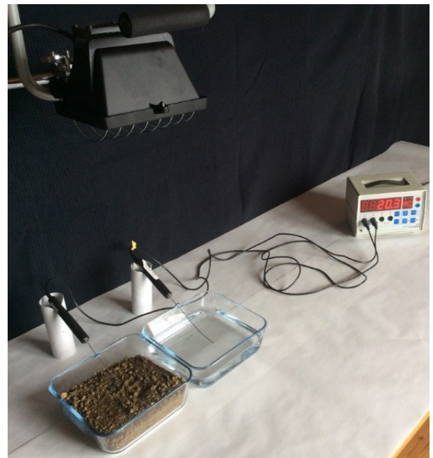
Abb. 24: Versuchsaufbau: spezifische Wärmekapazität Erde vs. Wasser (eigene Aufnahme)
