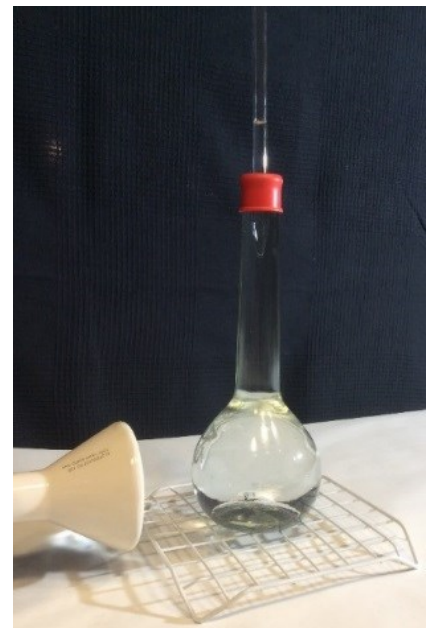
Abb. 55: Versuchsaufbau zur Demonstration der thermischen Ausdehnung von Wasser (eigene Aufnahme)
