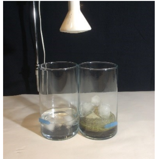
Abb. 56: Versuchsanordnung zum Schmelzvorgang von Packeis und Schelfeis (eigene Aufnahme)
