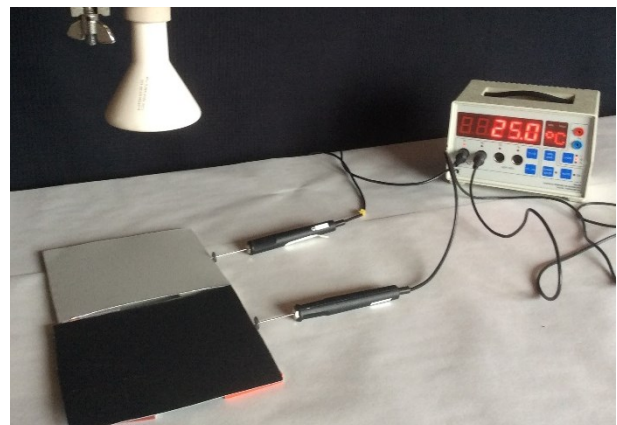
Abb. 54: Eine Variante der Versuchsanordnung zur Absorption der remittierten Wärmestrahlung an der Erdoberfläche (eigene Aufnahme)
