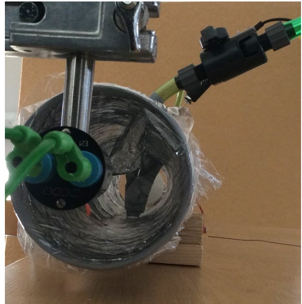
Abb. 41: Detailaufnahme des Absorberrohrs und der Thermosäule im Vordergrund (eigene Aufnahme)
