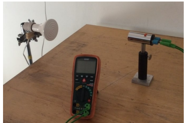
Abb. 30: Emission von Infrarotstrahlung eines Keramikstrahlers (eigene Aufnahme)
