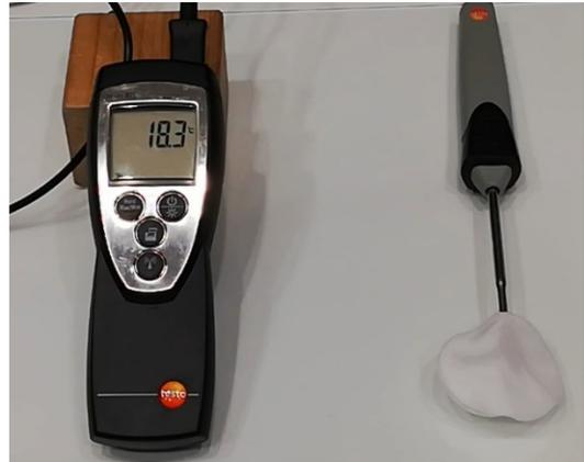
Abbildung 47: Temperaturmessung eines mit Spiritus beträufelten Wattepads; eigenes Bild; Apparatur: TU – Graz
