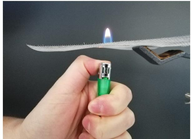
Abbildung 25: Unterbrechung einer Flamme durch Wärmeleitung eines Drahtgitters; eigenes Bild; Apparatur: TU - Graz
