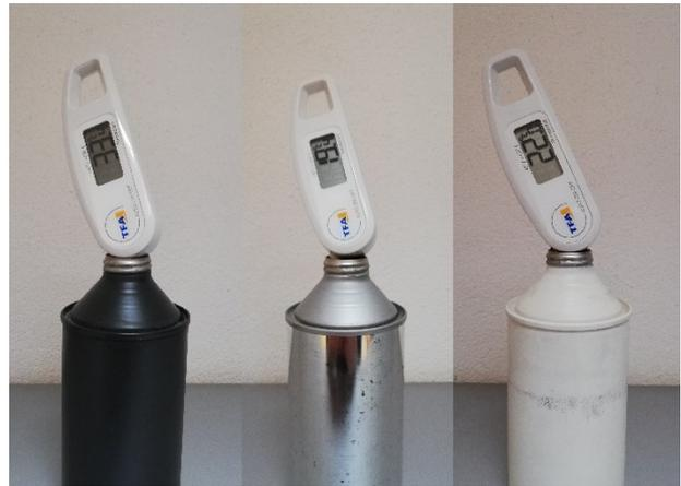
Abbildung 33: Temperaturmessung von Wasser in Behältern mit unterschiedlichen Oberflächen nach 15-minütiger Bestrahlung durch eine Wärmelampe; eigenes Bild; Apparatur: TU - Graz
