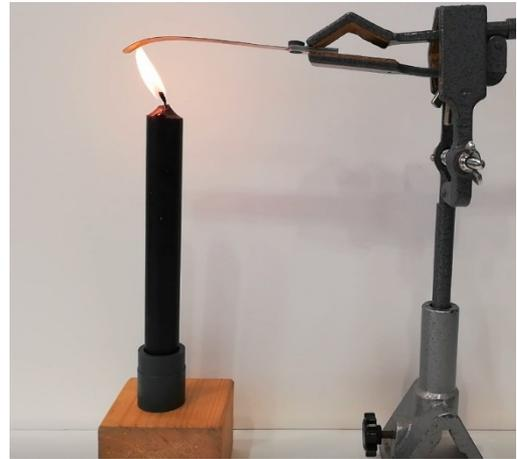
*Abbildung 2: Bimetallstreifen unter Wärmezufuhr; eigenes Bild; Apparatur: TU - Graz*
