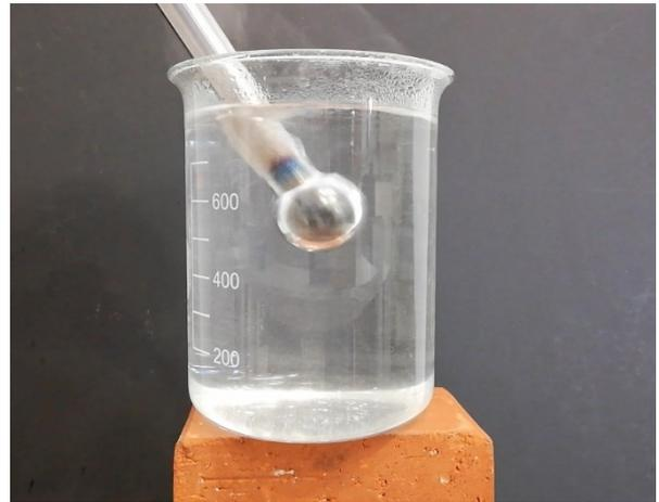
Abbildung 52: Bildung einer Wasserdampfschicht um eine erhitzte Stahlkugel beim Eintauchen in Wasser; eigenes Bild
