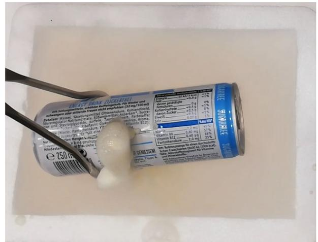
Abbildung 42: Aufplatzen einer Getränkedose durch Ausdehnung der Flüssigkeit beim Gefrieren; eigenes Bild
