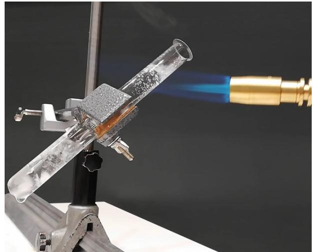
Abbildung 28: Eis, Wasser und Wasserdampf zeitgleich in einem Reagenzglas; eigenes Bild; Apparatur: TU - Graz
