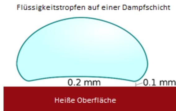
Abbildung 51: Darstellung des Leidenfrost-Effekts;
