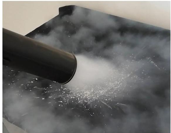
Abbildung 45: Erzeugung von festem Kohlenstoffdioxid durch adiabatische Expansion; eigenes Bild; Apparatur: TU - Graz
