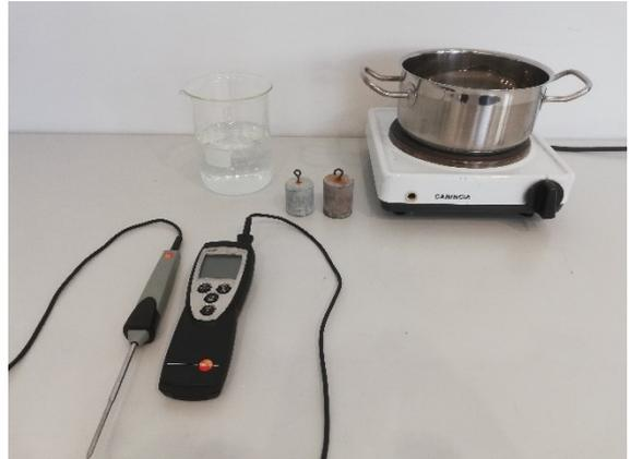
Abbildung 9: Geräte für die Bestimmung von Wärmekapazitäten diverser Probekörper; eigenes Bild; Apparatur: TU - Graz
