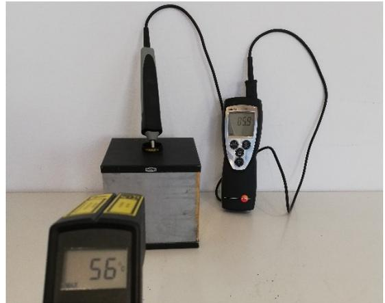
Abbildung 32: Messung der Wärmestrahlung einer Seite des Leslie-Würfels; eigenes Bild; Apparatur: TU - Graz
