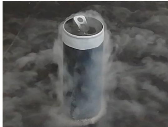
*Abbildung 43: Resublimation von Wasserdampf an einer mit flüssigem Stickstoff gefüllten Aluminiumdose; eigenes Bild*
