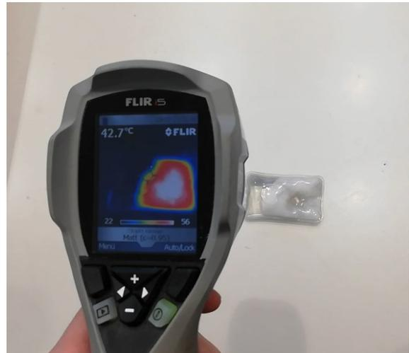
Abbildung 49: Geknicktes Wärmepad unter einer Wärmebildkamera; eigenes Bild; Apparatur: TU – Graz
