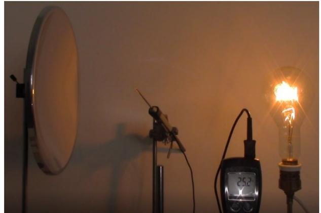
Abbildung 31: Anordnung zur Fokussierung der Wärmestrahlung einer Glühlampe auf ein Thermometer; eigenes Bild; Apparatur: TU - Graz
