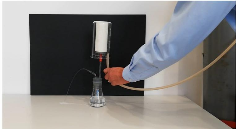
Abbildung 58: Druckerhöhung durch Diffusion von Helium; eigenes Bild; Apparatur: TU – Graz
