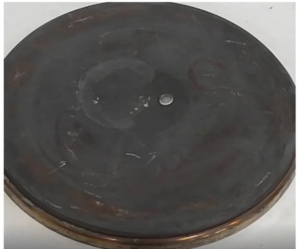
Abbildung 53: Wassertropfen auf einer heißen Herdplatte; eigenes Bild
