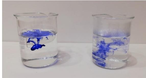
*Abbildung 57: Diffusion von Tinte in mit unterschiedlich warmem Wasser gefüllten Behältern; eigenes Bild*
