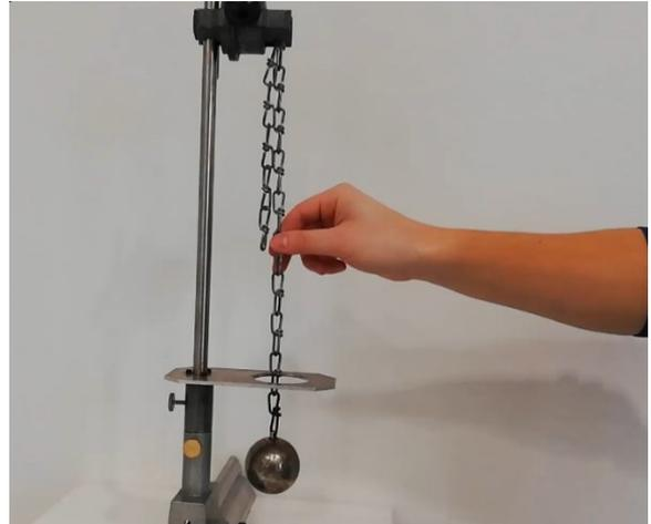
*Abbildung 3: Versuchsaufbau für die Volumsausdehnung einer Eisenkugel unter Wärmezufuhr; eigenes Bild; Apparatur: TU - Graz*
