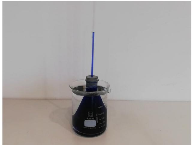
*Abbildung 4: Volumsausdehnung einer Flüssigkeit unter Wärmezufuhr; eigenes Bild; Apparatur: TU - Graz*
